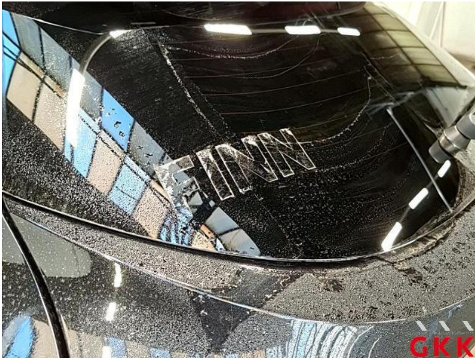
Bild 21 Folierung, Scheibe, Klebreste, entfernen
