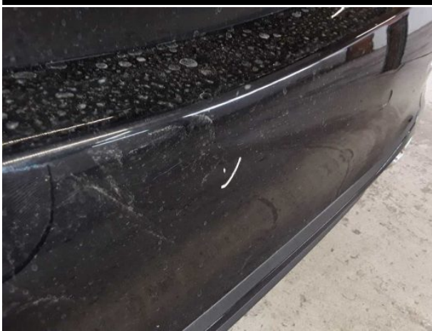
Beschädigung #11: Stossfänger hinten: Stossfänger hinten - verkratzt / verschürft - instandsetzen und lackieren
