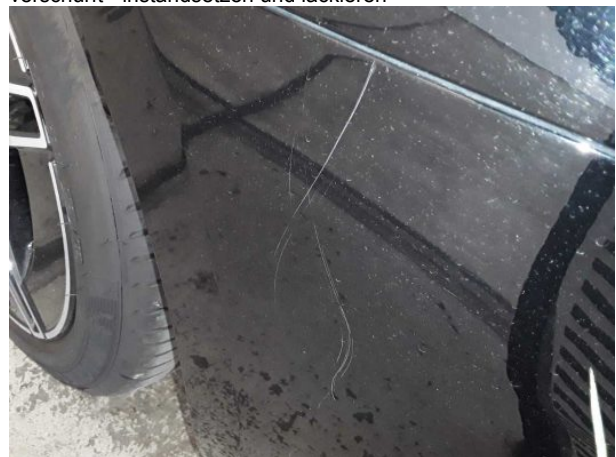
Beschädigung #11: Stossfänger hinten: Stossfänger hinten - verkratzt / verschürft - instandsetzen und lackieren
