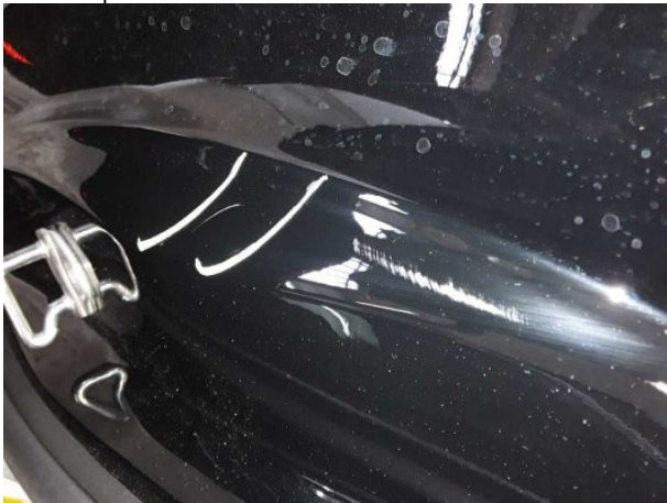
Beschädigung #10: Seitenwand rechts: Einstieg - verkratzt / verschürft - instandsetzen und lackieren
