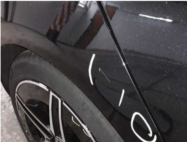
Beschädigung #13: Seitenwand rechts: Seitenwand - Delle / Lackschaden - instandsetzen und lackieren
