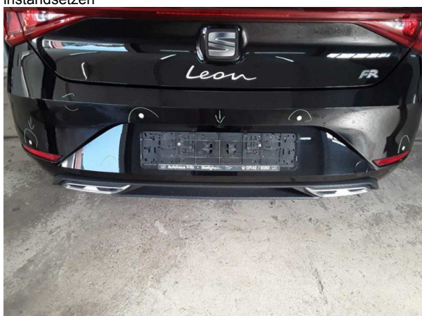
Beschädigung #5: elektronische Systeme: Rückfahrkamera - beschädigt - erneuern
