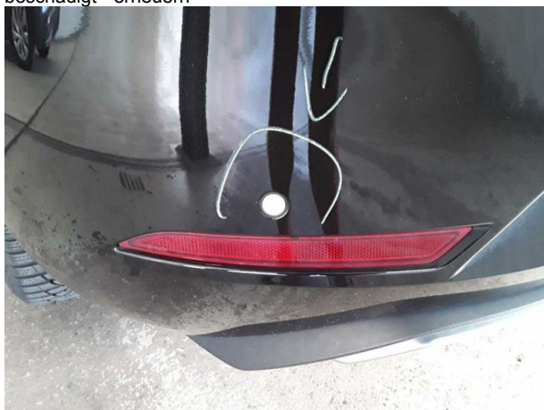
Beschädigung #6: elektronische Systeme: Einparkhilfe (4 Stück falscher Farbton) - abweichend Auslieferungszustand - erneuern
