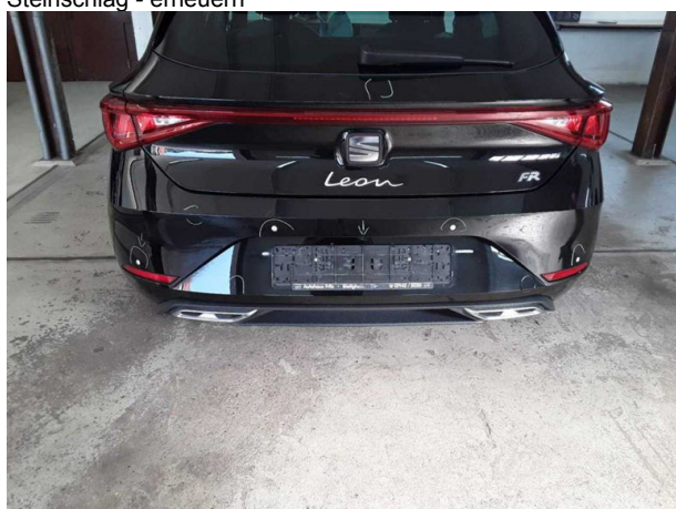
Beschädigung #8: Stossfänger hinten: Stossfänger hinten - verkratzt / verschürft - lackieren
