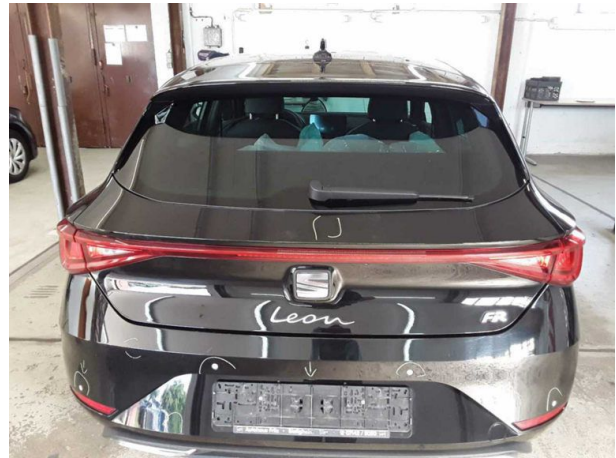
Beschädigung #9: Heckklappe/-tür: Heckklappe - verkratzt / verschürft - lackieren
