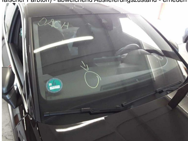
Beschädigung #7: Verglasung: Frontscheibe (Rissbildung) - Steinschlag - erneuern
