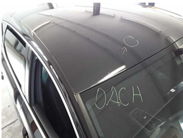
Beschädigung #1: Fahrzeugdach: Dach - Delle(n) - sanft instandsetzen
