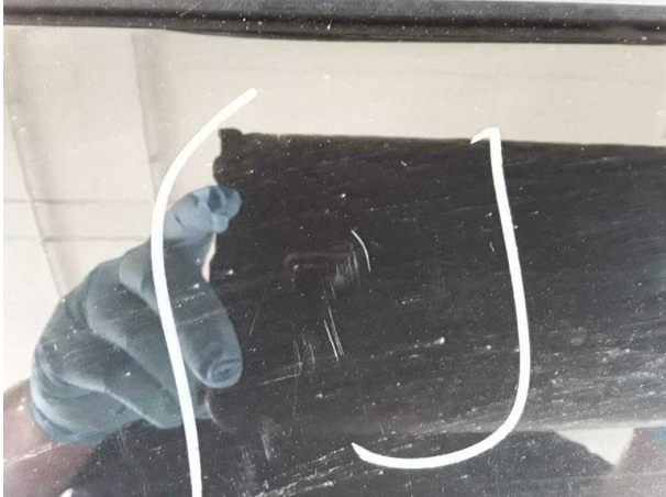
Beschädigung #9: Heckklappe/-tür: Heckklappe - verkratzt / verschürft - lackieren
