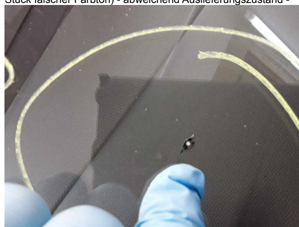
Beschädigung #7: Verglasung: Frontscheibe (Rissbildung) - Steinschlag - erneuern
