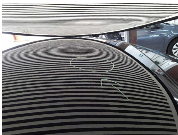
Beschädigung #1: Fahrzeugdach: Dach - Delle(n) - sanft instandsetzen
