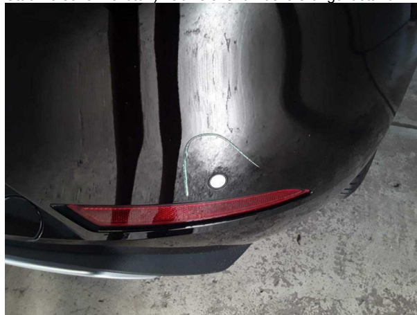
Beschädigung #6: elektronische Systeme: Einparkhilfe (4 Stück falscher Farbton) - abweichend Auslieferungszustand -
