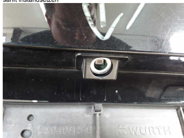
Beschädigung #5: elektronische Systeme: Rückfahrkamera - beschädigt - erneuern
