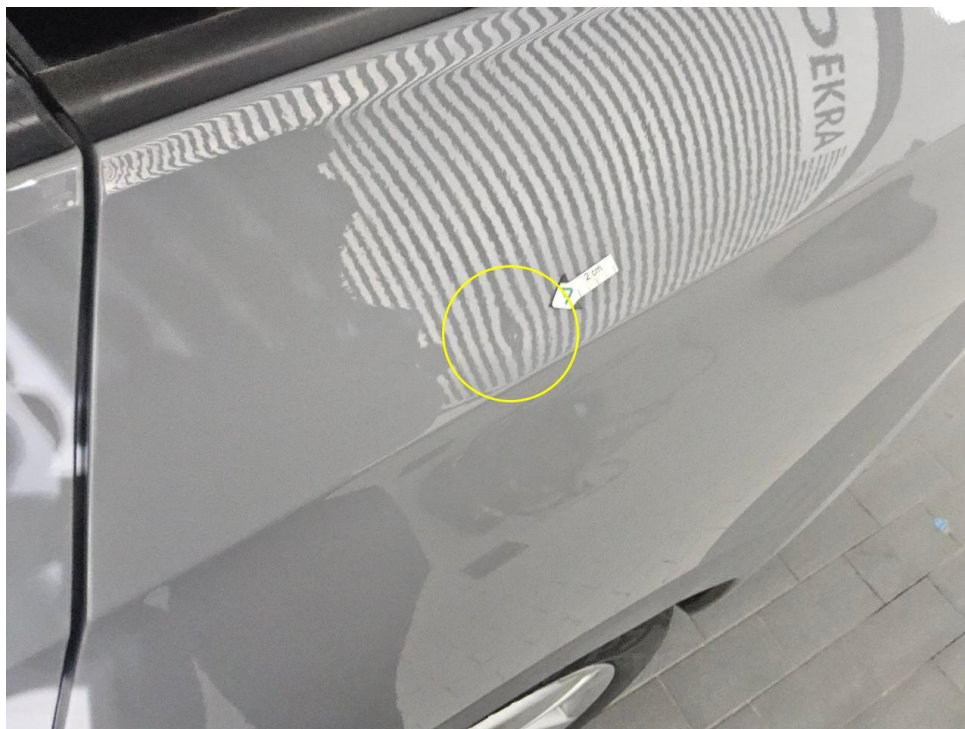
Bild 19 : Seitenteil hinten links, eingedellt
