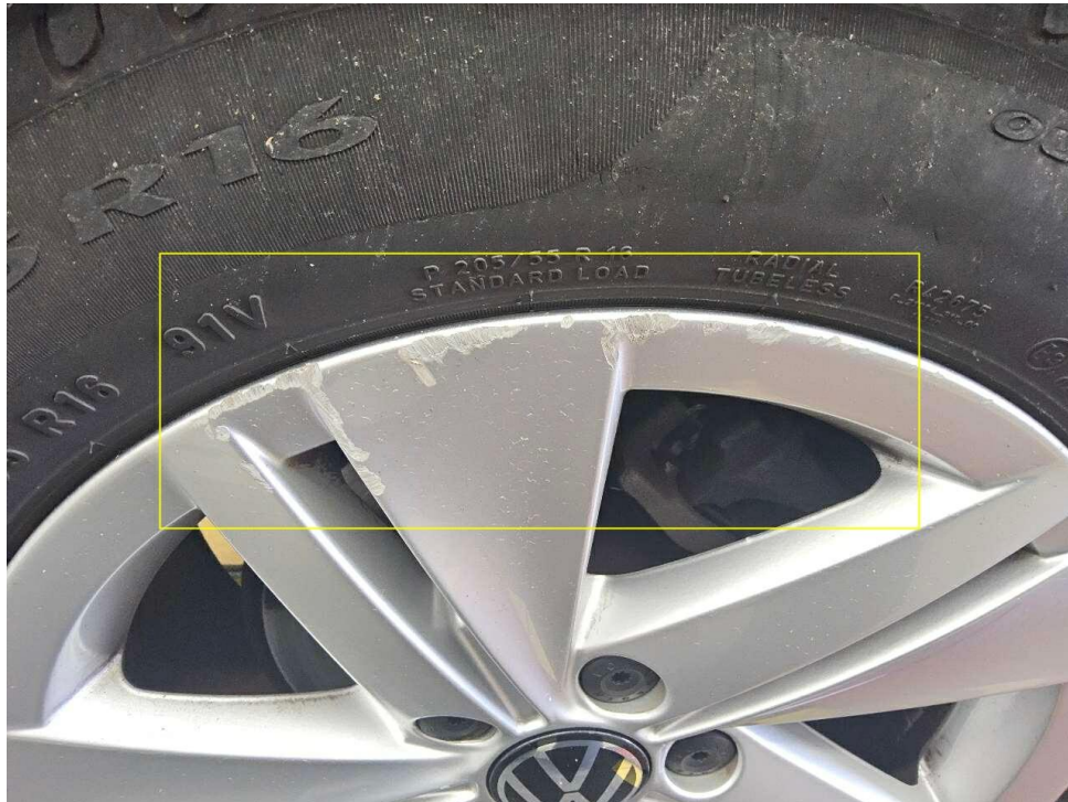
Bild 37 : Felge (Sommer) hinten rechts, zerkratzt
