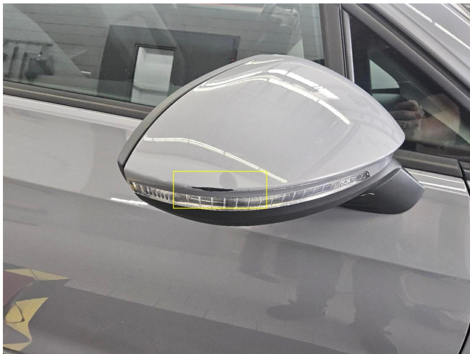
Bild 30 : Außenspiegelverkleidung rechts, zerkratzt
