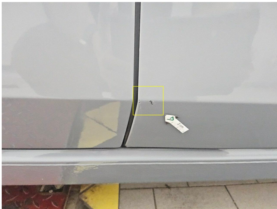
Bild 17 : Tür vorne rechts, zerkratzt
