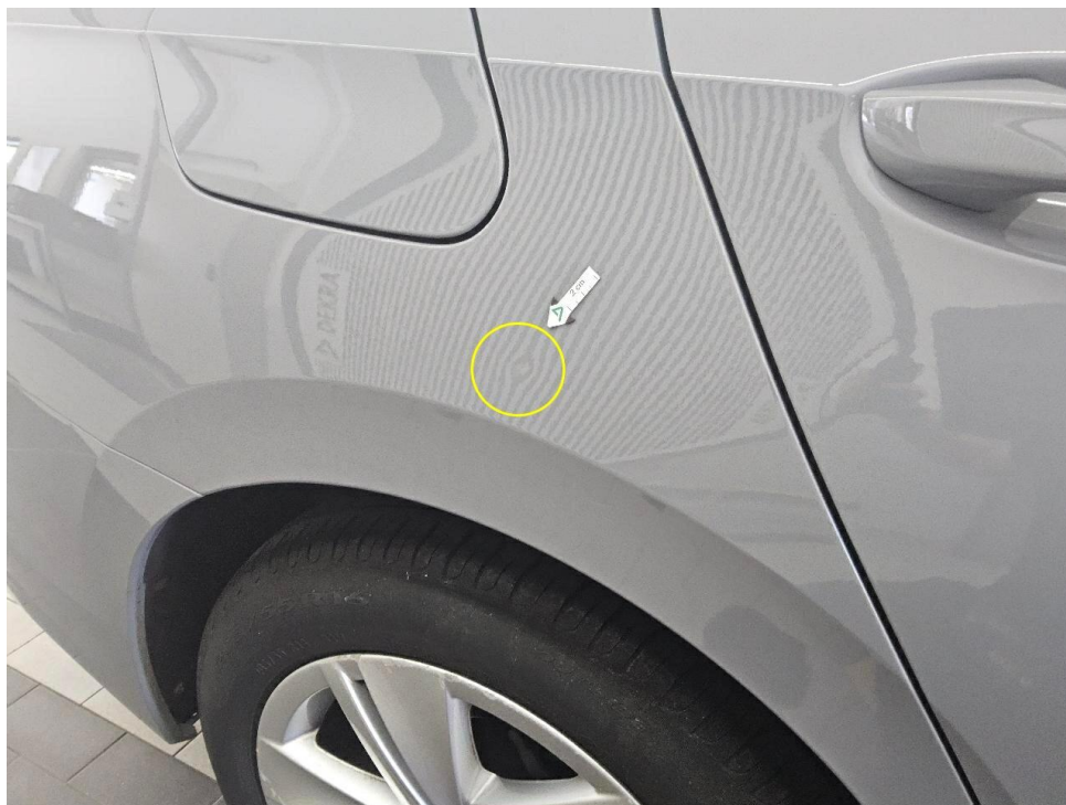
Bild 21 : Seitenteil hinten rechts, eingedellt
