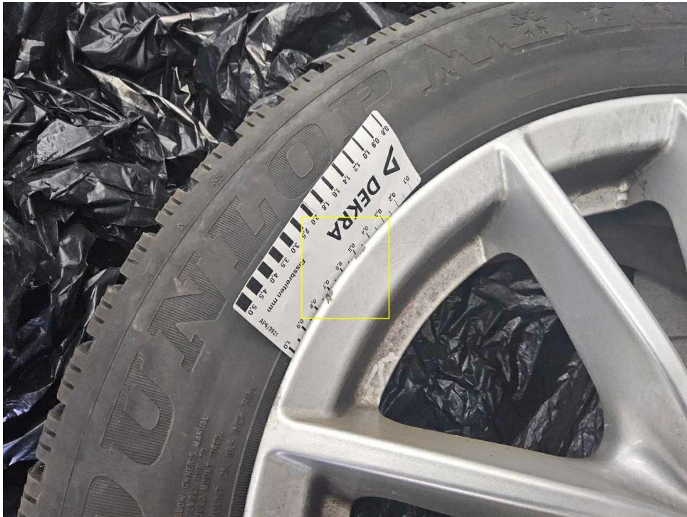
Bild 39 : Felge (Winter) vorne rechts, zerkratzt
