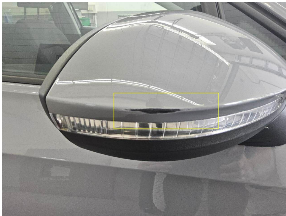
Bild 31 : Außenspiegelverkleidung rechts, zerkratzt
