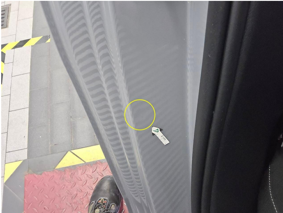
Bild 43 : Tür hinten rechts Einstieg, eingedellt
