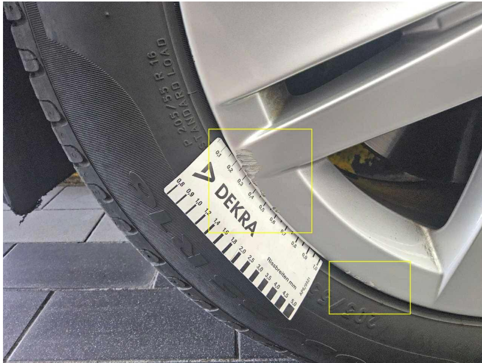
Bild 33 : Felge (Sommer) vorne links, zerkratzt
