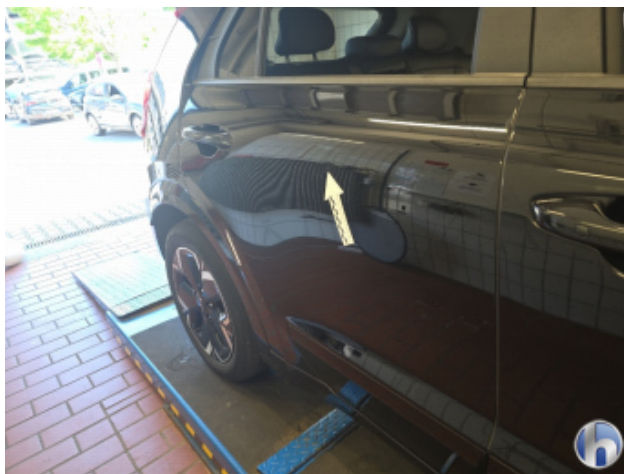
2. Tür Hinten - Rechts Delle Bis 20 Mm Mit Lackschaden - Smart Repair
