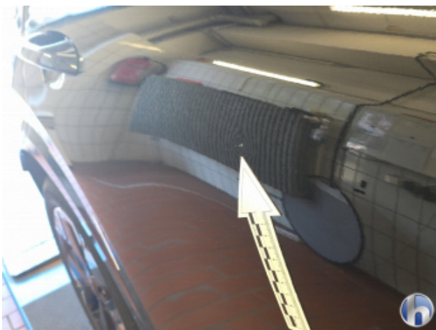
2. Tür Hinten - Rechts Delle Bis 20 Mm Mit Lackschaden - Smart Repair
