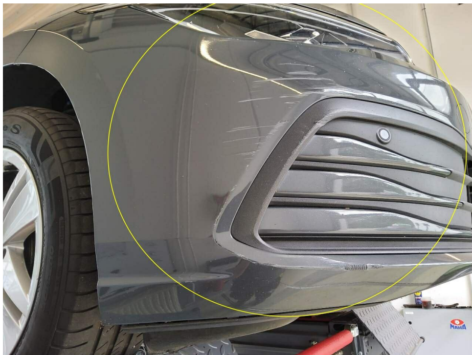
Bild 16 : Stoßfänger vorne verformt und verschrammt.
