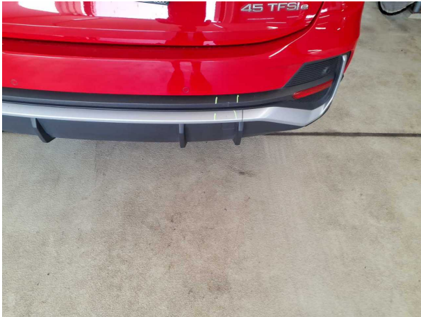
Beschädigung #2: Stossfänger hinten: Spoiler - verformt - erneuern
