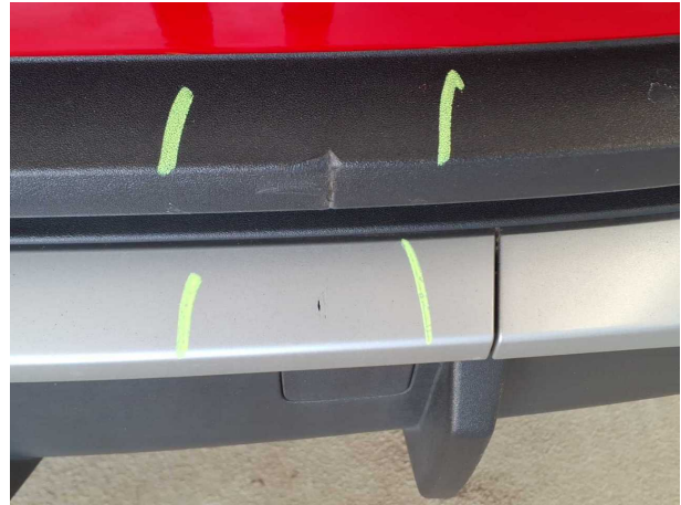
Beschädigung #2: Stossfänger hinten: Spoiler - verformt - erneuern
