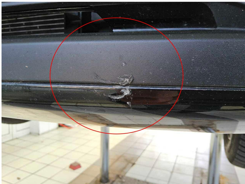
Bild 14 : Frontspoiler, verformt, erneuern
