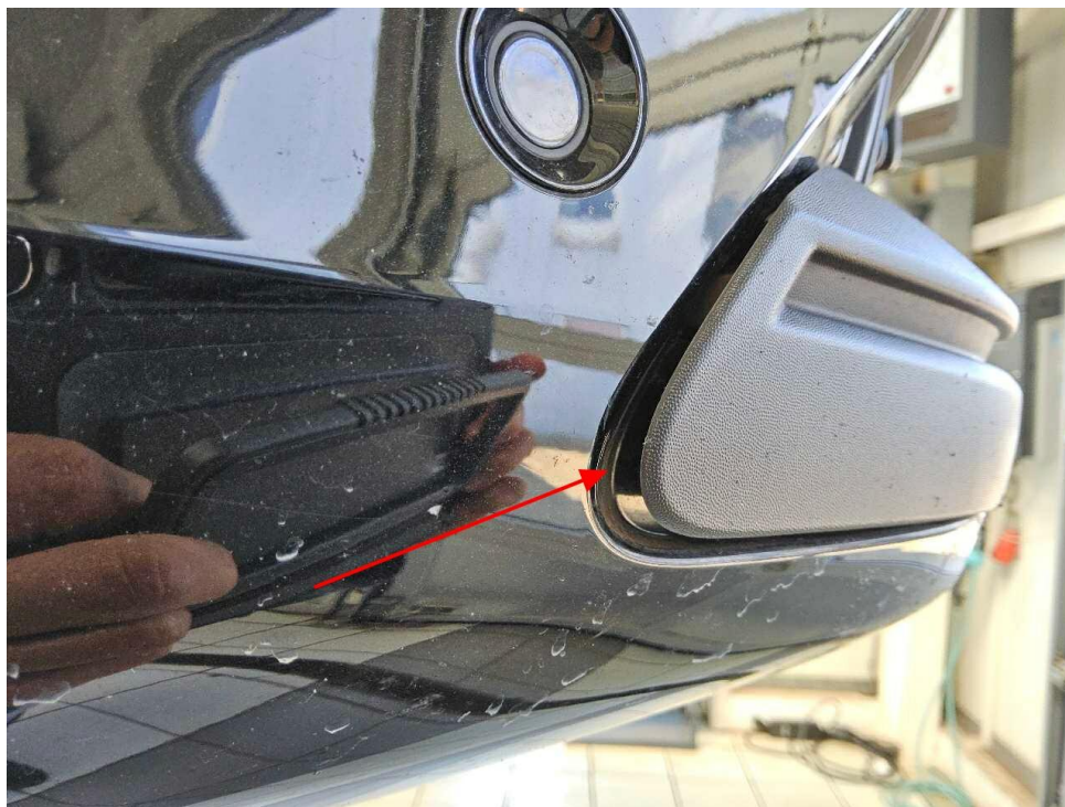
Bild 16 : Frontspoiler, verformt, erneuern
