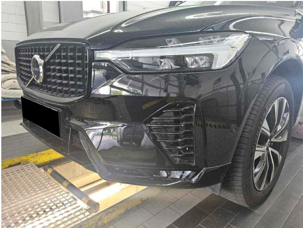
Bild 13 : Stoßfänger vorne, Steinschlag
