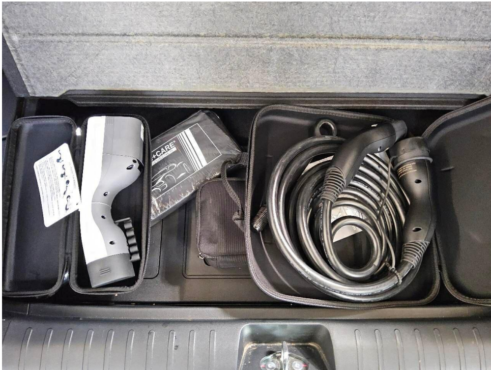
Bild 6 : Ladekabel beim E-Fahrzeug
