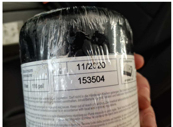
Damage 1: Equipment: Tirefit filler (Nicht Bestandteil der Ausstattung) - Expired - Replace
