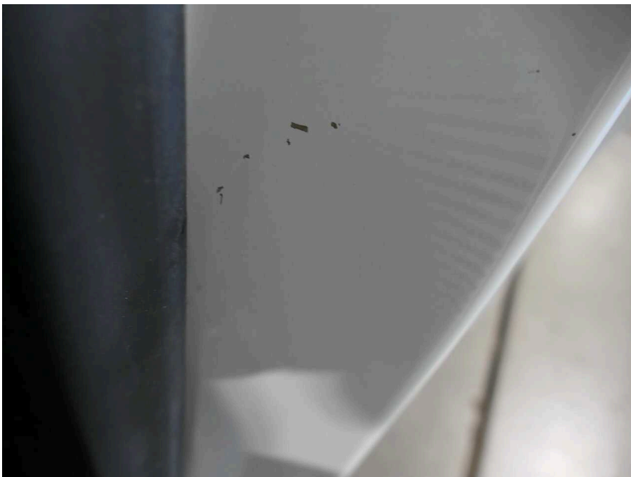
Bild 70 linke Seite Türeinstieg vorne links verkratzt
