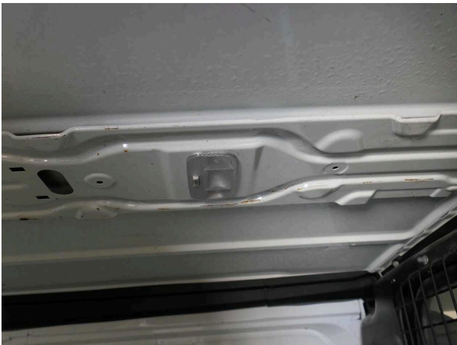
Bild 88 Innenraum Laderaum Decke korrodiert
