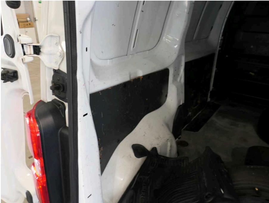
Bild 23 Innenraum Laderaumverkleidung links alle gebrochen
