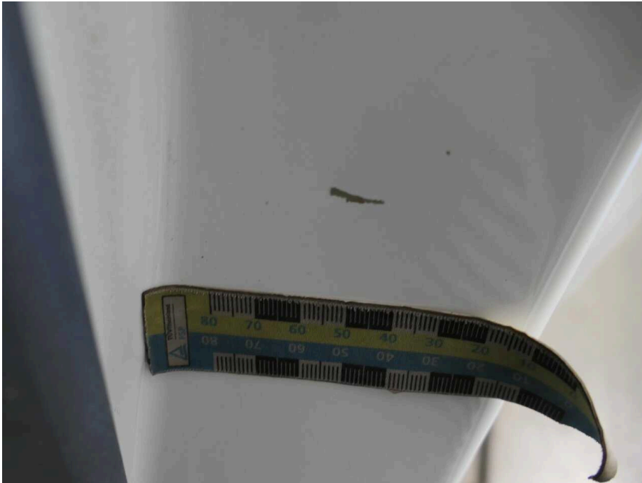
Bild 69 linke Seite Türeinstieg vorne links verkratzt
