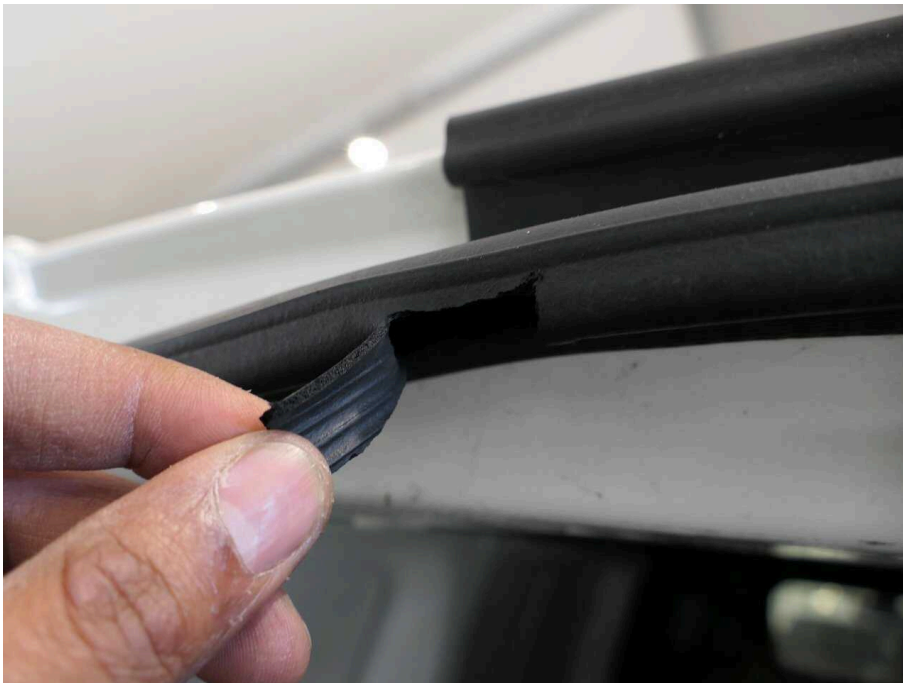
Bild 38 Fahrzeugheck Heckklappendichtung gerissen / eingerissen
