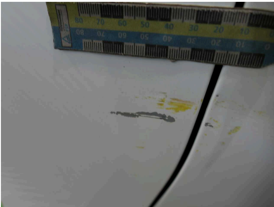
Bild 92 rechte Seite Tür vorne rechts Delle/Kratzer
