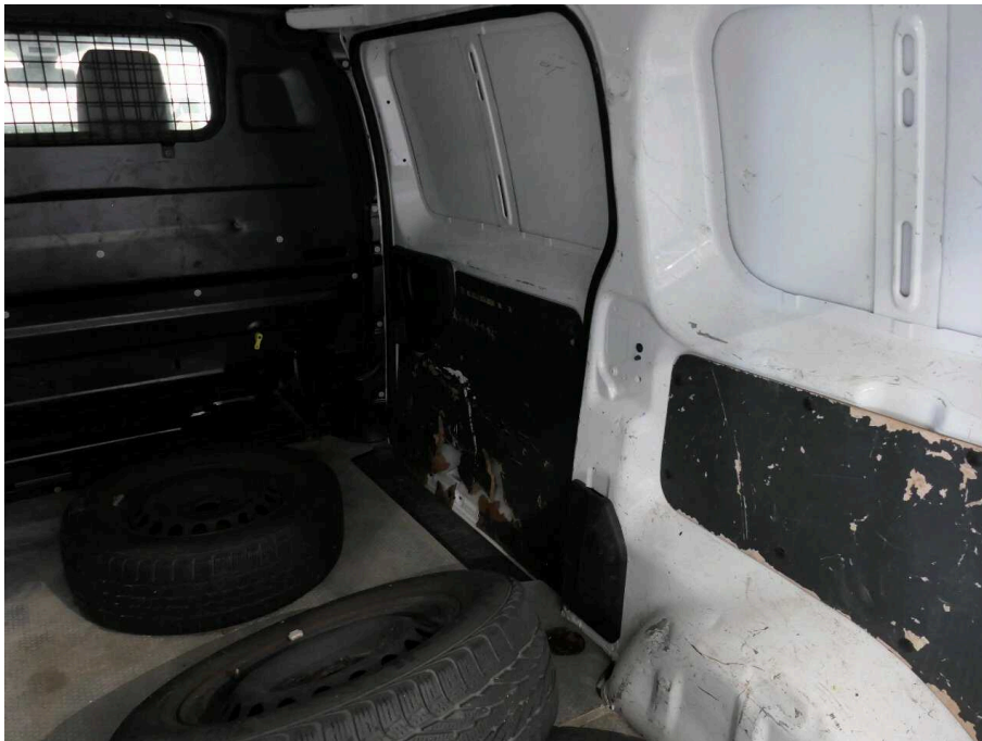
Bild 29 Innenraum Laderaumverkleidung rechts alle mit Schiebetürverkleidung gebrochen
