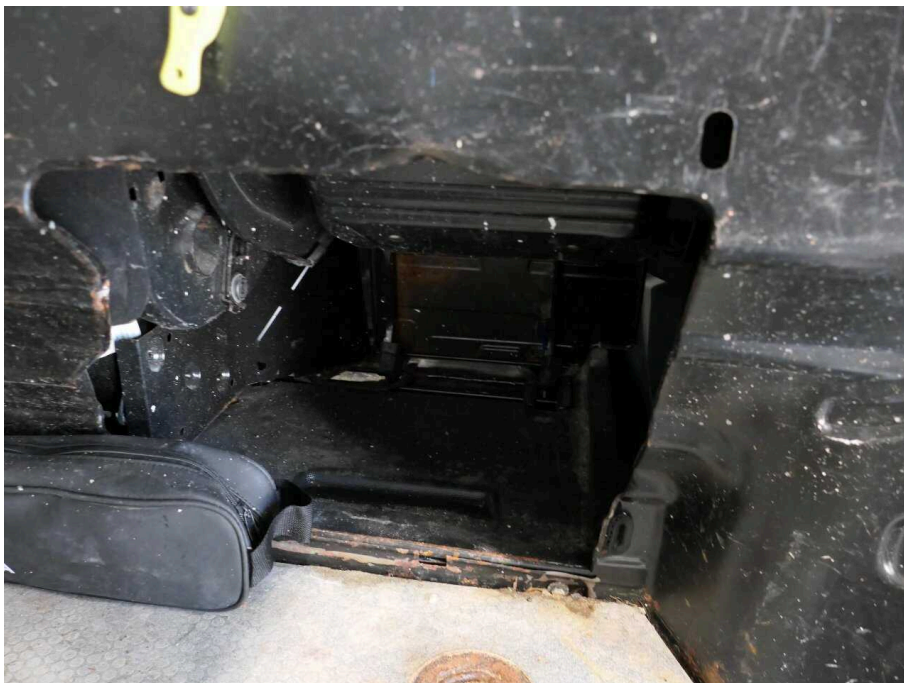
Bild 44 Fahrzeug Trennwand Laderaum Abdeckung fehlt
