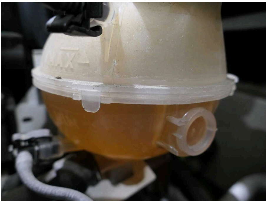
Bild 46 Wartung / Prüfung Kühlmittel zu niedrig
