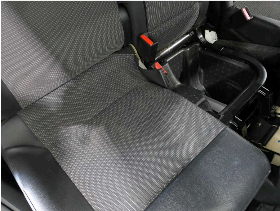
Bild 49 Innenraum Beifahrersitzbezug gerissen / eingerissen
