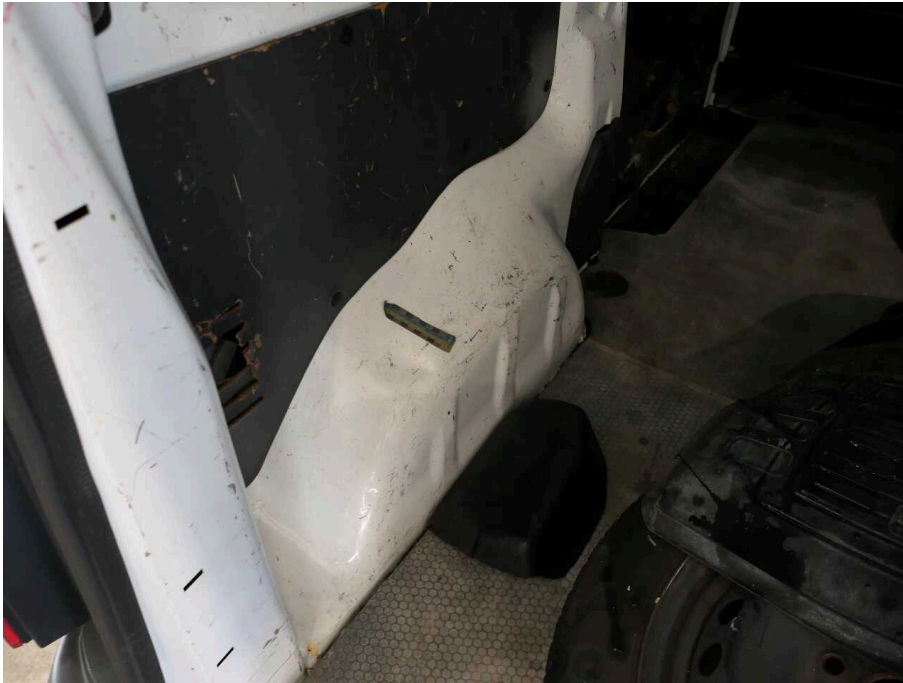
Bild 33 linke Seite Radhausschale hinten links deformiert
