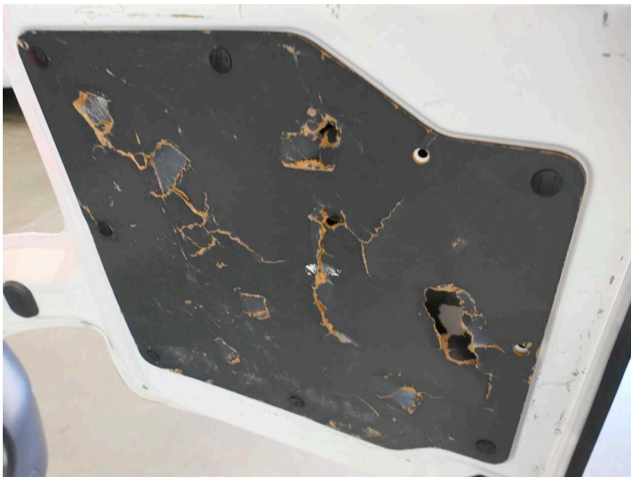
Bild 18 Innenraum Heckflügeltürverkleidung rechts gebrochen
