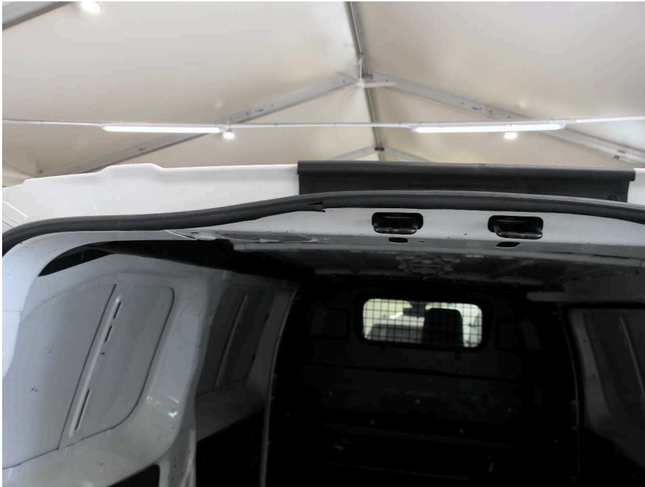
Bild 37 Fahrzeugheck Heckklappendichtung gerissen / eingerissen
