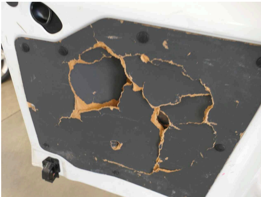
Bild 20 Innenraum Heckflügeltürverkleidung links gebrochen
