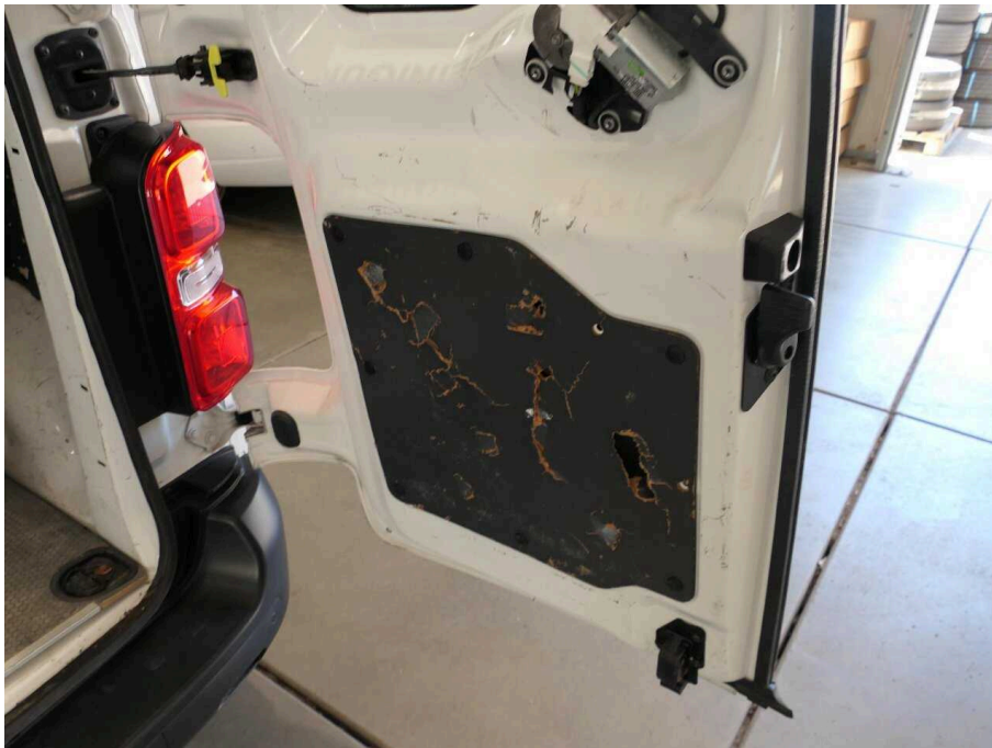
Bild 17 Innenraum Heckflügeltürverkleidung rechts gebrochen
