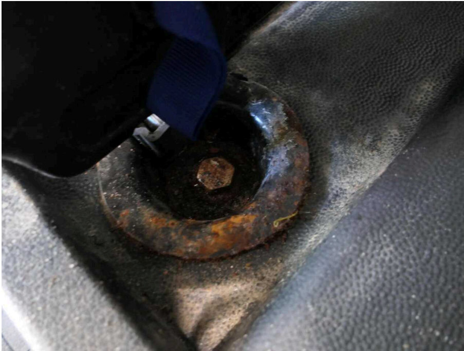
Bild 47 Innenraum Innenraum korrodiert
