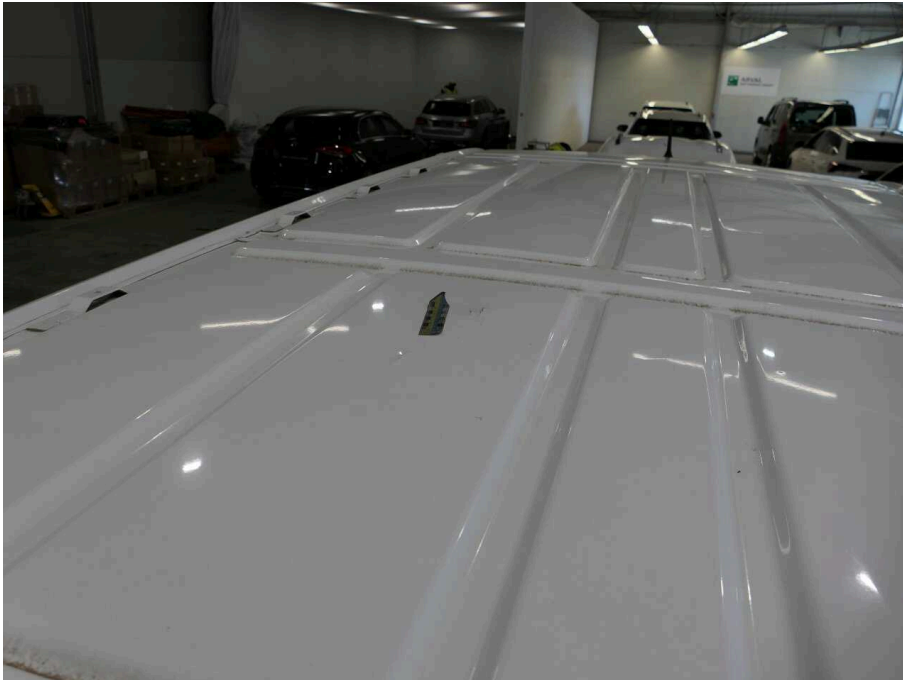
Bild 39 Dach Dachhaut Deformiert/Verkratzt
