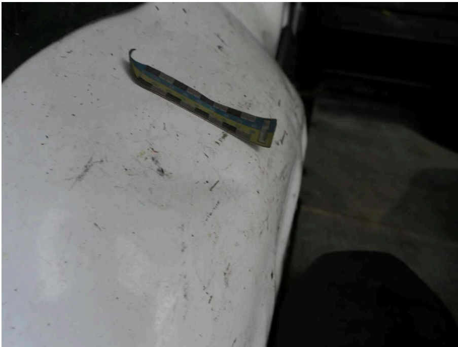
Bild 34 linke Seite Radhausschale hinten links deformiert
