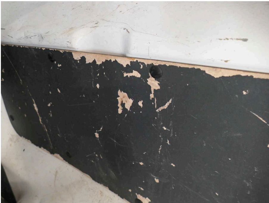
Bild 28 Innenraum Laderaumverkleidung rechts alle mit Schiebetürverkleidung gebrochen
