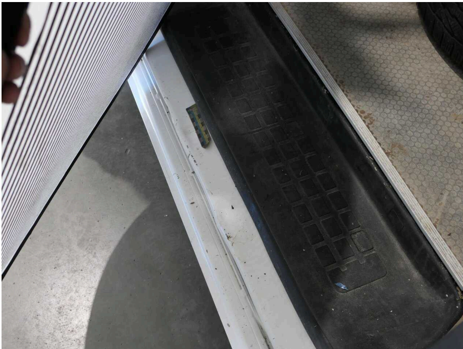
Bild 86 rechte Seite Einstieg Schiebetür rechts eingedrückt
