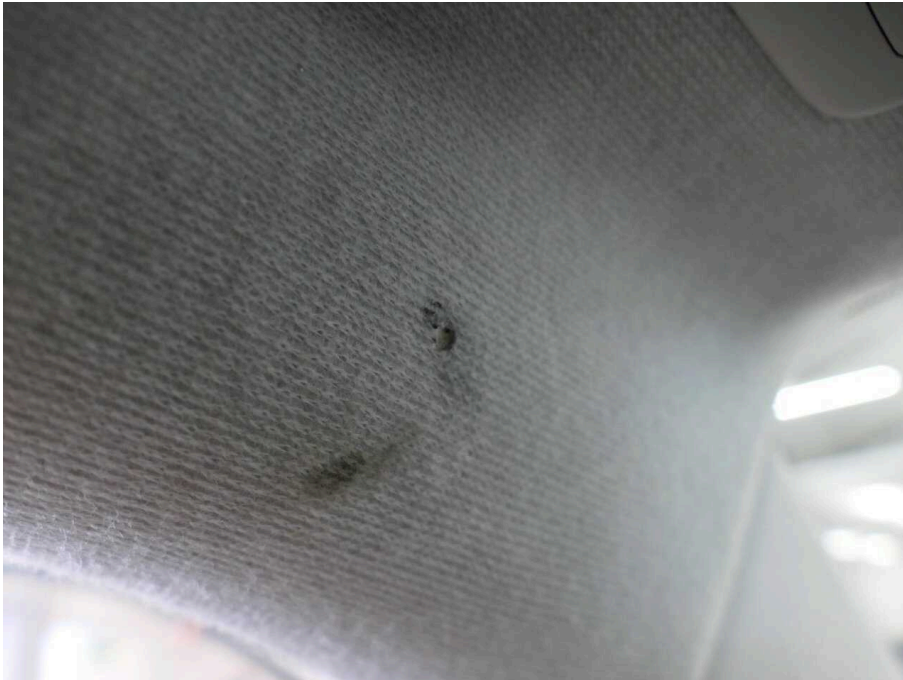
Bild 53 Innenraum Dachhimmel Brandloch / -löcher
