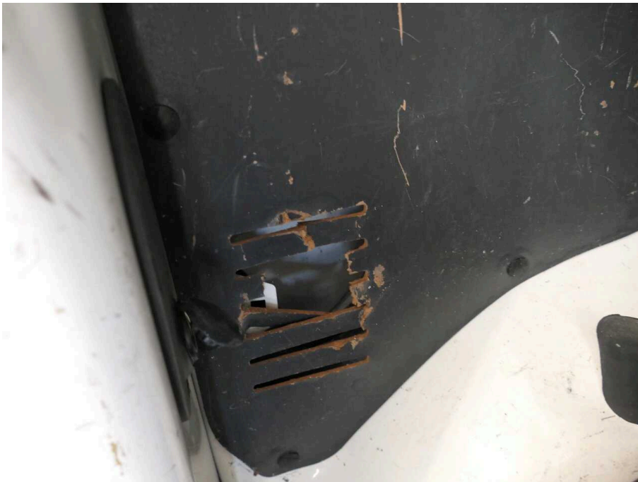
Bild 24 Innenraum Laderaumverkleidung links alle gebrochen
