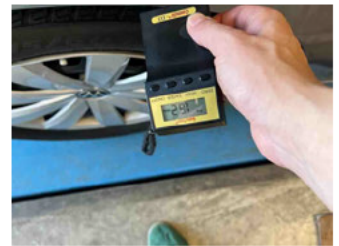
Lackstärke Seitenwand hinten rechts
