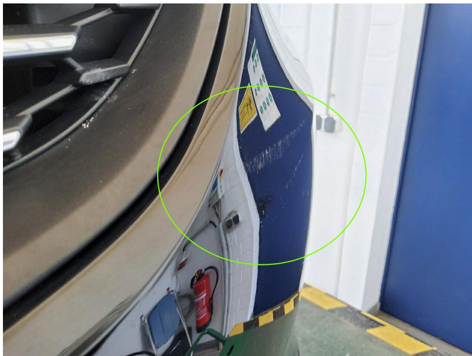
Bild 12 : Stoßfänger vorne Lackierung, verschrammt, lackieren mit Lackaufbau
