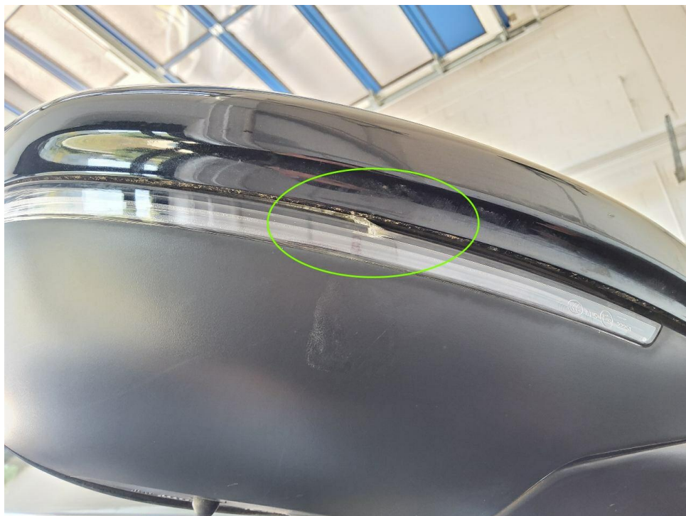
Bild 18 : Blinkerglas und Spiegelkappe rechts gebrochen
