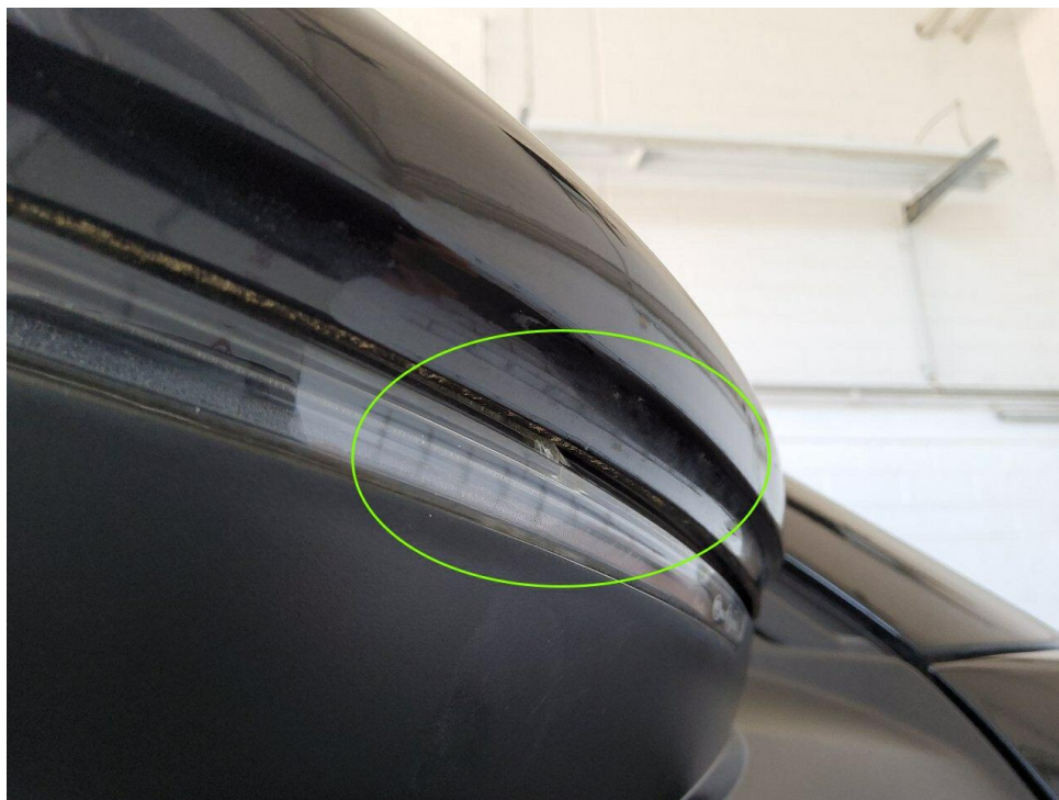
Bild 17 : Blinkerglas und Spiegelkappe rechts gebrochen
