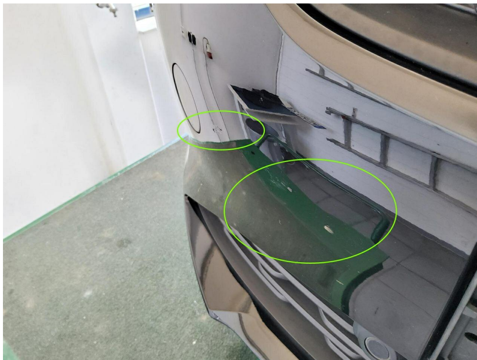
Bild 13 : Stoßfänger vorne Lackierung, verschrammt, lackieren mit Lackaufbau
