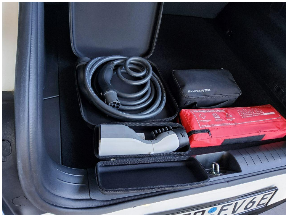
Bild 6 : Ladekabel beim E-Fahrzeug
