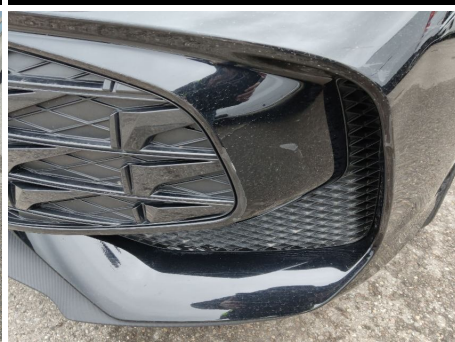
Stoßfängergrill / Vorne / Kratzer
