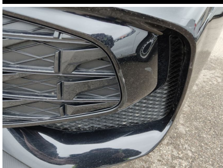
Stoßfängergrill / Vorne / Kratzer
