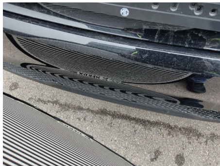
Stoßfänger / Hinten / Delle
