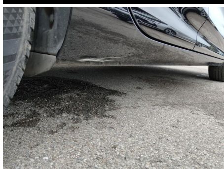
Schweller / Rechts / Delle
