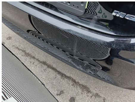
Stoßfänger / Hinten / Delle
