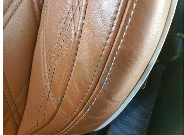
Beschädigung #7: Sitz vorn: Sitzbezug links - verkratzt / verschürft - erneuern
