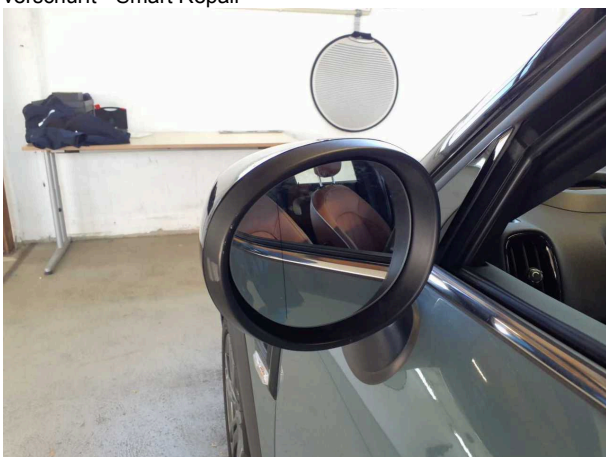
Beschädigung #6: Außenspiegel links: Spiegelgehäuse - verkratzt / verschürft - erneuern
