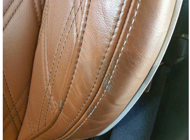
Domage #7: Siège avant: Revêtement du siège gauche - Eraflé - Remplacer
