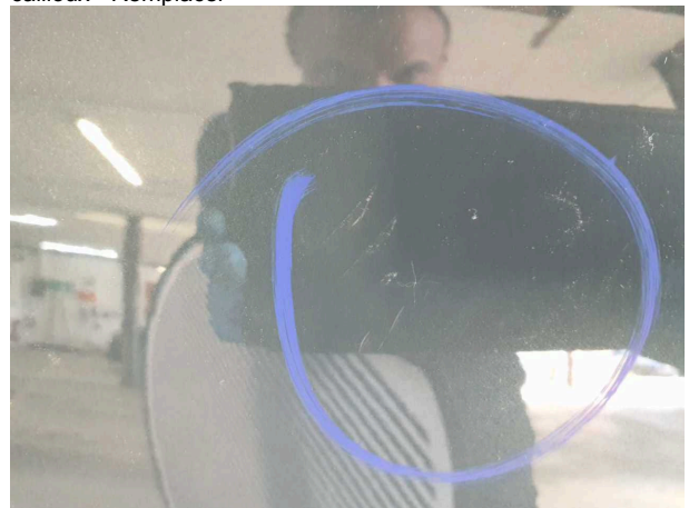
Domage #10: Panneau latéral arrière gauche: Paroi latérale... Bosse, dommage peinture - Réparer et repeindre
