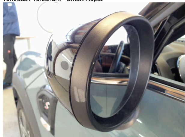
Beschädigung #6: Außenspiegel links: Spiegelgehäuse - verkratzt / verschürft - erneuern
