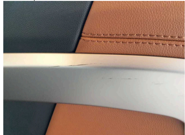
Dommage #2: Habillages/Protections: Bague d'enjoliveur / de décoration (Türverkleidung HR) - Eraflé - Remplacer
