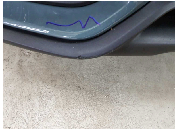
Beschädigung #4: Stossfänger vorn: Spoiler - verkratzt / verschürft - Wertminderung
