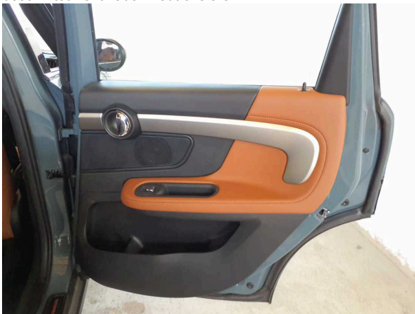
Beschädigung #2: Verkleidungen/Abdeckungen: Zierleiste / Dekorleiste (Türverkleidung HR) - verkratzt / verschürft - erneuern
