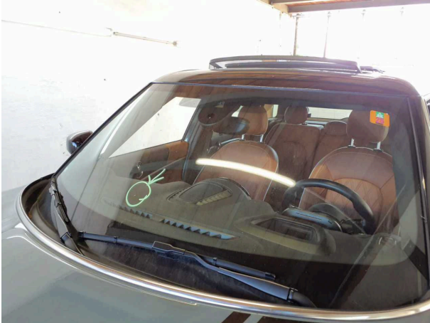
Beschädigung #9: Verglasung: Frontscheibe - Steinschlag - erneuern
