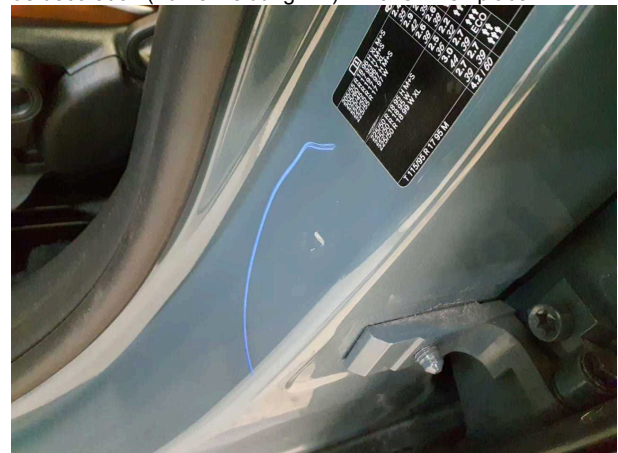
Dommage #3: Seuil gauche: Accès - Bosse, dommage peinture - Réparation intelligente
