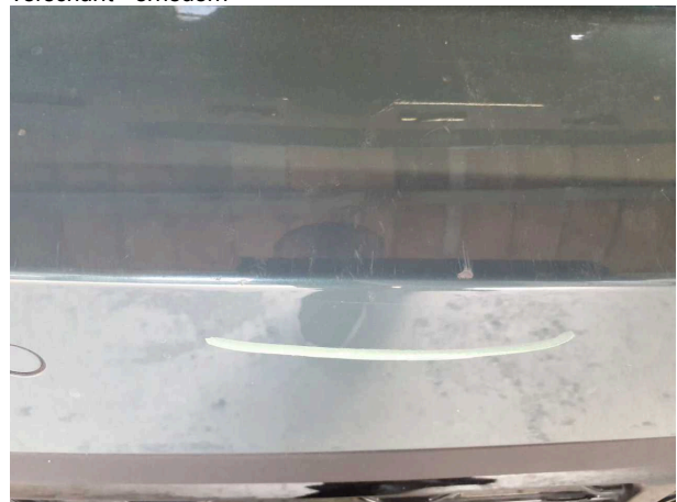
Beschädigung #8: Stossfänger hinten: Stossfänger hinten - verkratzt / verschürft - instandsetzen und lackieren
