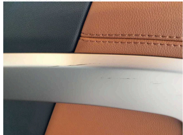
Beschädigung #2: Verkleidungen/Abdeckungen: Zierleiste / Dekorleiste (Türverkleidung HR) - verkratzt / verschürft -
