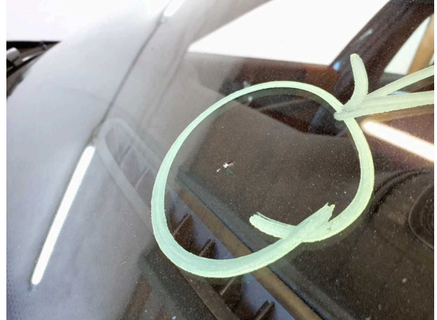
Beschädigung #9: Verglasung: Frontscheibe - Steinschlag - erneuern
