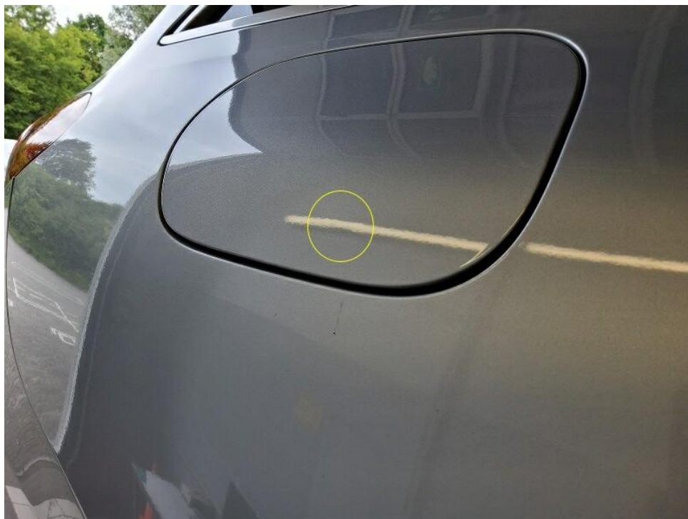
Bild 19 : Tankklappe kleine Dellen
