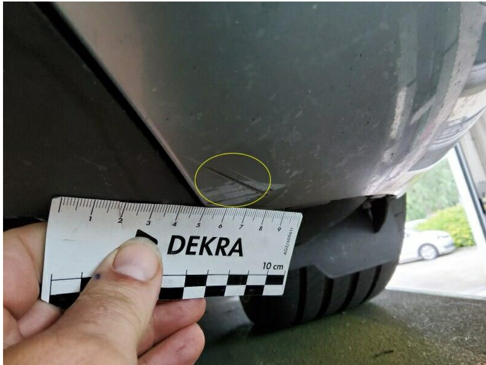
Bild 23 : Frontstoßfängerverkleidung unten links kleine Verschrammung unterhalb des Sichtbereichs
