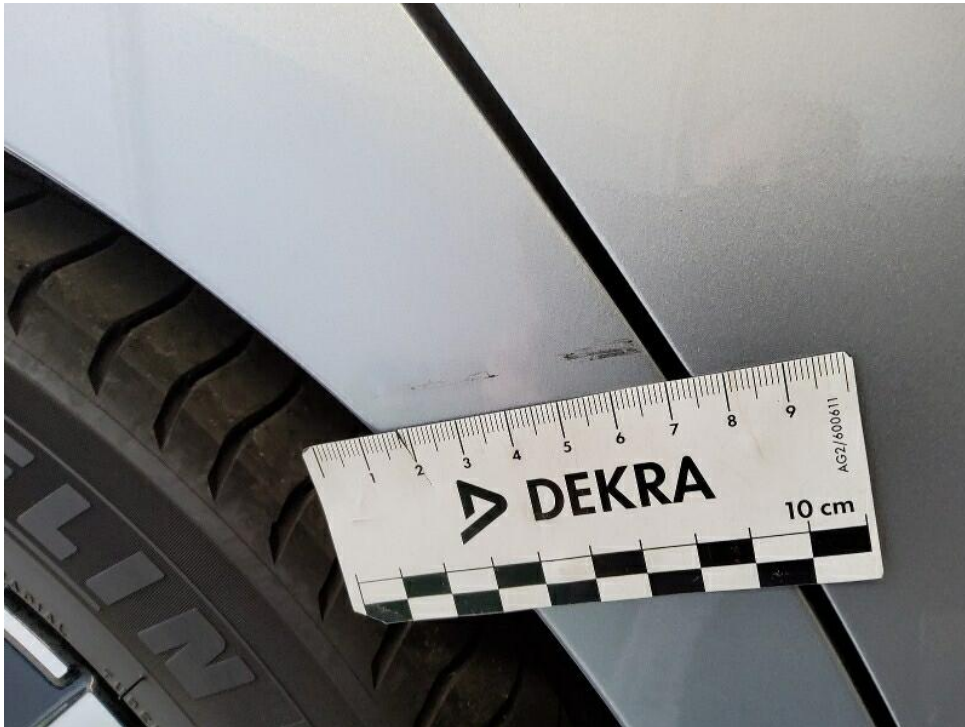
Bild 17 : Radlauf hinten rechts längliche Anhaftung
