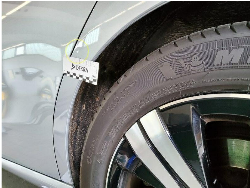
Bild 21 : Radlauf hinten links kleinere "weiche" Delle
