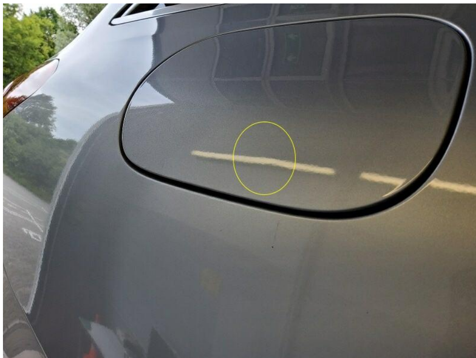
Bild 20 : Tankklappe kleine Dellen
