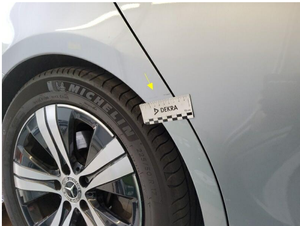
Bild 16 : Radlauf hinten rechts längliche Anhaftung
