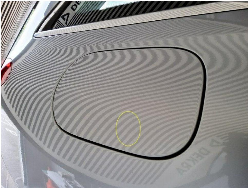
Bild 18 : Tankklappe kleine Dellen
