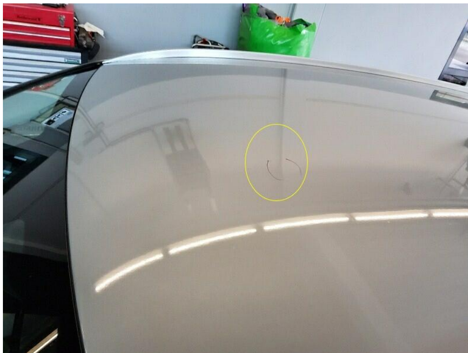
Bild 14 : Dach einzelne kleinere "weiche" Delle
