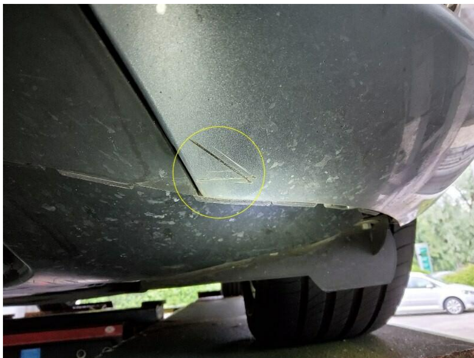
Bild 24 : Frontstoßfängerverkleidung unten links kleine Verschrammung unterhalb des Sichtbereichs
