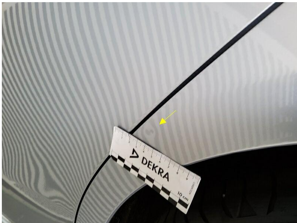
Bild 22 : Radlauf hinten links kleinere "weiche" Delle
