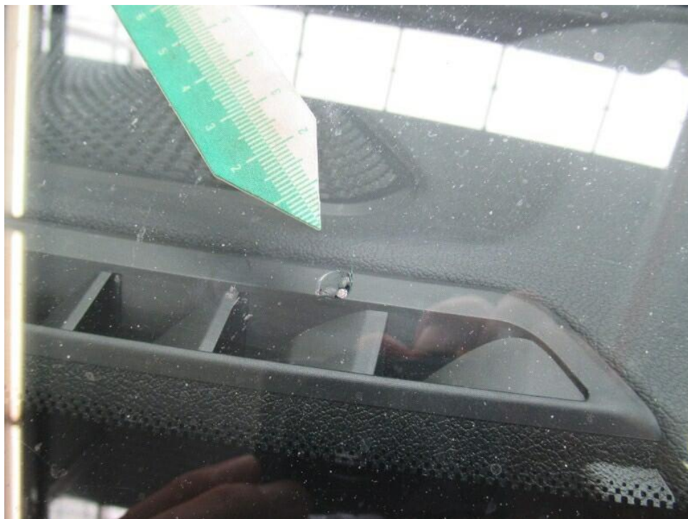
Bild 17 : - T - Frontscheibe Steinschlag
