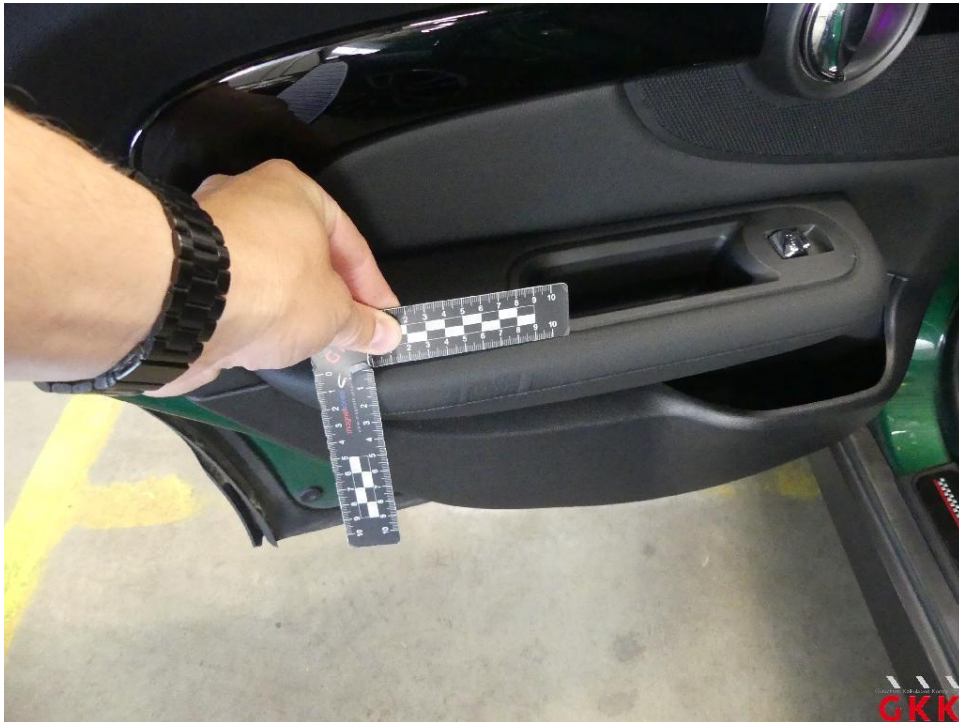
Bild 23 Tür hinten links, Innenverkleidung -Leder-, Druckstellen, ersetzen
