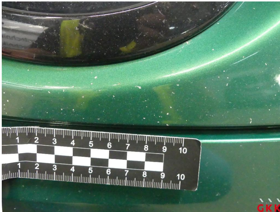
Bild 17 Motorhaube, Steinschlag, lackieren
