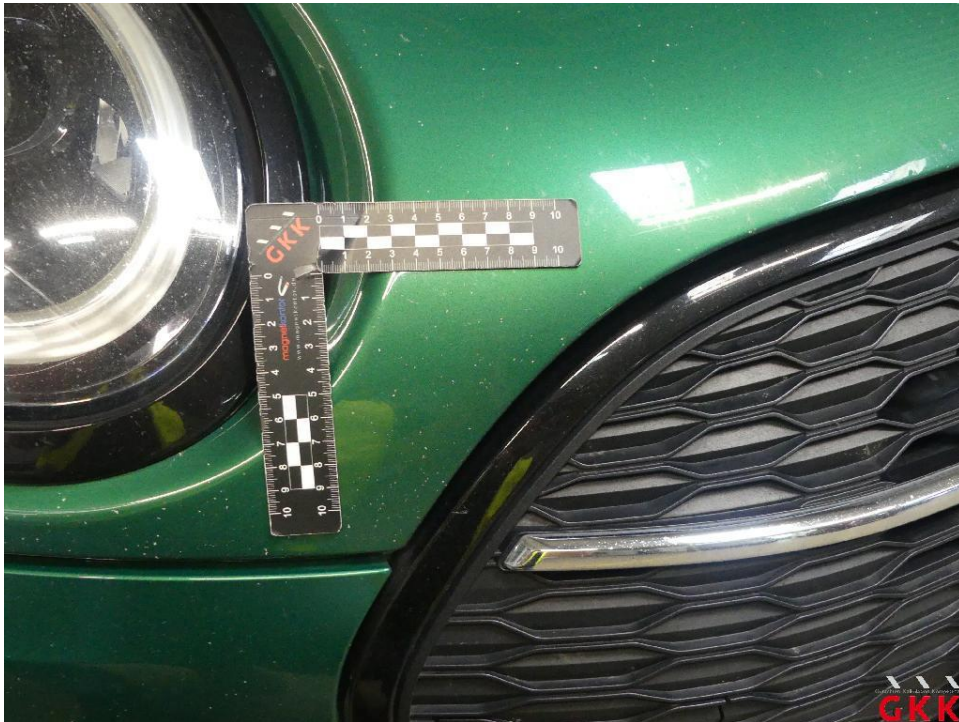
Bild 15 Motorhaube, Steinschlag, lackieren
