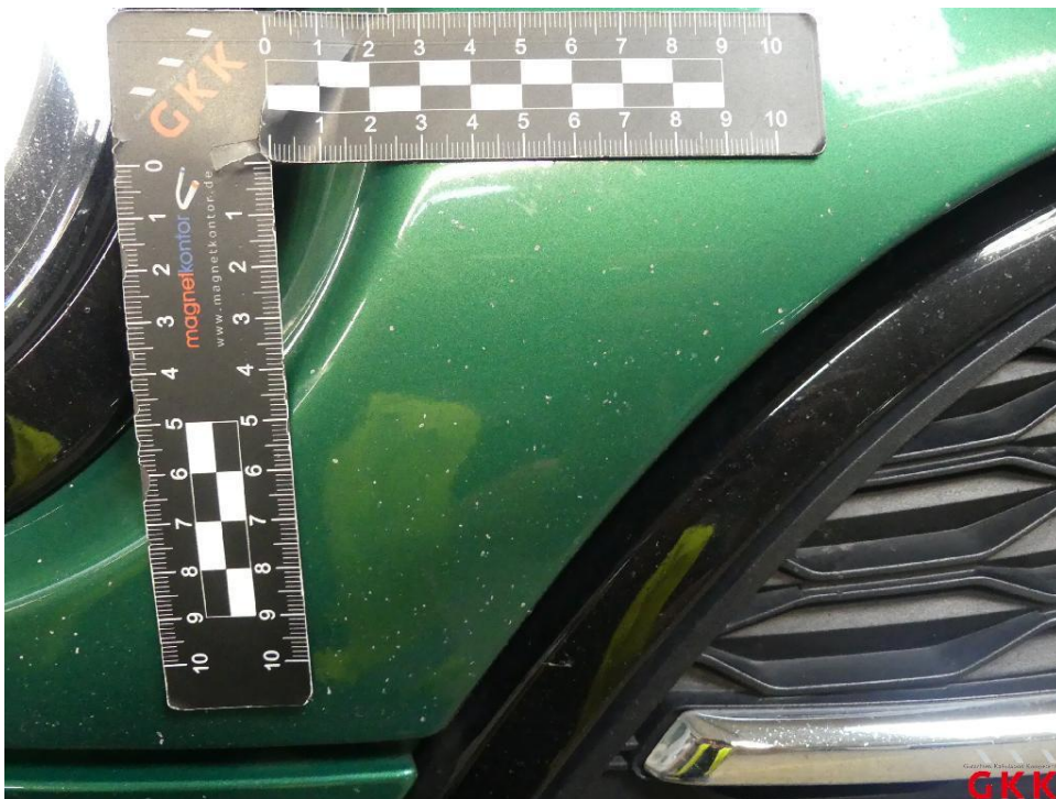
Bild 16 Motorhaube, Steinschlag, lackieren
