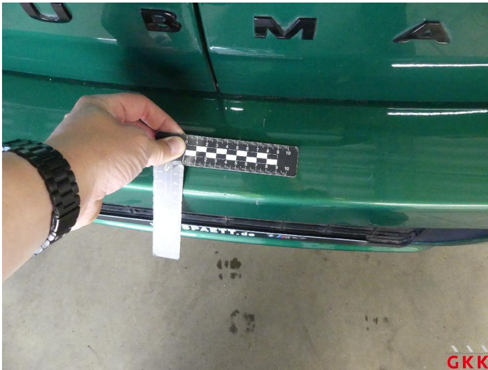
Bild 20 Stoßfänger hinten, Verkleidung -lackiert-, verkratzt, lackieren
