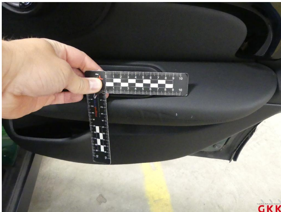
Bild 18 Tür hinten rechts, Innenverkleidung -Leder-, Druckstellen, ersetzen
