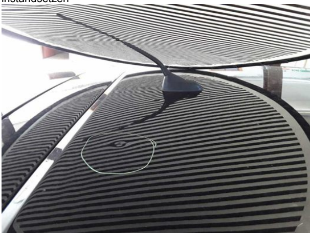
Beschädigung #10: Fahrzeugdach: Dach - Delle(n) - sanft instandsetzen
