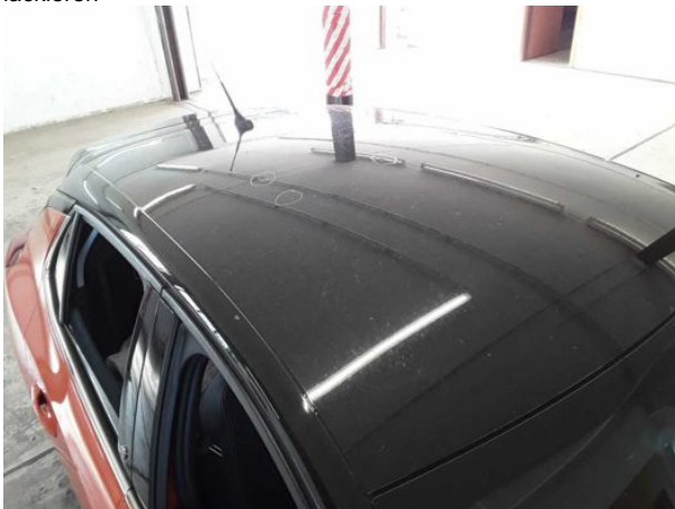
Beschädigung #10: Fahrzeugdach: Dach - Delle(n) - sanft instandsetzen
