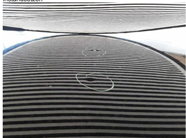
Beschädigung #10: Fahrzeugdach: Dach - Delle(n) - sanft instandsetzen
