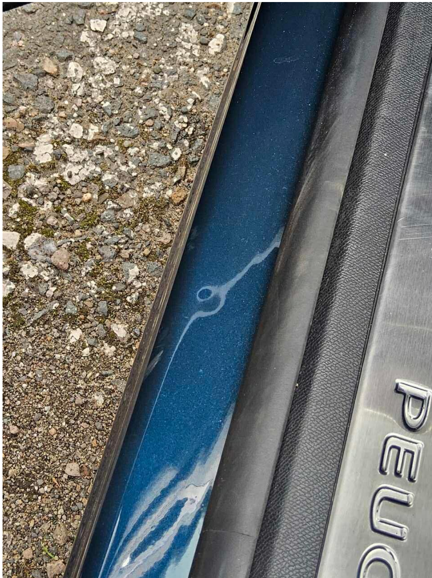
Bild 8 : Türeinstieg vorne links Delle
