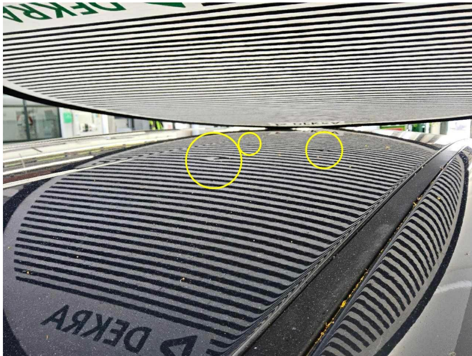
Bild 10 : Dach, mehrfach eingedellt, drücken
