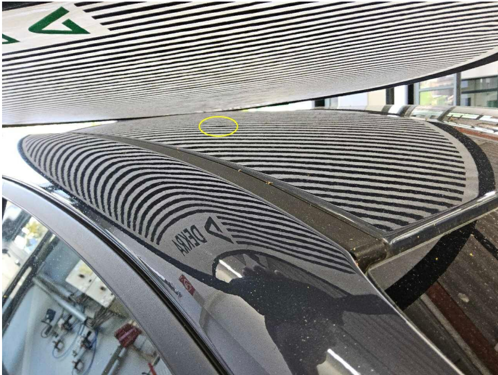
Bild 11 : Dach, mehrfach eingedellt, drücken
