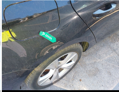
Aleta / Trasero Derecho / Abolladura
