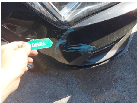
Paragolpes / Delantero / Abolladura
