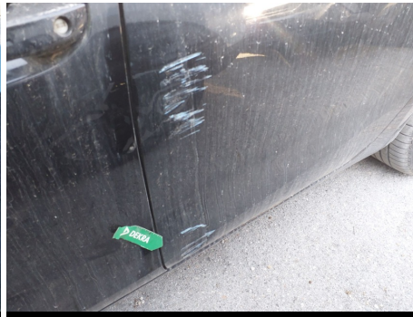
Puerta / Trasero Izquierdo / Abolladura
