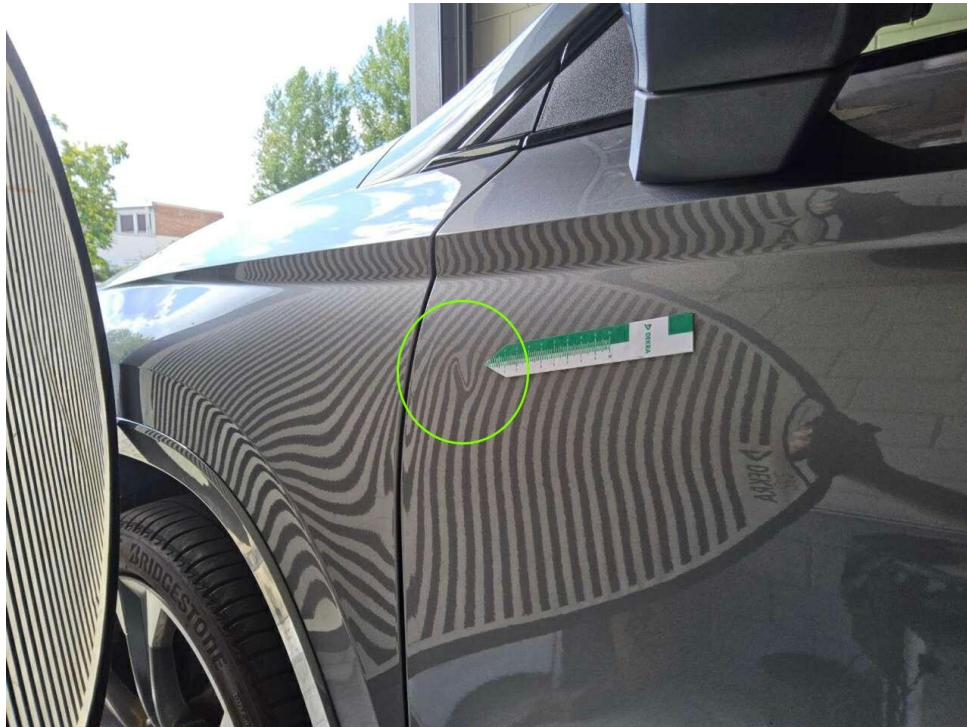
Bild 15 : Tür vorne links, eingedellt, drücken
