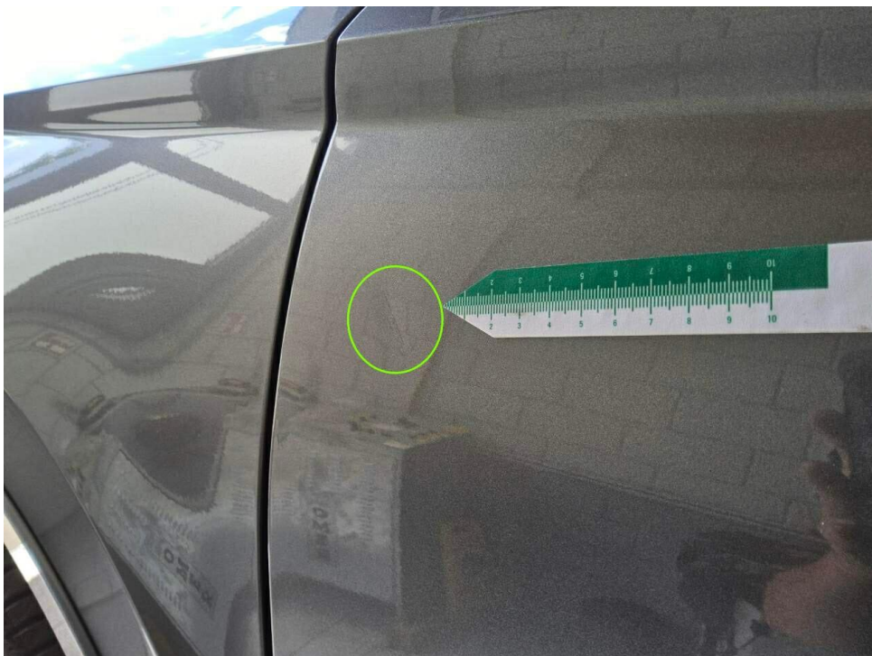
Bild 14 : Tür vorne links Lackierung, zerkratzt, polieren
