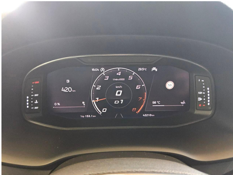
Bild 5 : Kombiinstrument (betriebsbereit) mit Km-Stand
