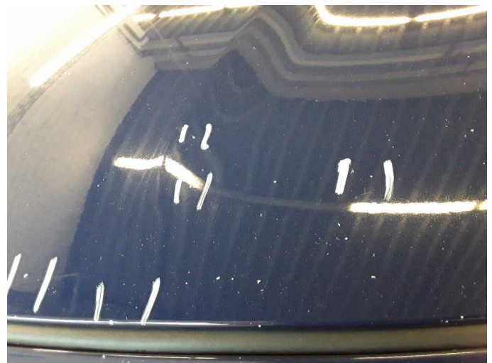
Damage 7: Bonnet: Bonnet (Sandstrahleffekt + Dämmmatte erneuern) - Stone chips - Paint
