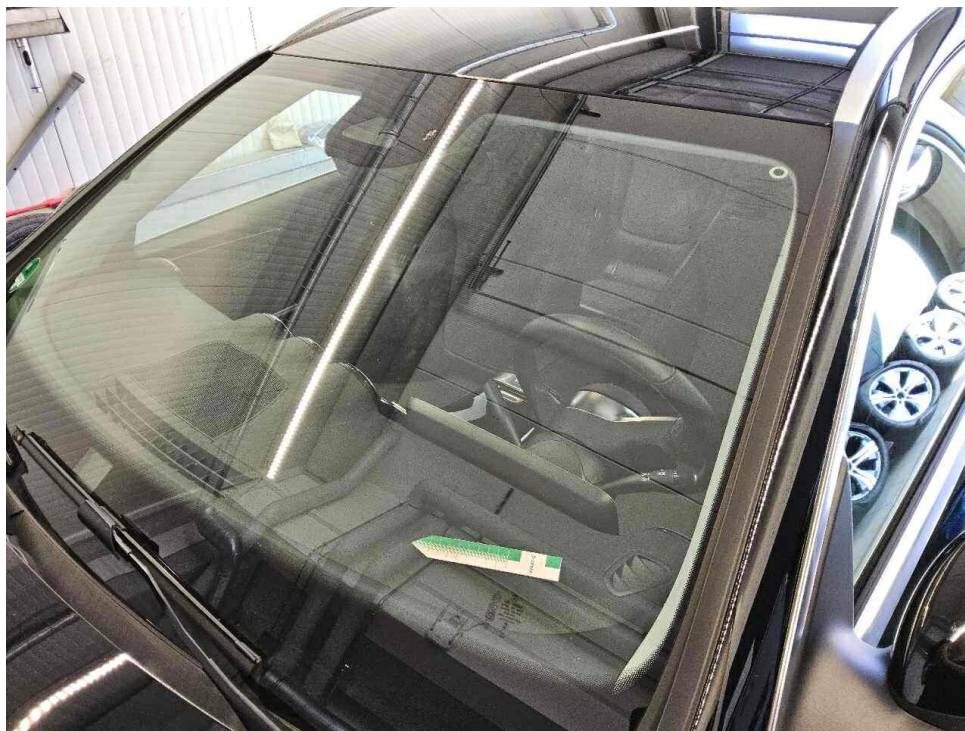
Bild 16 : Frontscheibe, mehrere leichte Abplatzungen
