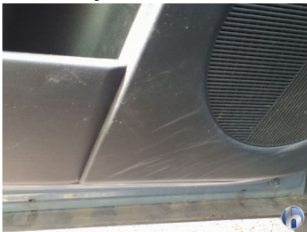
13. Verkleidung Verschmutzt - Reinigen
