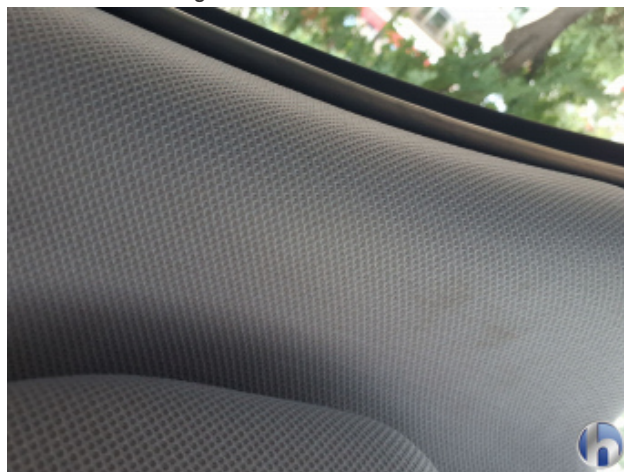
12. Dachhimmel Verschmutzt - Reinigen
