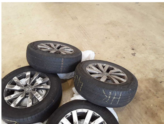
Damage 2: 2nd wheel set: 2 tyres (Innen abgefahren) - Worn - Replace
