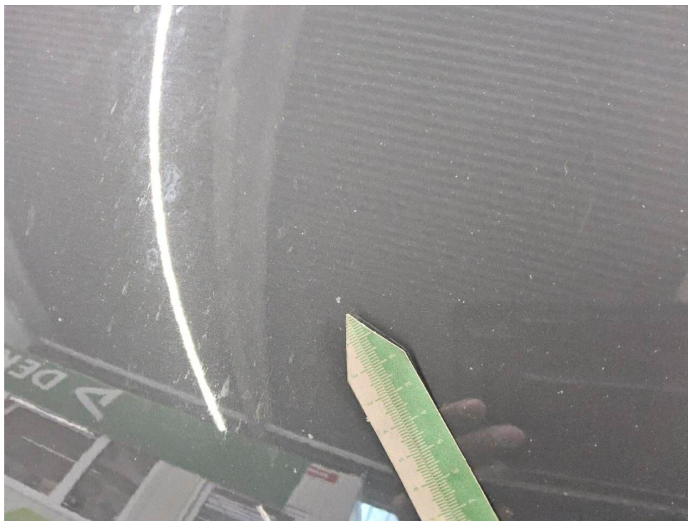
Bild 20 : Motorhaube Lackierung, Steinschlag, Gebrauchsspur
