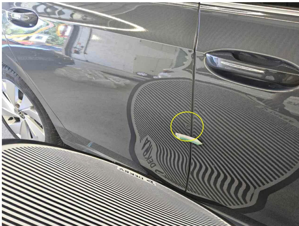
Bild 21 : Tür hinten rechts, eingedellt, drücken
