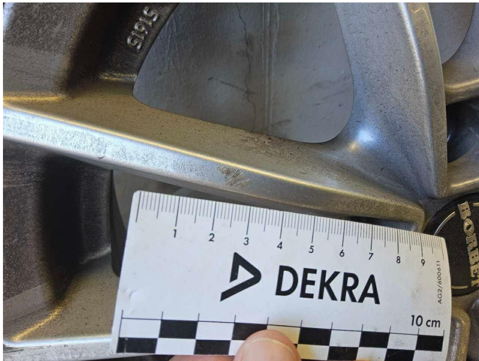
Bild 29 : LM Felge vorne rechts, Winter zerkratzt
