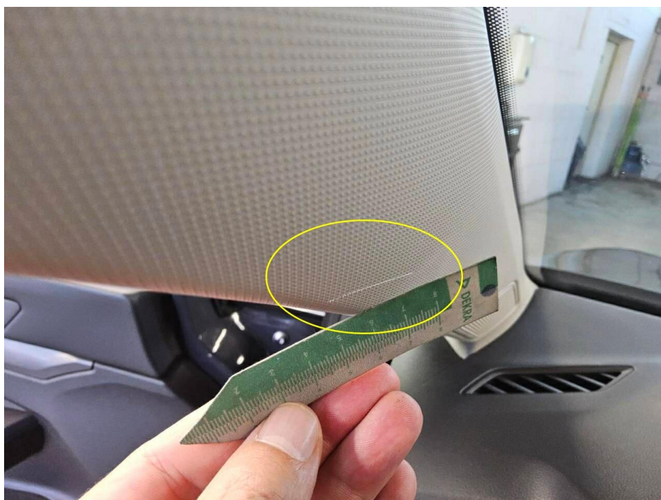
Bild 28 : Verkleidung A-Säule links, smart repair
