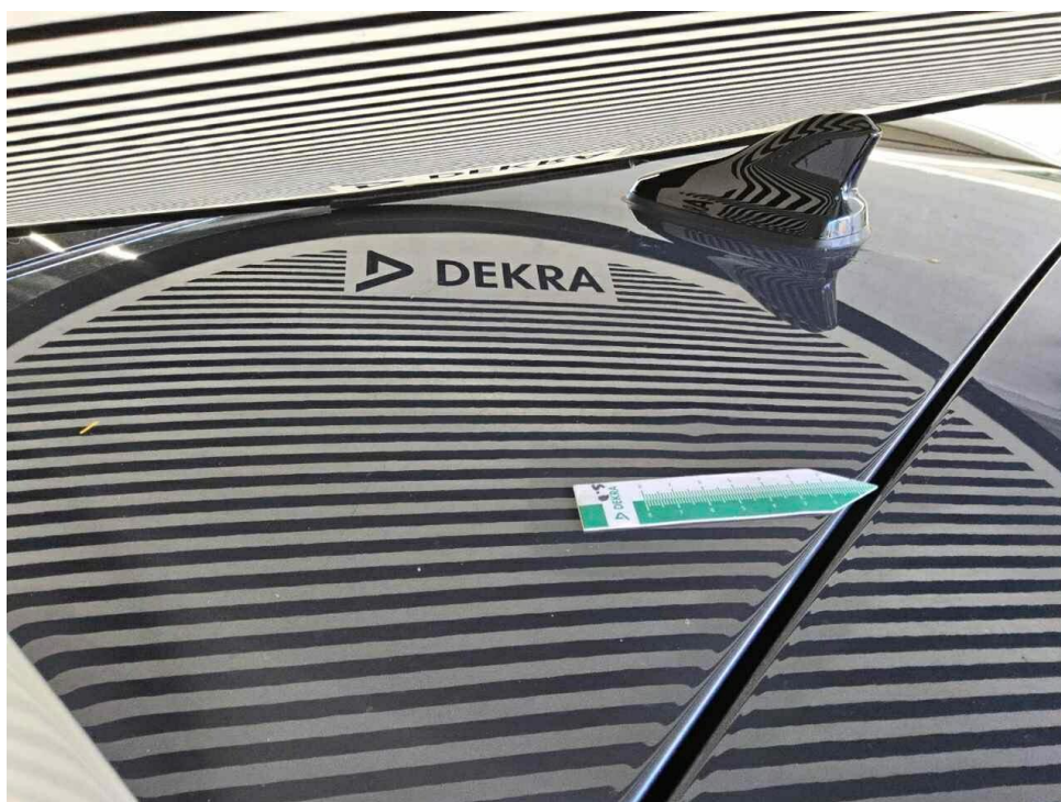
Bild 24 : Dach, eingedellt, Gebrauchsspur
