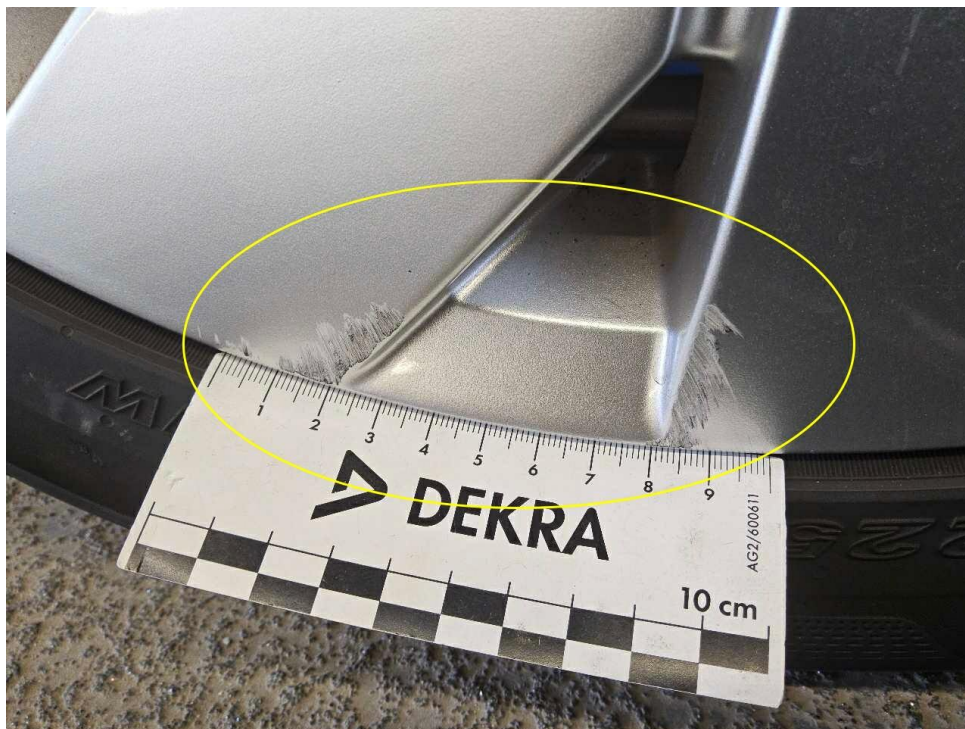
Bild 31 : LM Felge vorne rechts verschrammt, Sommer
