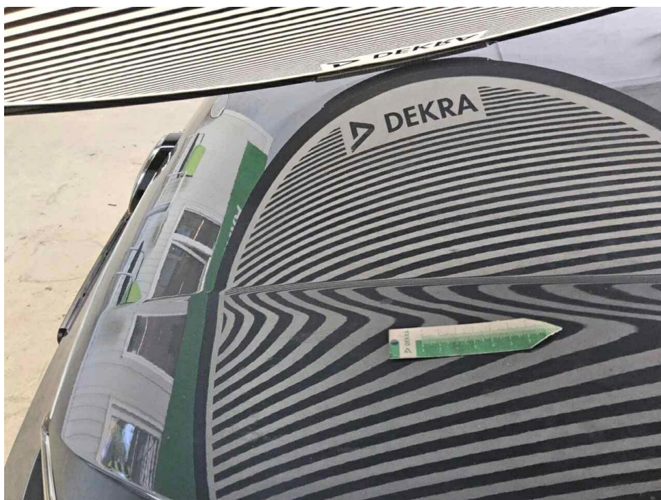
Bild 16 : Motorhaube, eingedellt, Gebrauchsspur
