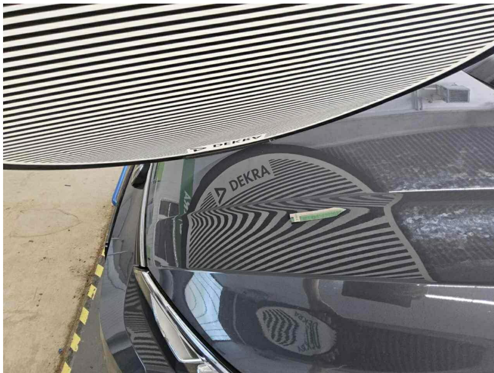
Bild 15 : Motorhaube, eingedellt, Gebrauchsspur
