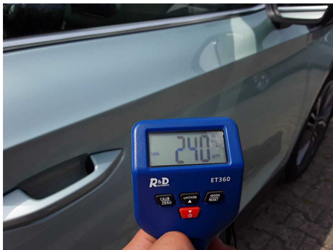
Door - front right side: 240 µm
