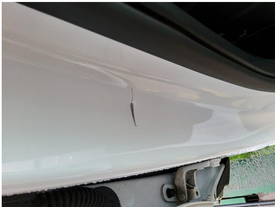
Bild 8 : Türeinstieg vorne rechts Beschädigt
