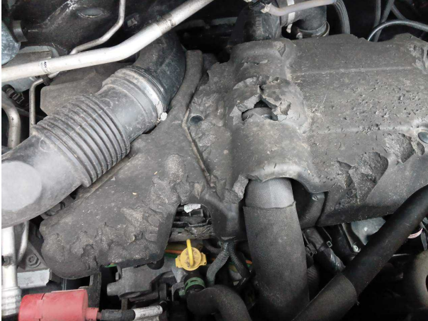
Beschädigung #1: Motor: Motorabdeckung - Marderschaden - erneuern
