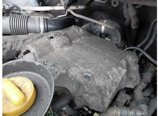
Beschädigung #1: Motor: Motorabdeckung - Marderschaden - erneuern
