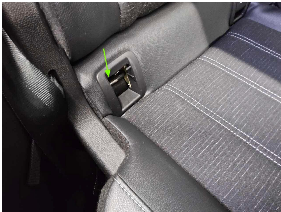
Bild 11 : Sitz hinten rechts, Isolierung Abdeckung, defekt
