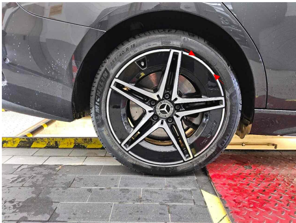
Bild 15 : Sommerfelge hinten rechts am Felgenhorn verschrammt
