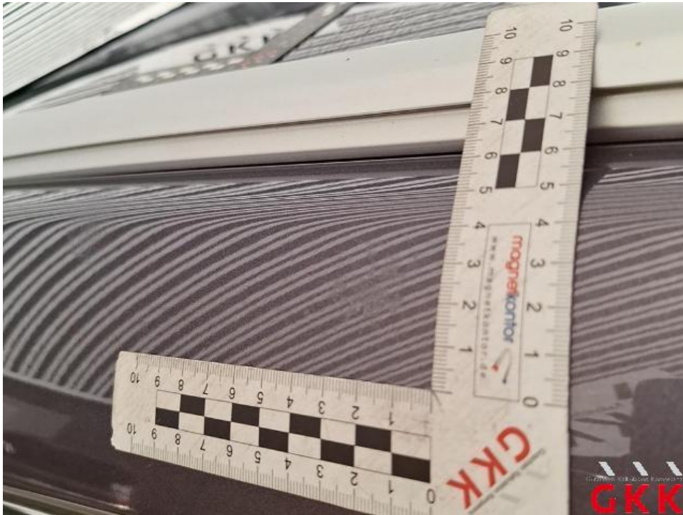
Bild 23 Minderwert: 60,00 EUR Dach, Lackierung verwittert / matt, polieren
