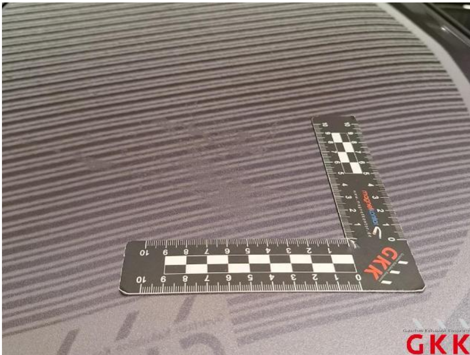
Bild 22 Minderwert: 60,00 EUR Dach, Lackierung verwittert / matt, polieren
