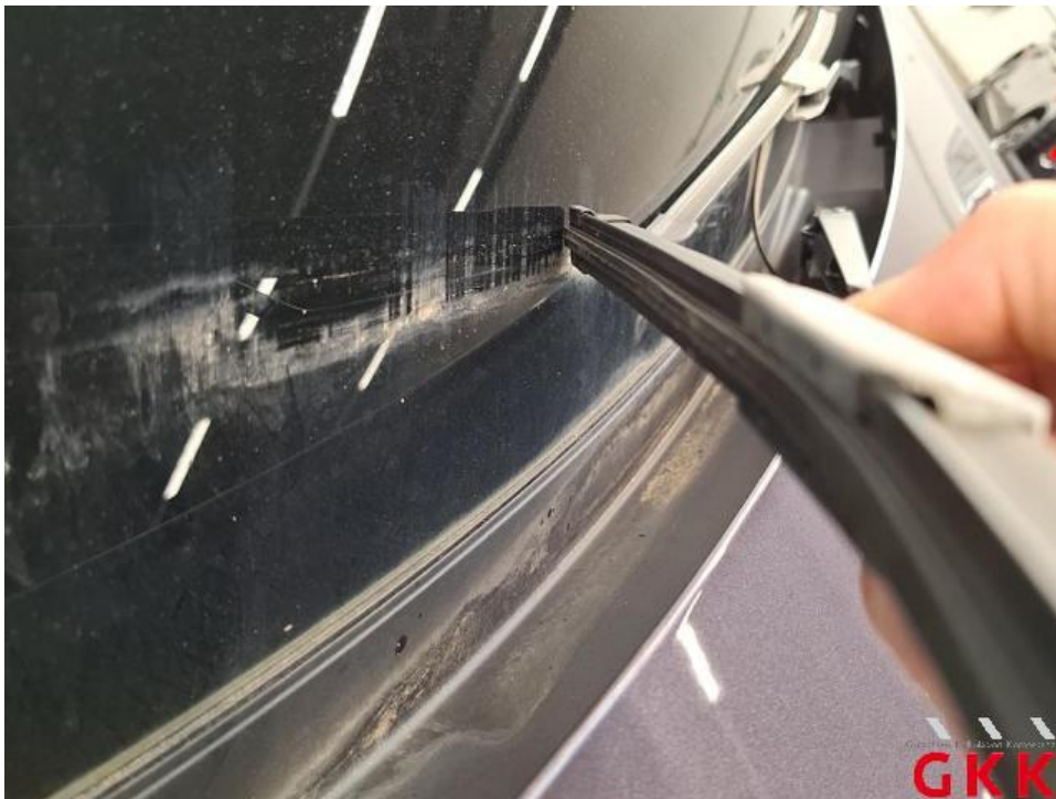
Bild 28 Minderwert: 108,69 EUR Scheibenwischer vorne, Blatt -Satz-, beschädigt, ersetzen
