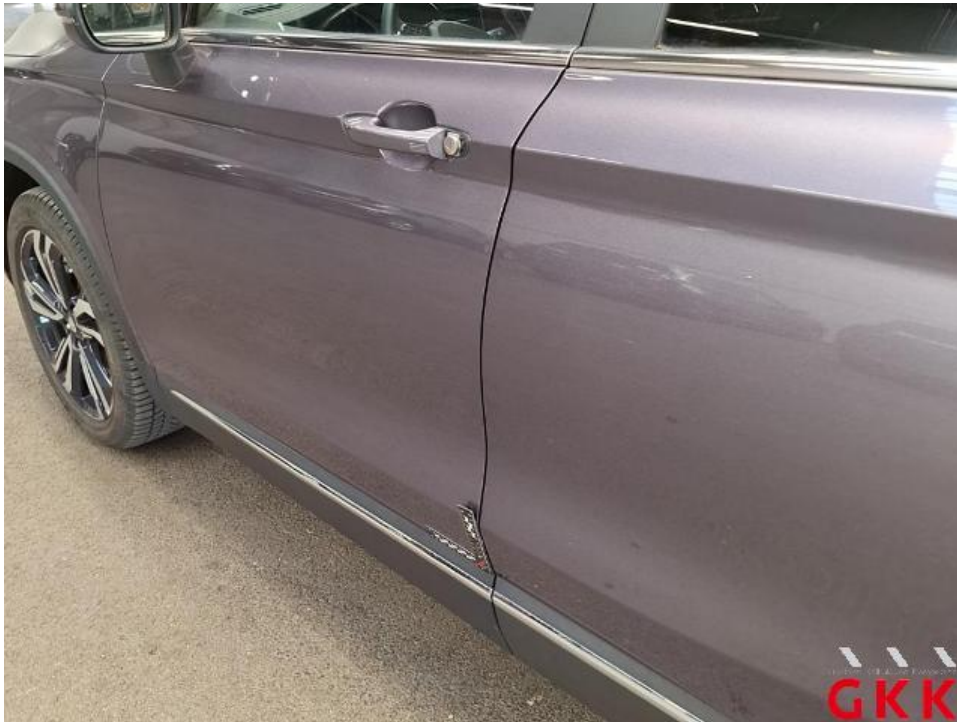
Bild 25 Minderwert: 60,00 EUR Tür vorne links, Kante, verkratzt, Smartrepair
