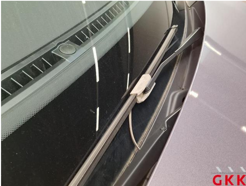
Bild 27 Minderwert: 108,69 EUR Scheibenwischer vorne, Blatt -Satz-, beschädigt, ersetzen
