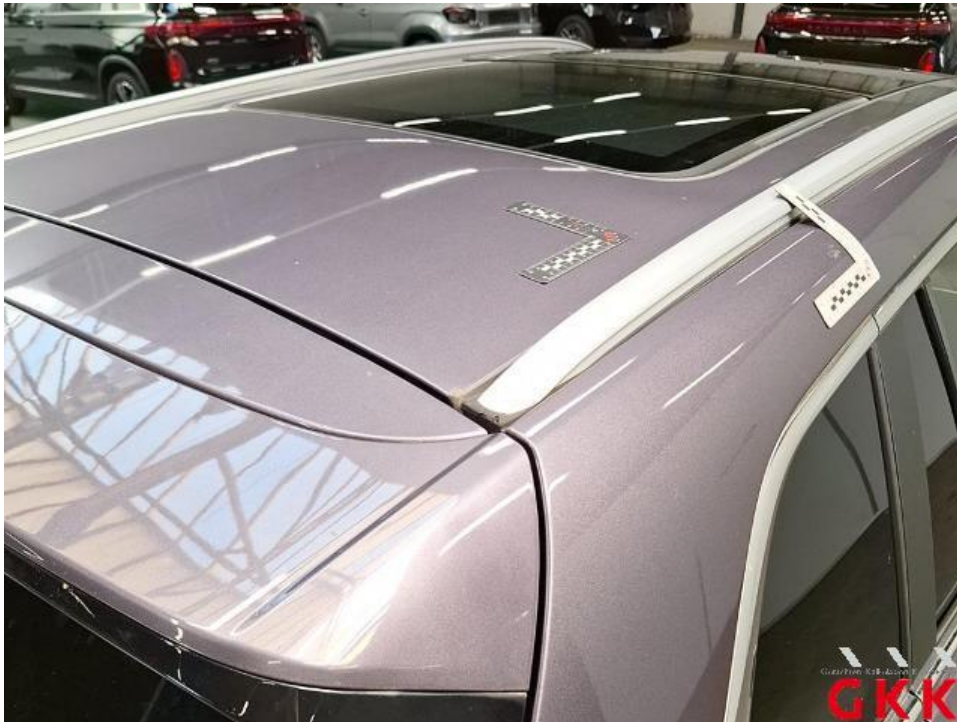
Bild 21 Minderwert: 60,00 EUR Dach, Lackierung verwittert / matt, polieren
