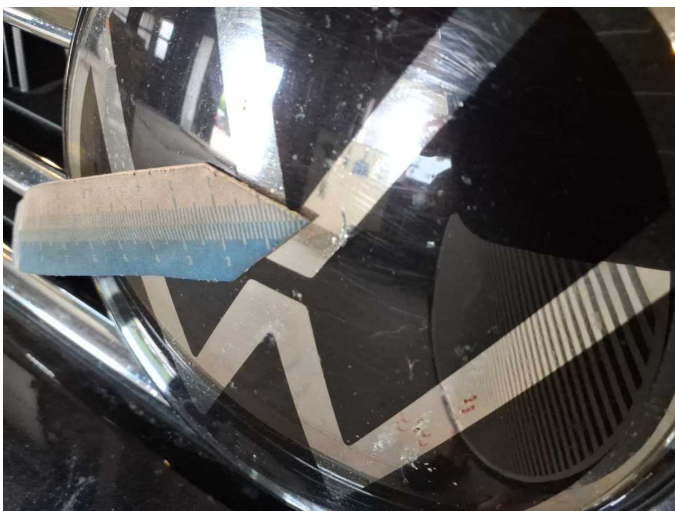
Damage 2: Bonnet: Emblem (Rissbildung) - Stone chips - Replace
