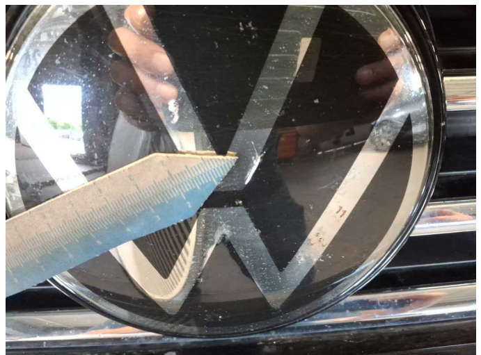
Damage 2: Bonnet: Emblem (Rissbildung) - Stone chips - Replace
