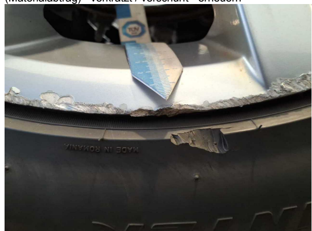
Beschädigung #7: Rad/Reifen: Leichtmetallfelge vorn rechts (Materialabtrag) - verkratzt / verschürft - erneuern
