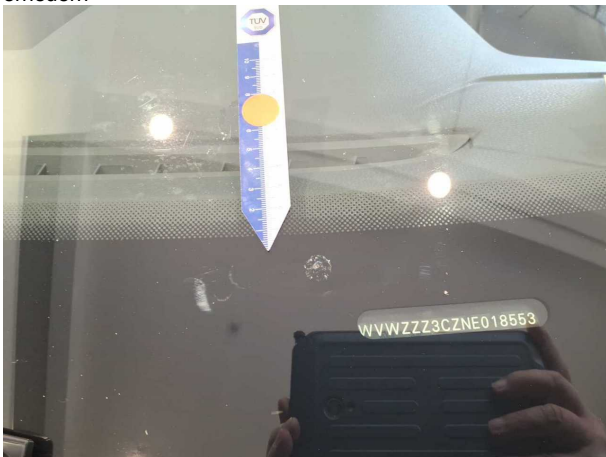
Beschädigung #8: Verglasung: Frontscheibe - Steinschlag - erneuern
