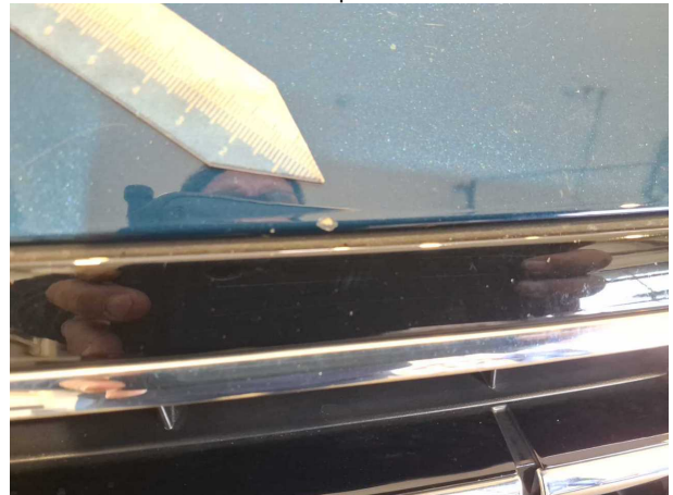
Beschädigung #2: Motorhaube: Motorhaube - Steinschlag - Smart Repair
