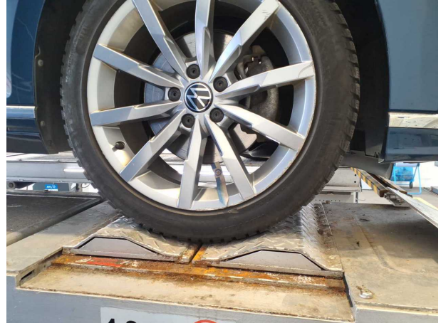
Beschädigung #4: Rad/Reifen: Reifen vorn rechts - gebrochen / gerissen - erneuern
