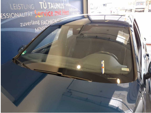
Beschädigung #8: Verglasung: Frontscheibe - Steinschlag - erneuern
