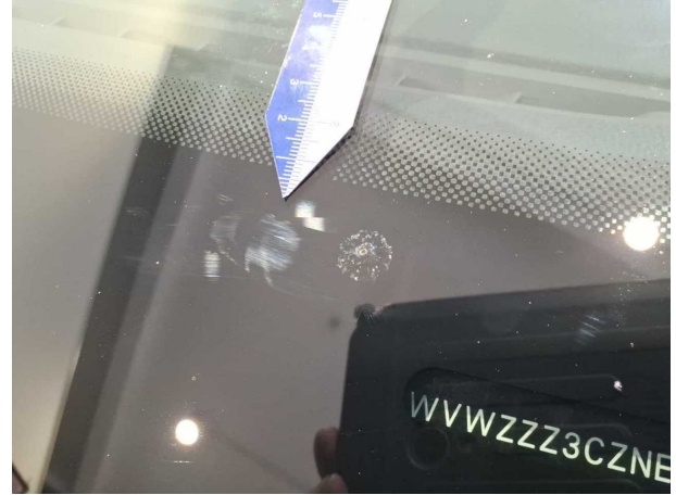
Beschädigung #8: Verglasung: Frontscheibe - Steinschlag - erneuern
