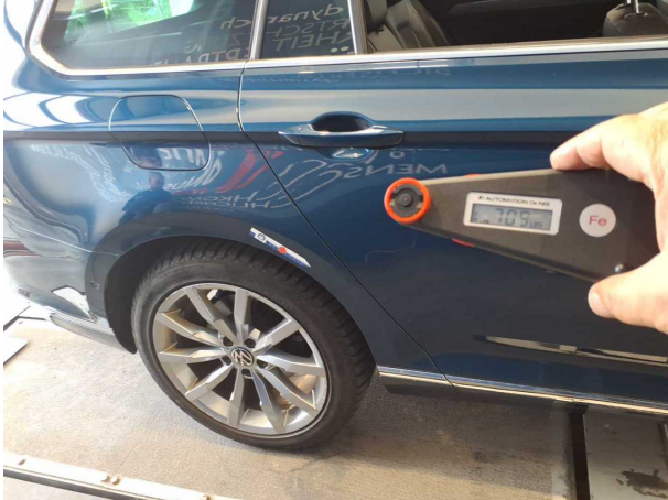
Nacklackierung 1: Seitenwand rechts, Tür hinten rechts
