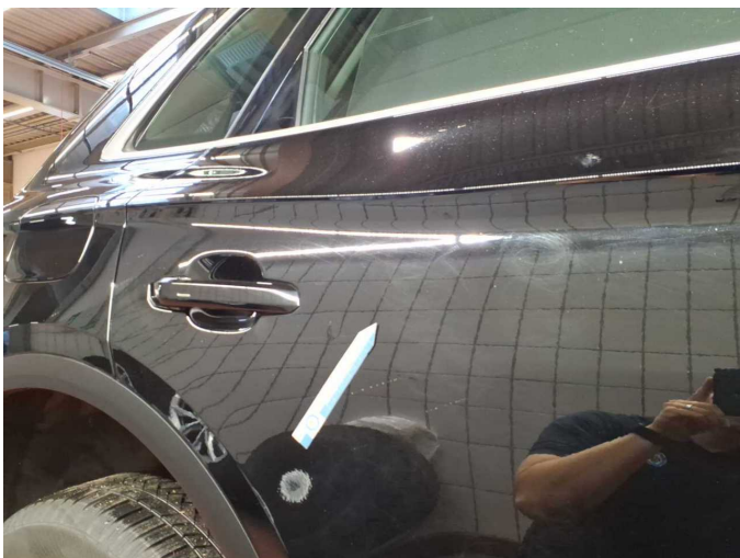
Damage 4: Door - rear right side: Door (+ Polieren, Folgekosten möglich) - dent(s) - Smart repair
