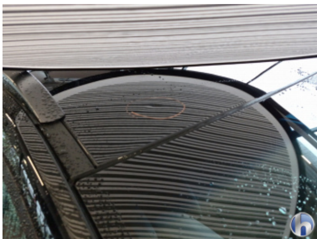
1. Dach 3 Dellen - Sanft Instandsetzen
