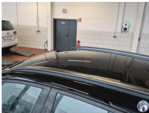
1. Dach 3 Dellen - Sanft Instandsetzen
