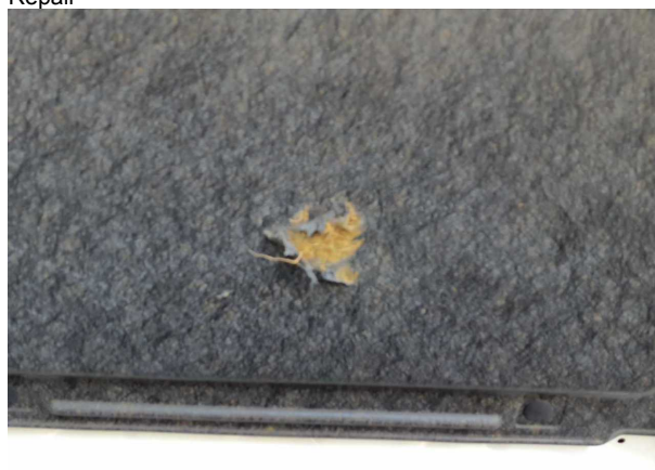
Beschädigung #2: Motorhaube: Dämmmatte - beschädigt - erneuern
