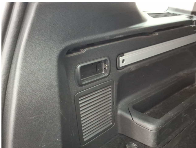
Damage 2: Misc.: Misc. (Laderaum Licht) - Missing - Replace
