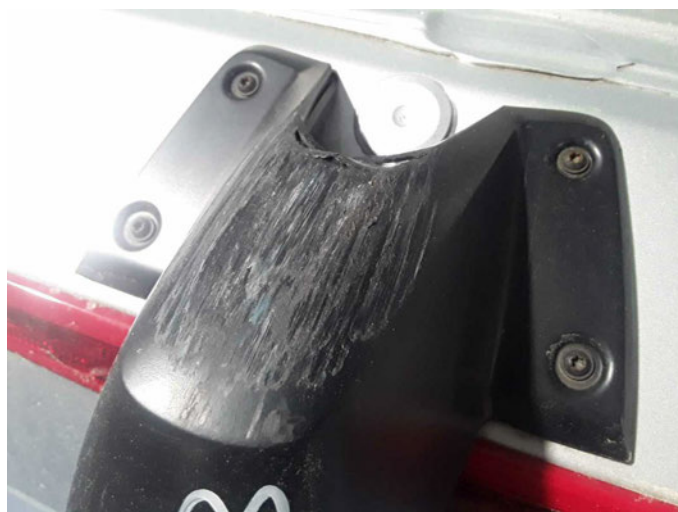
Beschädigung 2: elektronische Systeme: Rückfahrkamera - beschädigt - erneuern
