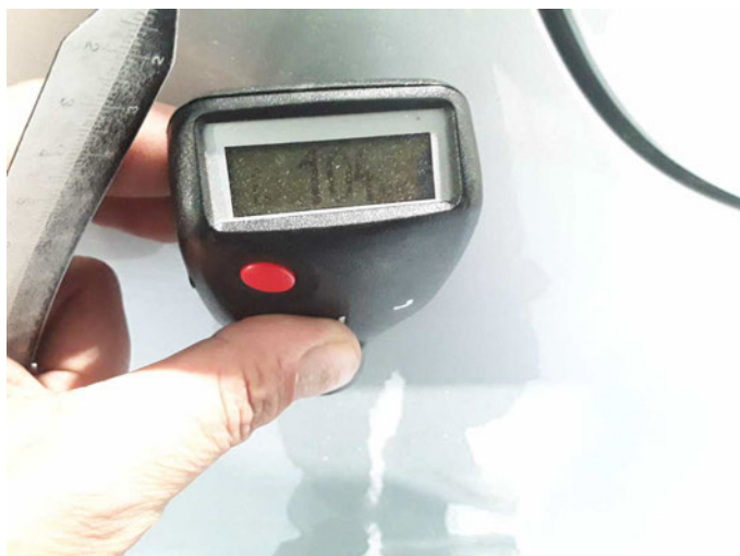
Kotflügel rechts: 104 \mu\text{m}
