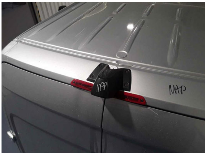
Beschädigung 2: elektronische Systeme: Rückfahrkamera - beschädigt - erneuern
