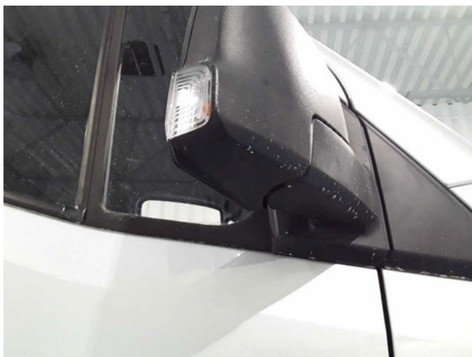
Beschädigung 27: Außenspiegel rechts: Abdeckkappe - beschädigt - erneuern
