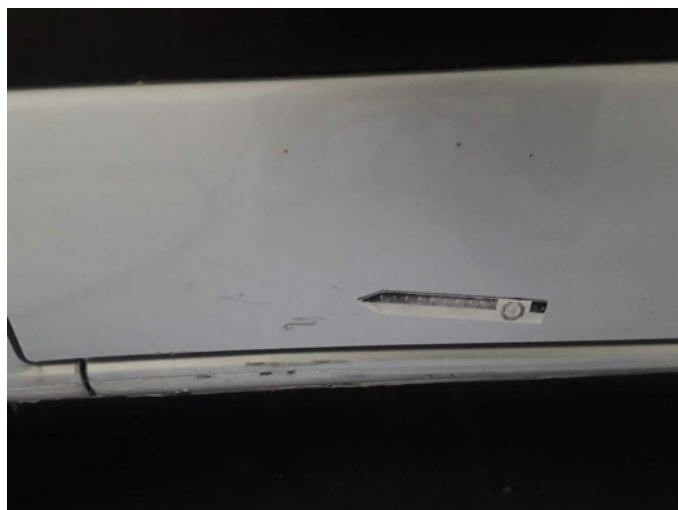
Beschädigung 6: Tür vorn links: Tür - Delle / Lackschaden - instandsetzen/lackieren (S3)
