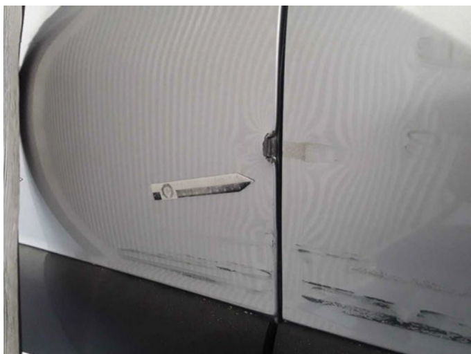
Beschädigung 19: Seitenwand rechts: Seitenwand - gebrochen / gerissen - erneuern
