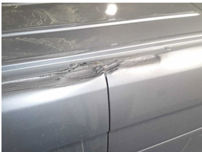
Beschädigung 37: Fahrzeugdach: Dachholm links - beschädigt - erneuern
