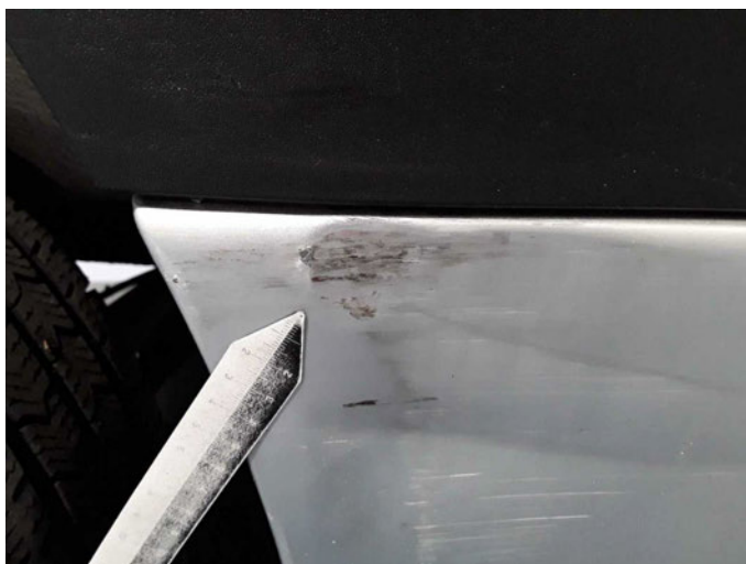
Beschädigung 23: Schweller rechts: Schweller - verformt - erneuern
