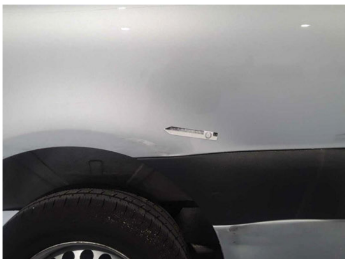
Beschädigung 19: Seitenwand rechts: Seitenwand - gebrochen / gerissen - erneuern
