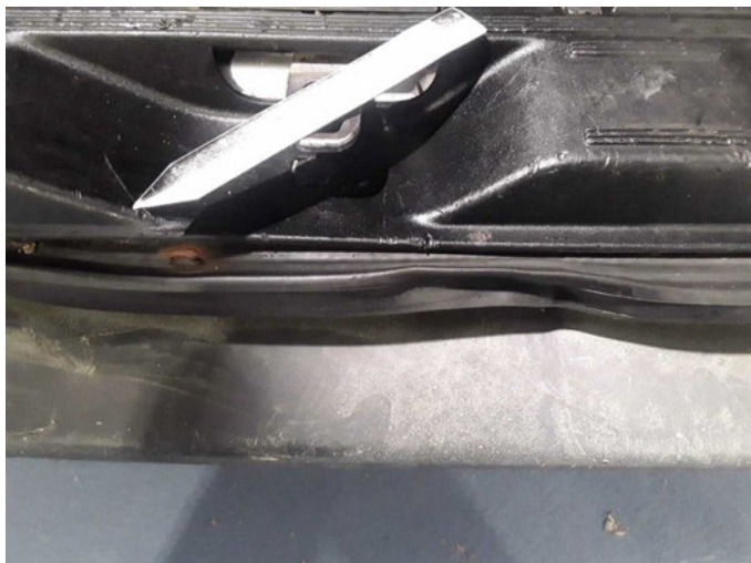
Beschädigung 14: Heckklappe/-tür: Dichtung - beschädigt - erneuern
