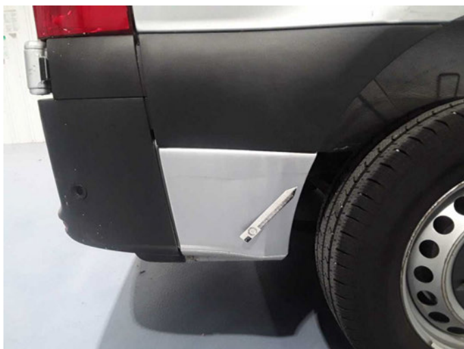
Beschädigung 20: Seitenwand rechts: Radlauf - Delle / Lackschaden - instandsetzen/lackieren (S3)
