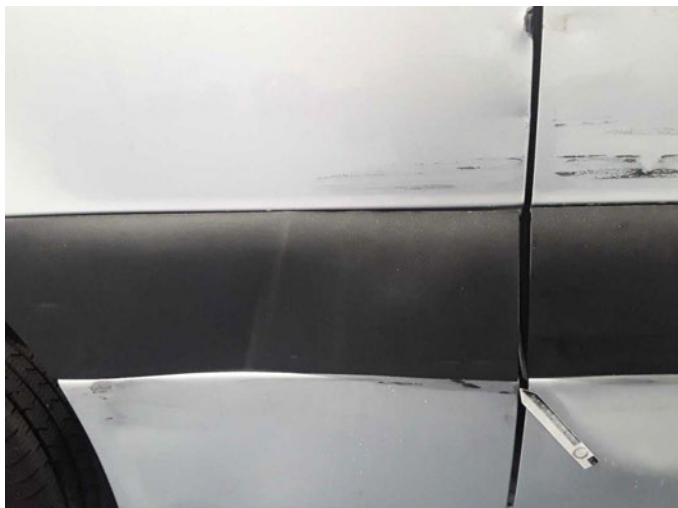
Beschädigung 22: Seitenwand rechts: Schutzleiste - verformt - erneuern
