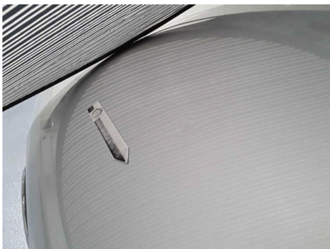
Beschädigung 31: Motorhaube: Motorhaube - Delle(n) - sanft instandsetzen
