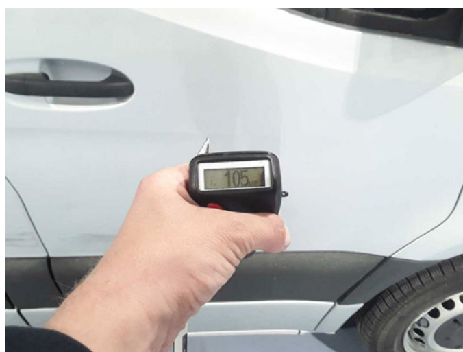
Tür vorne rechts: 105 \mu\text{m}
