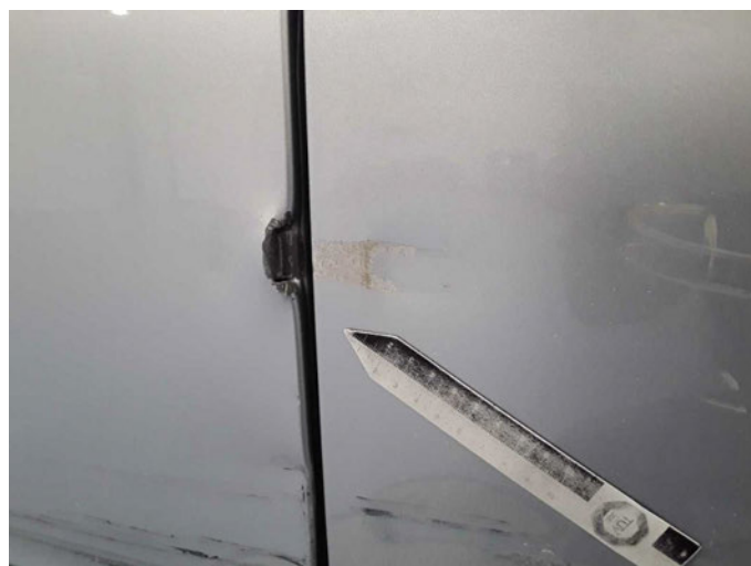
Beschädigung 24: Schiebetür rechts: Schiebetür - verformt - erneuern
