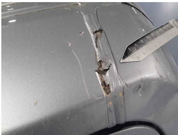
Beschädigung 1: Koffer: Dachabschlußprofil - beschädigt - instandsetzen/lackieren (S3)
