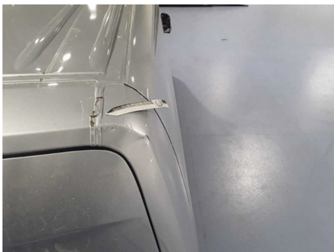
Beschädigung 4: Karosserie: C-Säule rechts - beschädigt - instandsetzen/lackieren (S3)
