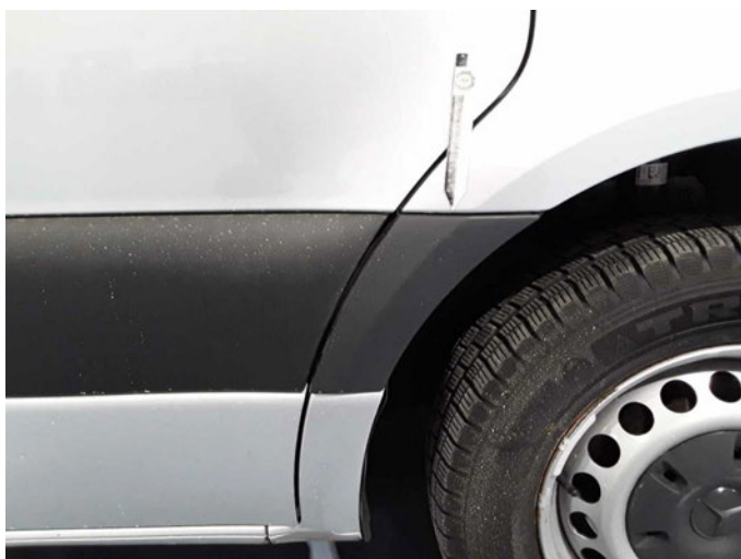
Beschädigung 28: Kotflügel rechts: Zierleiste, -gitter - beschädigt - erneuern
