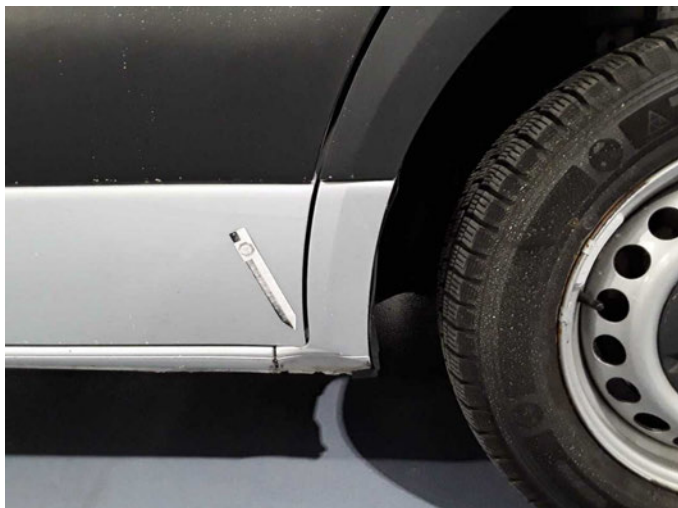
Beschädigung 26: Schweller rechts: Schweller vorn - verformt - erneuern
