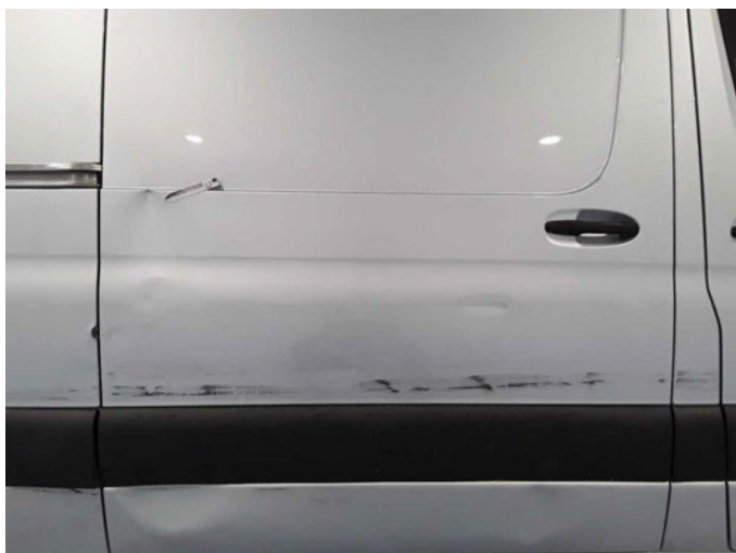
Beschädigung 24: Schiebetür rechts: Schiebetür - verformt - erneuern
