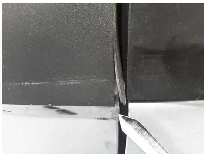
Beschädigung 22: Seitenwand rechts: Schutzleiste - verformt - erneuern
