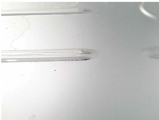
Beschädigung 35: Fahrzeugdach: Dach - verkratzt / verschürft - instandsetzen/lackieren (S3)
