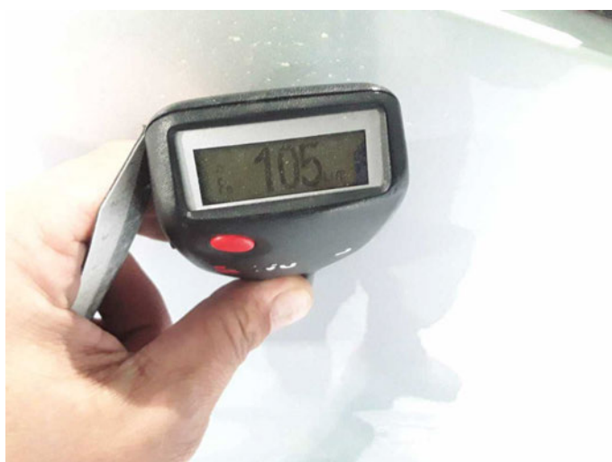
Tür vorne rechts: 105 \mu\text{m}
