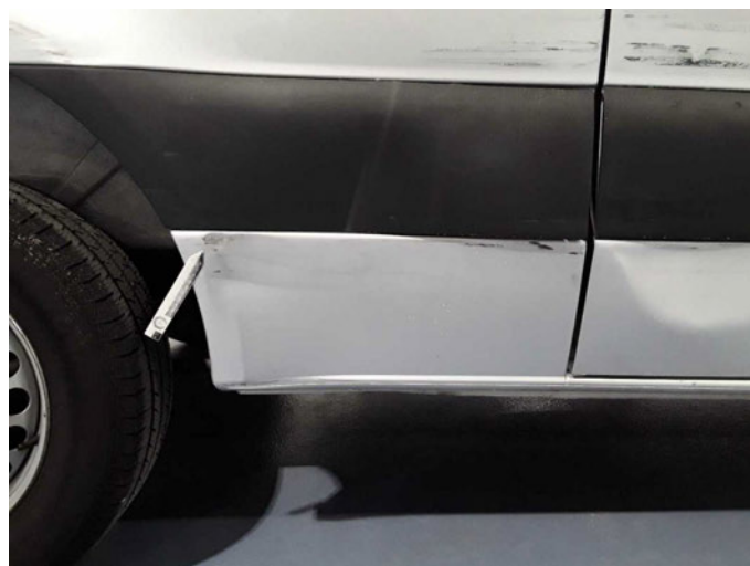
Beschädigung 23: Schweller rechts: Schweller - verformt - erneuern
