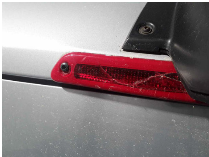
Beschädigung 3: Heckleuchte: Zusatzbremsleuchte - beschädigt - erneuern
