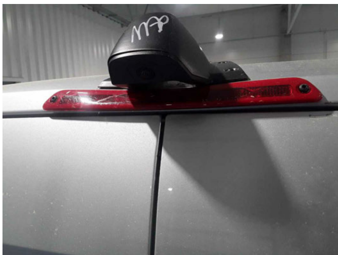
Beschädigung 3: Heckleuchte: Zusatzbremsleuchte - beschädigt - erneuern
