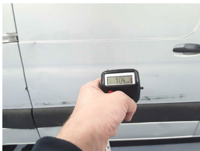
Tür hinten rechts: 104 \mu\text{m}
