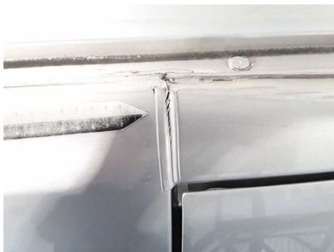
Beschädigung 34: Fahrzeugdach: Dachholm rechts - beschädigt - erneuern
