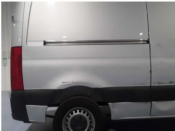
Beschädigung 19: Seitenwand rechts: Seitenwand - gebrochen / gerissen - erneuern
