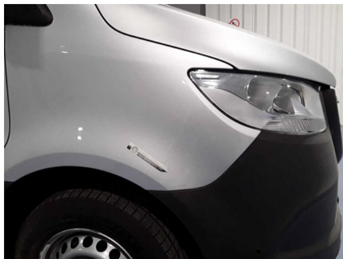
Beschädigung 30: Kotflügel rechts: Kotflügel rechts - beklebt/ beschriftet - entkleben/neutralisieren
