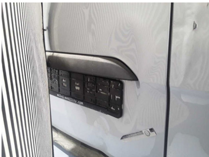
Beschädigung 12: Heckklappe/-tür: Hecktür links - verformt - erneuern
