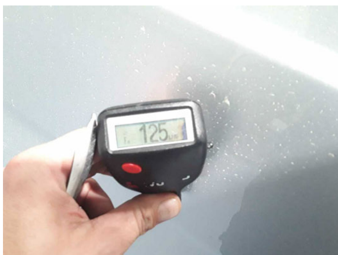
Seitenwand links: 125 \mu\text{m}
