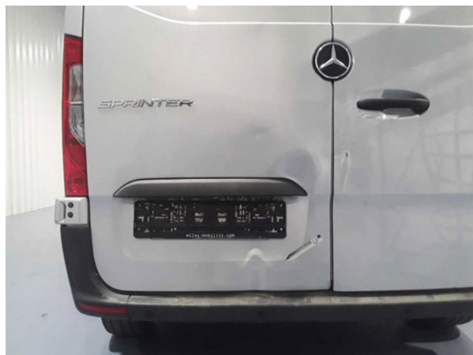
Beschädigung 12: Heckklappe/-tür: Hecktür links - verformt - erneuern
