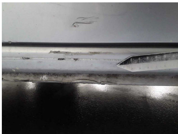
Beschädigung 7: Schweller links: Schweller - beschädigt - instandsetzen/lackieren (S3)
