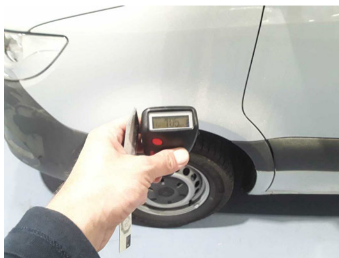
Kotflügel links: 105 \mu\text{m}
