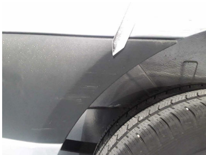
Beschädigung 21: Seitenwand rechts: Schutzleiste - beschädigt - erneuern
