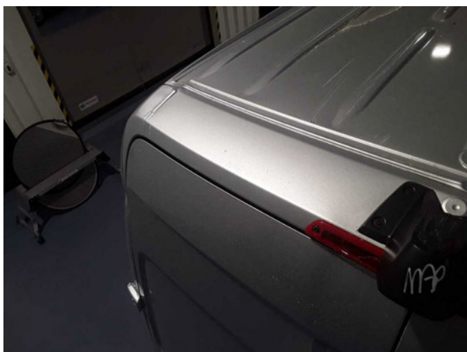
Beschädigung 1: Koffer: Dachabschlußprofil - beschädigt - instandsetzen/lackieren (S3)
