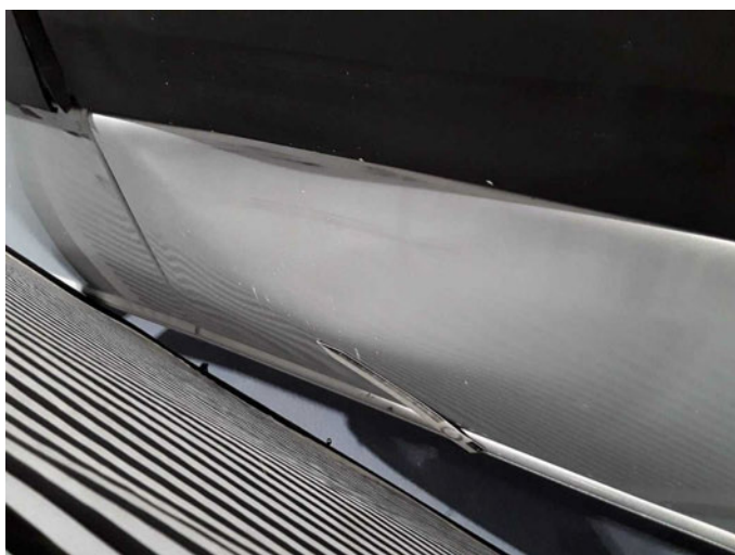
Beschädigung 24: Schiebetür rechts: Schiebetür - verformt - erneuern
