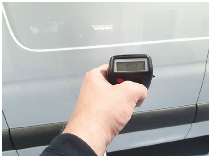
Seitenwand links: 125 \mu\text{m}
