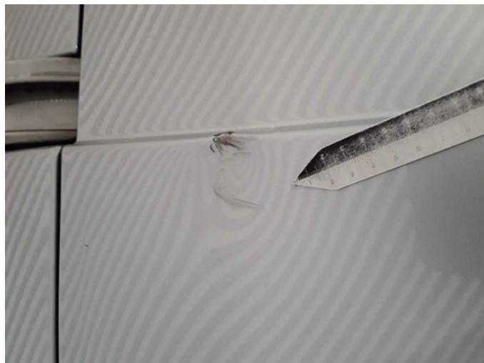
Beschädigung 24: Schiebetür rechts: Schiebetür - verformt - erneuern
