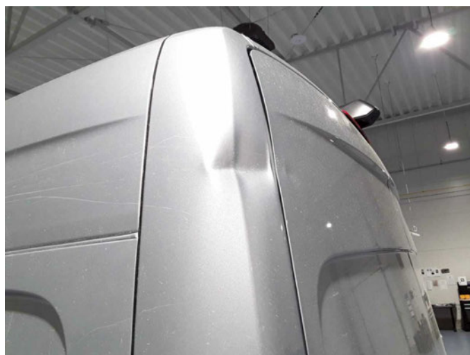
Beschädigung 36: Karosserie: C-Säule links - beschädigt - instandsetzen/lackieren (S3)
