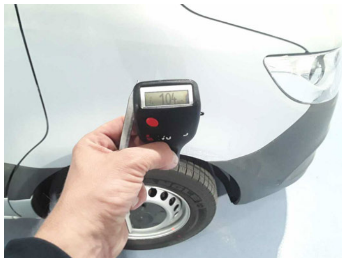
Kotflügel rechts: 104 \mu\text{m}
