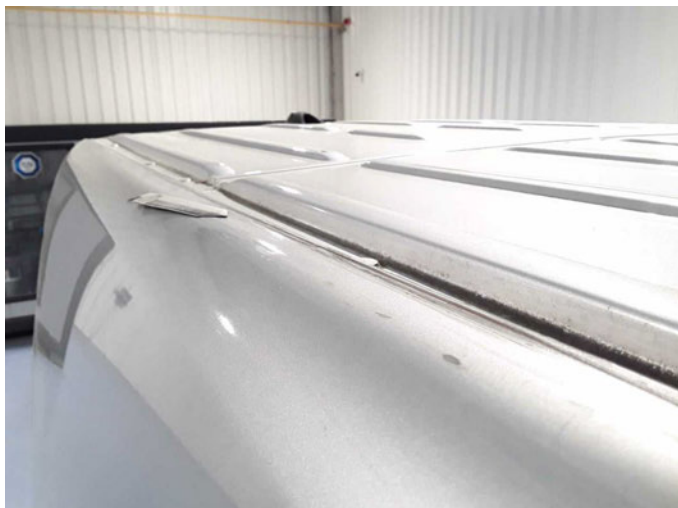
Beschädigung 34: Fahrzeugdach: Dachholm rechts - beschädigt - erneuern
