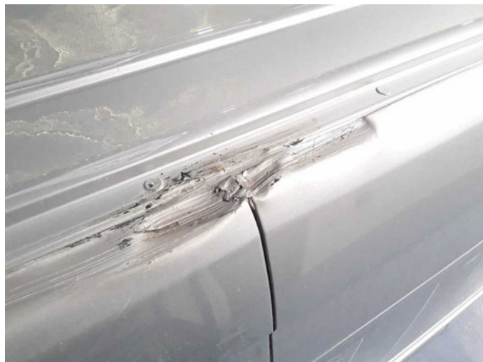
Beschädigung 37: Fahrzeugdach: Dachholm links - beschädigt - erneuern
