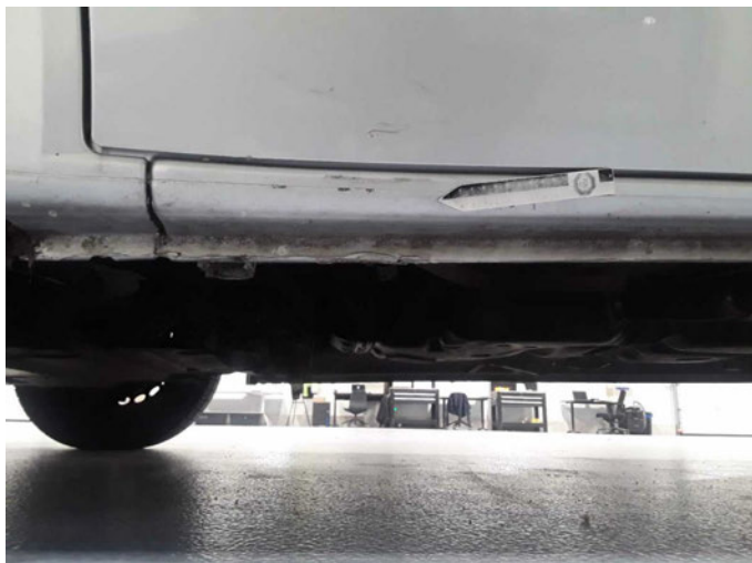
Beschädigung 7: Schweller links: Schweller - beschädigt - instandsetzen/lackieren (S3)
