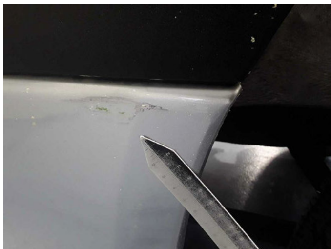
Beschädigung 8: Schweller links: Schweller - verkratzt / verschürft - lackieren
