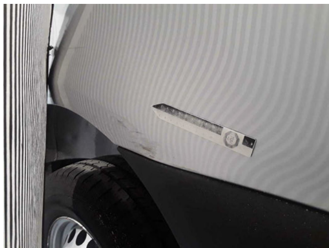
Beschädigung 19: Seitenwand rechts: Seitenwand - gebrochen / gerissen - erneuern
