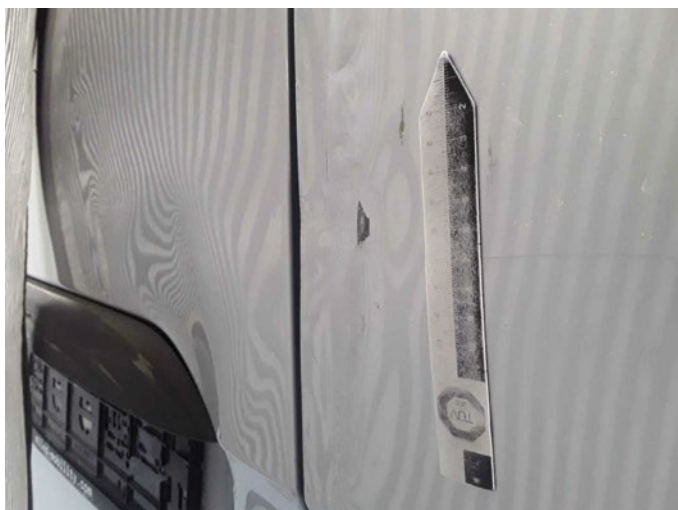
Beschädigung 13: Heckklappe/-tür: Hecktür rechts - beschädigt - erneuern
