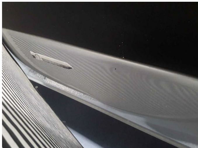
Beschädigung 7: Schweller links: Schweller - beschädigt - instandsetzen/lackieren (S3)
