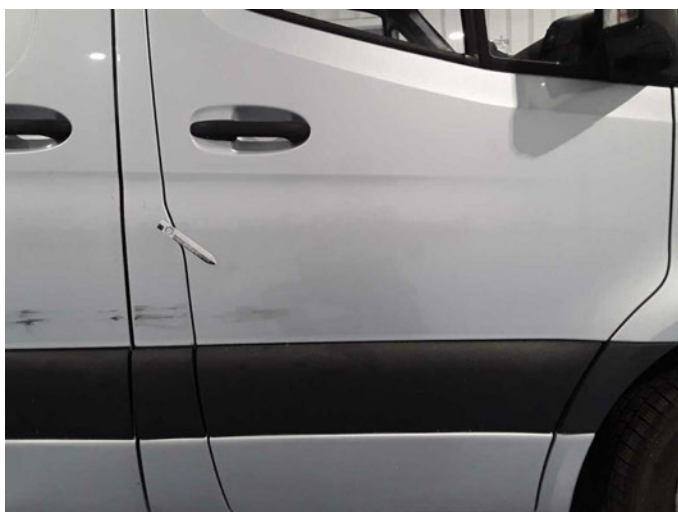
Beschädigung 25: Tür vorn rechts: Tür - Delle / Lackschaden - sanft instandsetzen
