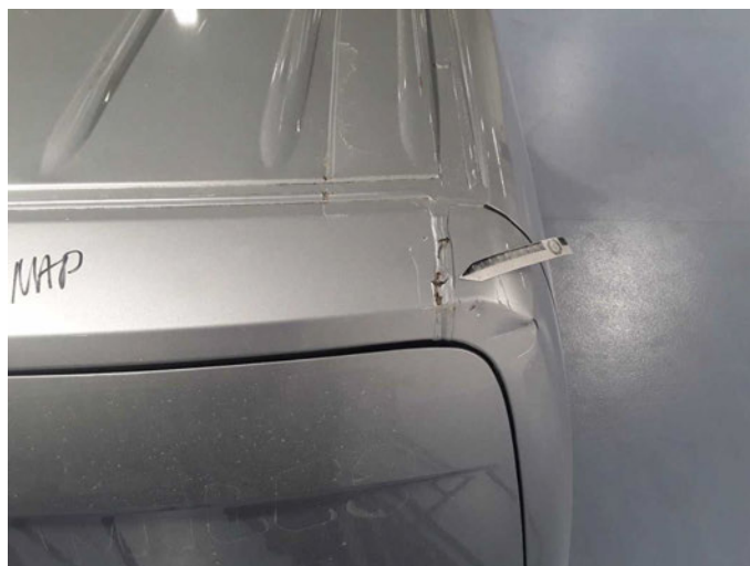
Beschädigung 1: Koffer: Dachabschlußprofil - beschädigt - instandsetzen/lackieren (S3)
