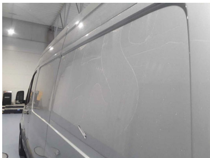
Beschädigung 9: Seitenwand links: Seitenwand - beklebt/ beschriftet - entkleben/neutralisieren
