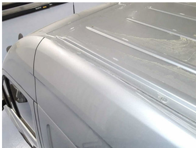
Beschädigung 37: Fahrzeugdach: Dachholm links - beschädigt - erneuern
