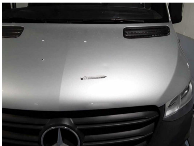
Beschädigung 31: Motorhaube: Motorhaube - Delle(n) - sanft instandsetzen
