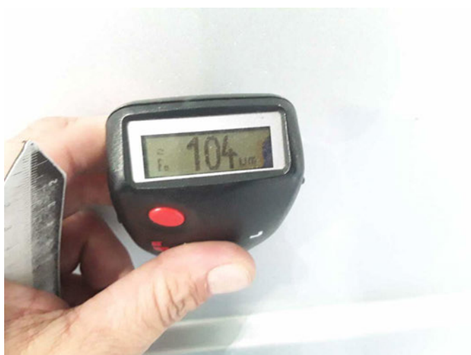
Tür hinten rechts: 104 \mu\text{m}
