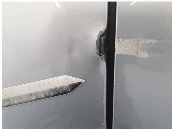
Beschädigung 19: Seitenwand rechts: Seitenwand - gebrochen / gerissen - erneuern
