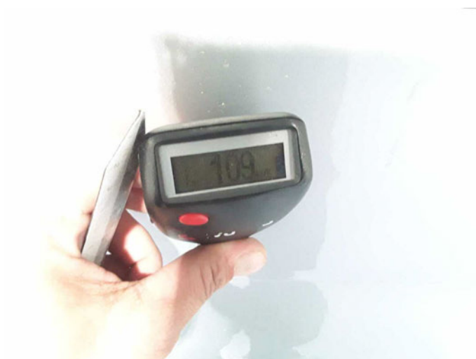
Seitenwand rechts: 109 \mu\text{m}
