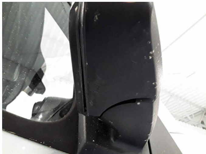
Beschädigung 27: Außenspiegel rechts: Abdeckkappe - beschädigt - erneuern
