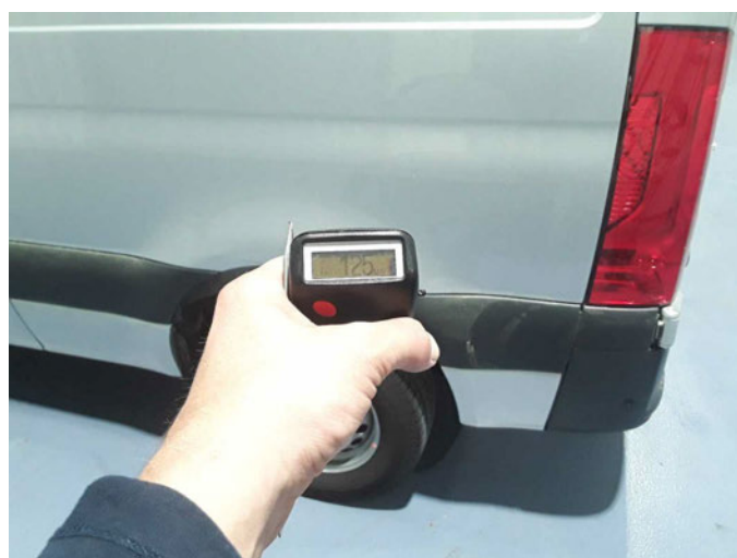
Seitenwand links: 125 \mu\text{m}
