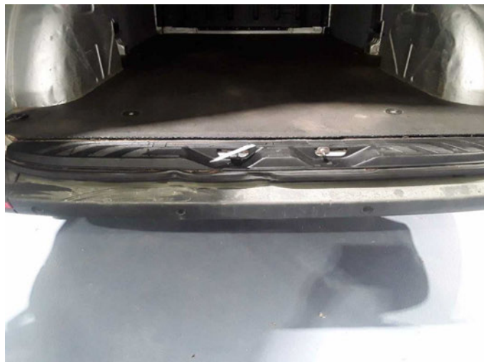
Beschädigung 14: Heckklappe/-tür: Dichtung - beschädigt - erneuern
