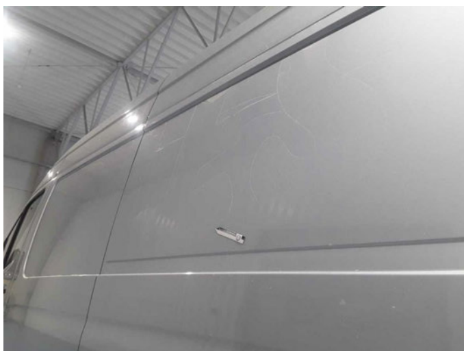
Beschädigung 9: Seitenwand links: Seitenwand - beklebt/ beschriftet - entkleben/neutralisieren
