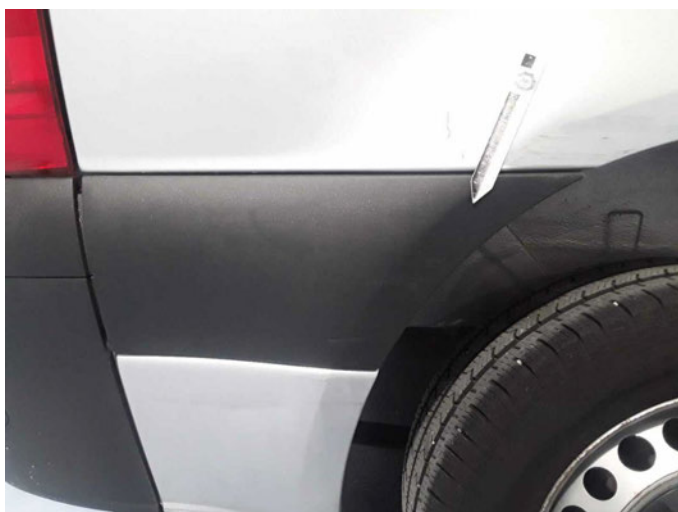
Beschädigung 21: Seitenwand rechts: Schutzleiste - beschädigt - erneuern
