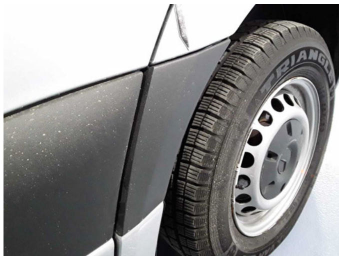
Beschädigung 28: Kotflügel rechts: Zierleiste, -gitter - beschädigt - erneuern
