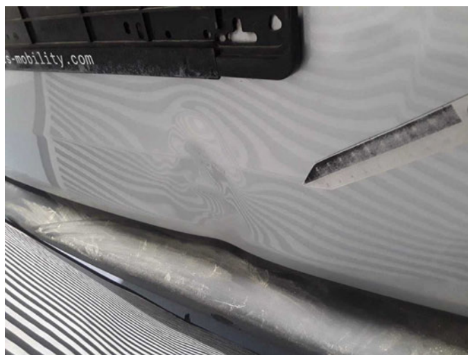
Beschädigung 12: Heckklappe/-tür: Hecktür links - verformt - erneuern
