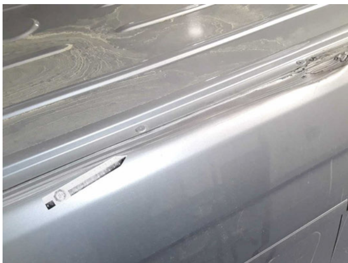
Beschädigung 37: Fahrzeugdach: Dachholm links - beschädigt - erneuern
