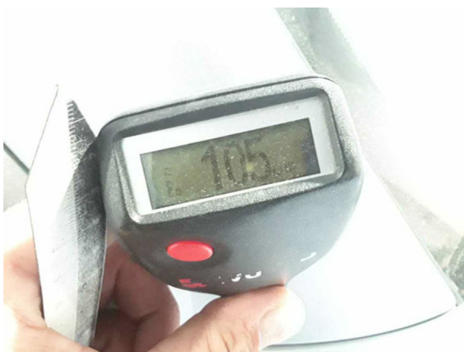
Dachholm rechts: 105 \mu\text{m}
