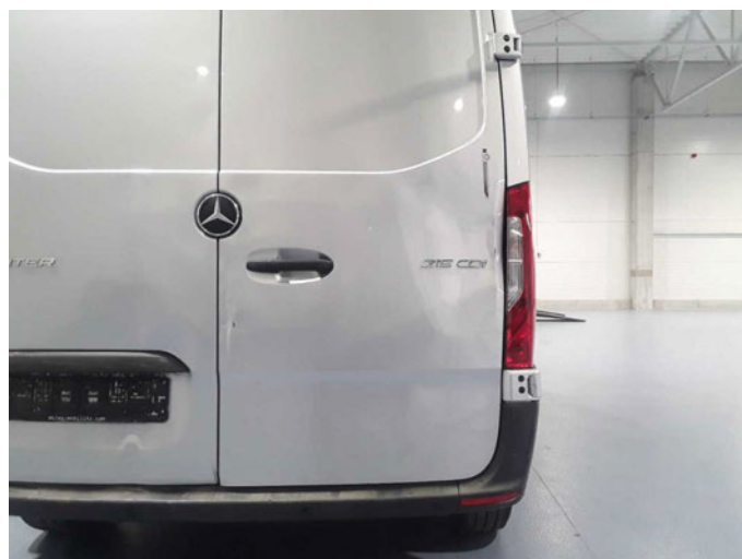
Beschädigung 13: Heckklappe/-tür: Hecktür rechts - beschädigt - erneuern
