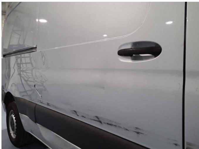
Beschädigung 24: Schiebetür rechts: Schiebetür - verformt - erneuern
