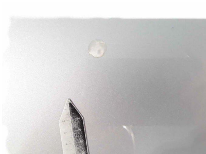
Beschädigung 32: Motorhaube: Motorhaube (Schadenserweiterung möglich) - Lackmangel - auslegen / polieren
