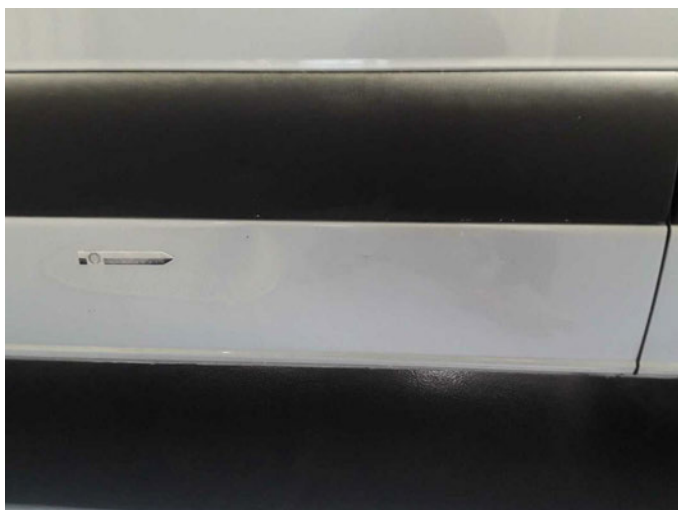
Beschädigung 7: Schweller links: Schweller - beschädigt - instandsetzen/lackieren (S3)
