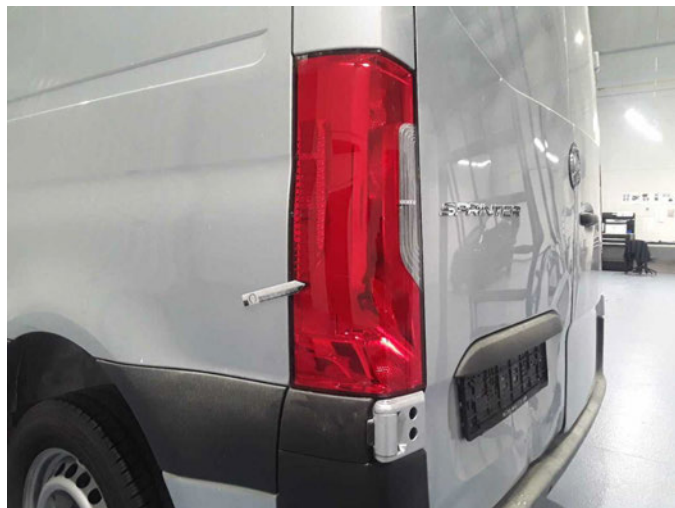
Beschädigung 10: Heckleuchte: Heckleuchte links - Kratzer - aufbereiten
