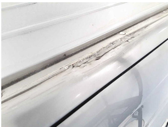
Beschädigung 34: Fahrzeugdach: Dachholm rechts - beschädigt - erneuern
