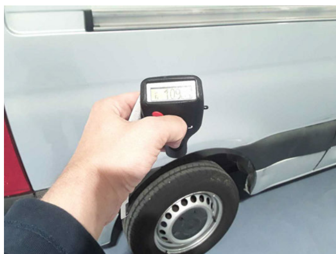
Seitenwand rechts: 109 \mu\text{m}
