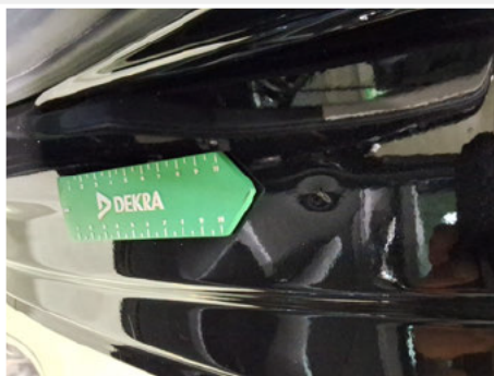
Entrée de porte / Intérieur Arrière Gauche / Rayure
