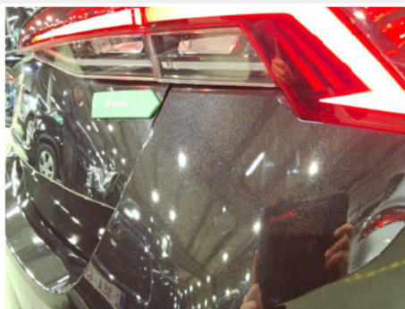
Pare-chocs / Arrière / Malfaçon
