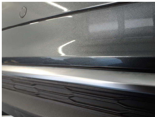
Beschädigung 4: Stossfänger hinten: Stossfänger hinten - Lackmangel - Smart Repair
