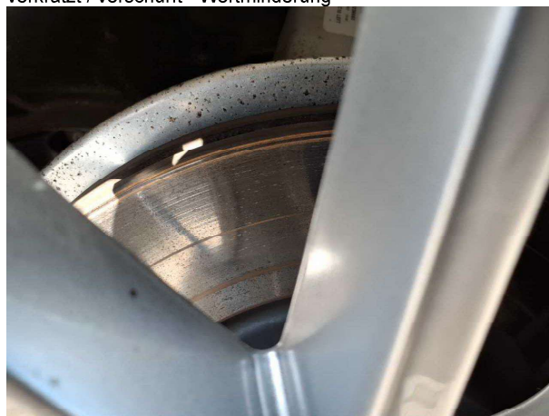
Beschädigung 6: Bremsanlage: Bremsscheiben und Beläge vorn (Ggf. Mehr kosten möglich) - verschlissen - erneuern
