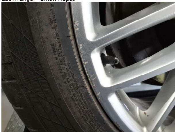
Beschädigung 5: Rad/Reifen: Leichtmetallfelge vorn links - verkratzt / verschürft - Wertminderung
