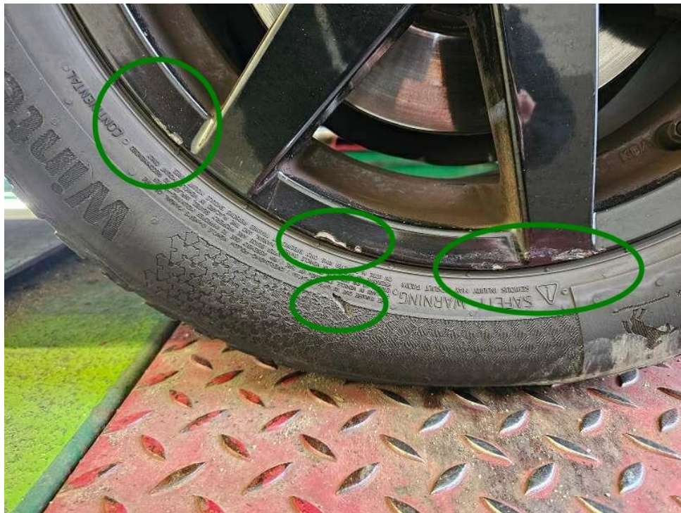
Bild 17 : Felgen vorne rechts Winterradsatz Kratzer Reifen vorne rechts Winterradsatz Flanke eingeschnitten
