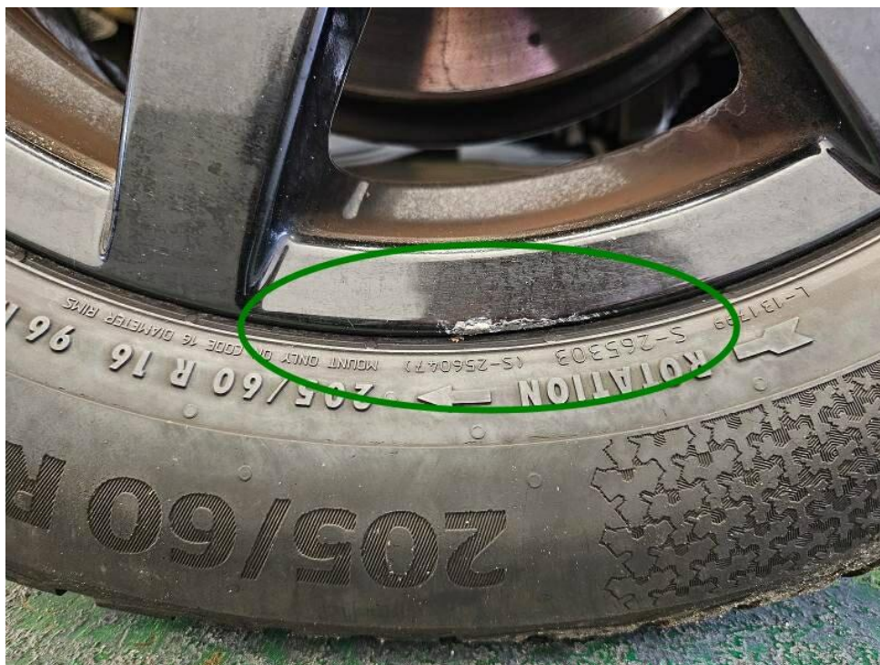
Bild 18 : Felge hinten rechts Winterradsatz Kratzer
