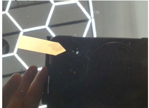
Beschädigung #5: Motorhaube: Motorhaube - Steinschlag - auslegen / polieren
