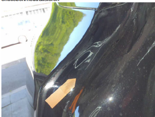
Beschädigung #2: Seitenwand rechts: Seitenwand (Rest finish) - nicht fachgerecht instandgesetzt - auslegen / polieren
