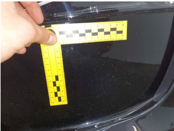
Beschädigung #11: Stossfänger vorn: Stossfänger vorn - Steinschlag... instandsetzen und lackieren
