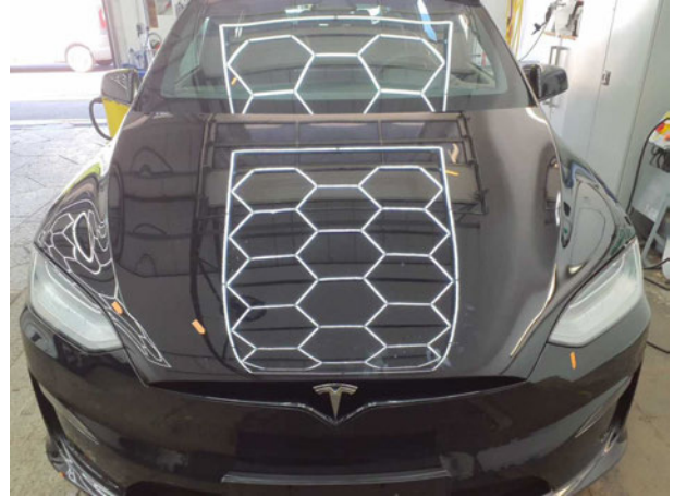
Beschädigung #5: Motorhaube: Motorhaube - Steinschlag - auslegen / polieren
