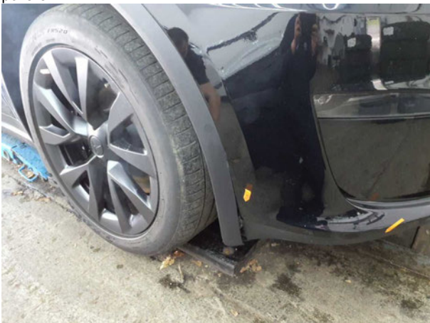
Beschädigung #7: Kotflügel rechts: Radhausverbreiterung - beschädigt - erneuern
