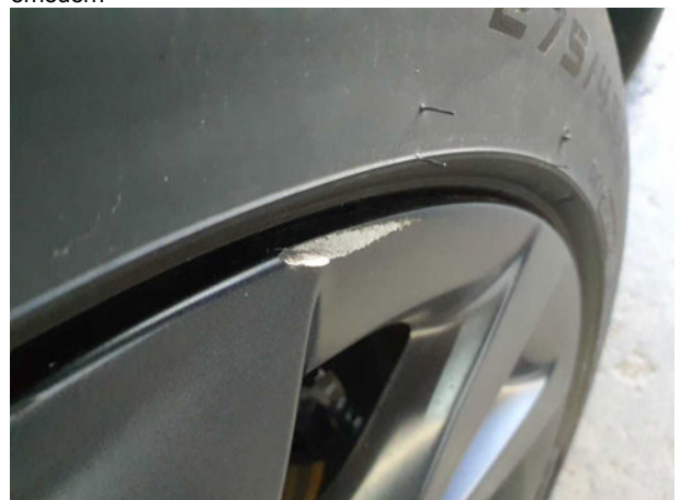
Beschädigung #13: Rad/Reifen: Leichtmetallfelge hinten links - beschädigt - erneuern
