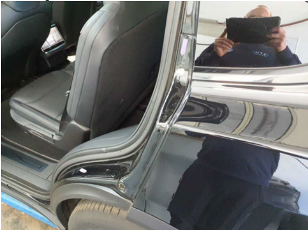
Beschädigung #14: Seitenwand links: Einstieg - Kratzer - instandsetzen und lackieren
