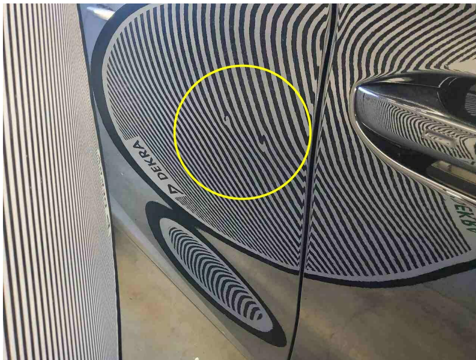
Bild 17 : Türe hinten rechts, eingedellt
