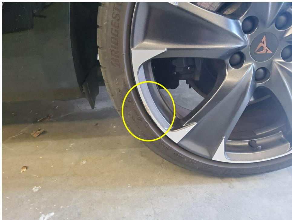
Bild 13 : Alufelge hinten links, zerkratzt
