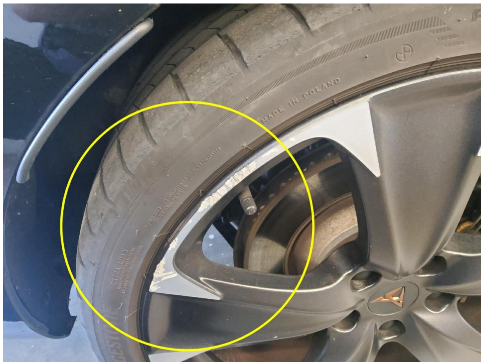
Bild 16 : Alufelge hinten rechts, zerkratzt
