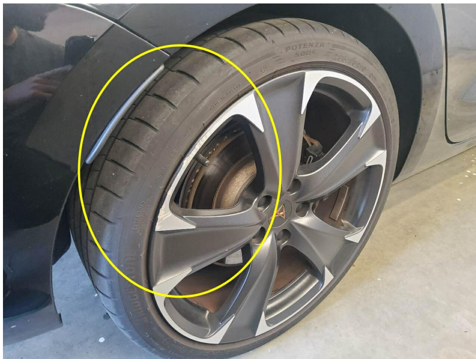
Bild 15 : Alufelge hinten rechts, zerkratzt
