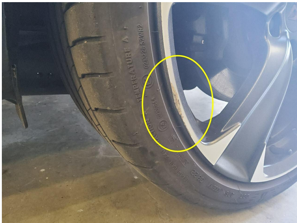
Bild 14 : Alufelge hinten links, zerkratzt
