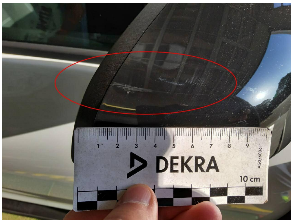
Bild 18 : Aussenspiegelkappe rechts zerkratzt
