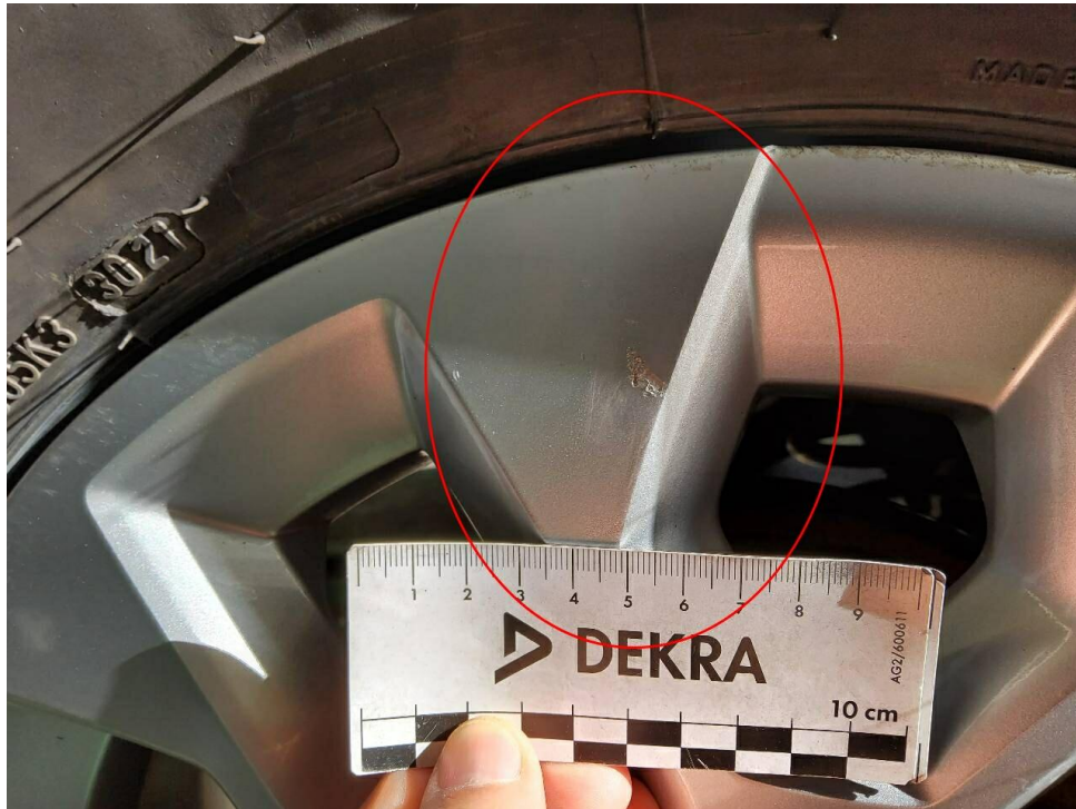
Bild 19 : Felge hinten rechts zerkratzt
