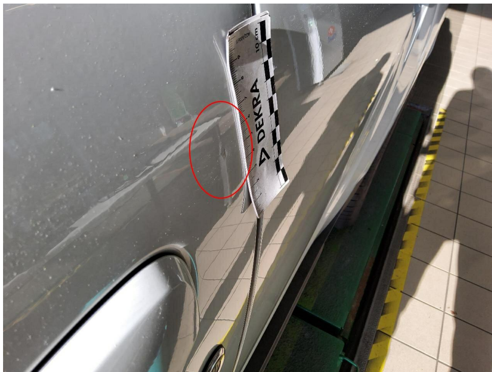
Bild 17 : Tür vorne links eingedellt
