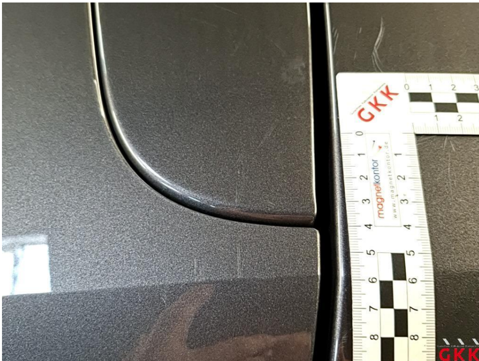
Bild 34 Heckklappe, verkratzt, lackieren
