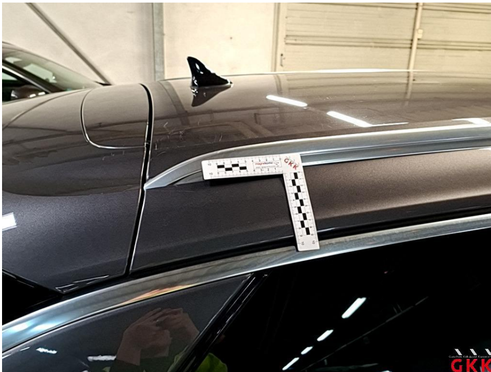
Bild 30 Dach, Reling rechts, verkratzt, ersetzen
