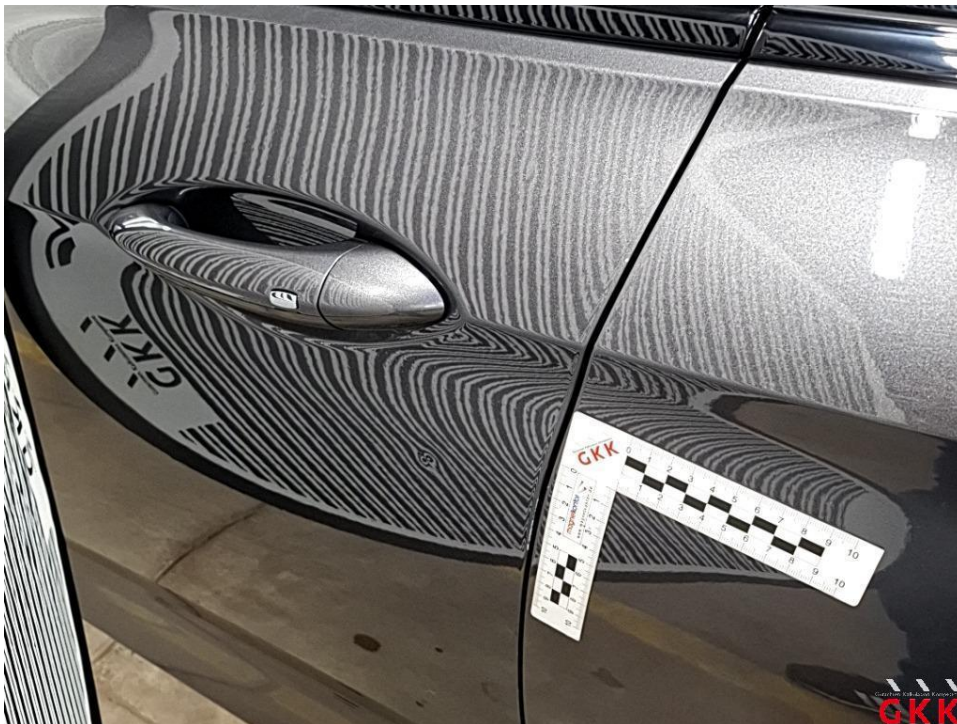
Bild 20 Tür vorne links, eingedellt und verkratzt (I), Smartrepair
