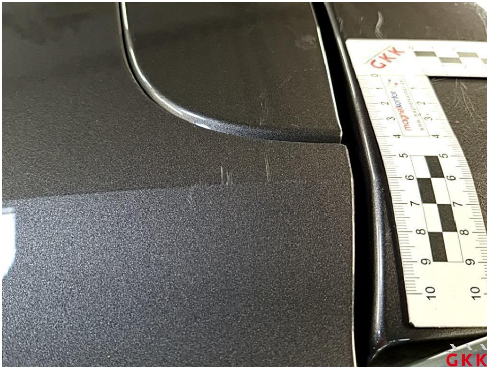
Bild 33 Heckklappe, verkratzt, lackieren
