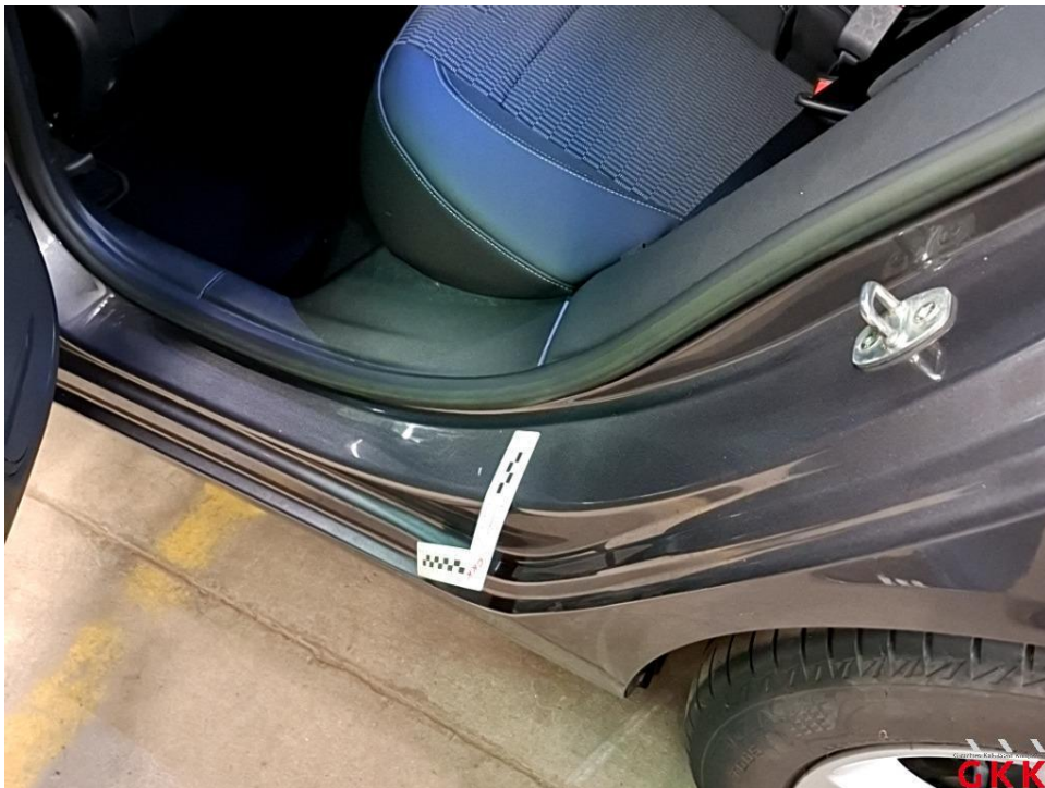
Bild 28 Tür hinten links, Einstieg, verkratzt, Smartrepair
