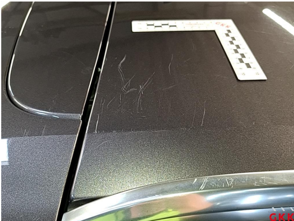
Bild 36 Dach, verkratzt, lackieren
