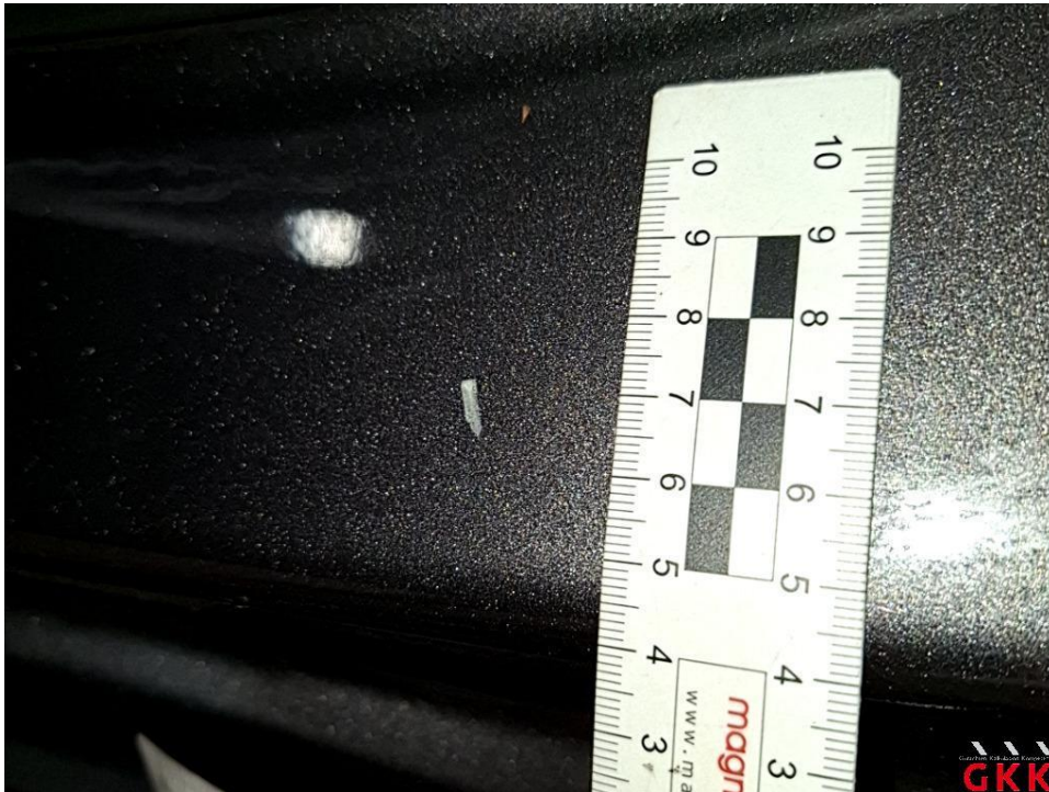
Bild 29 Tür hinten links, Einstieg, verkratzt, Smartrepair
