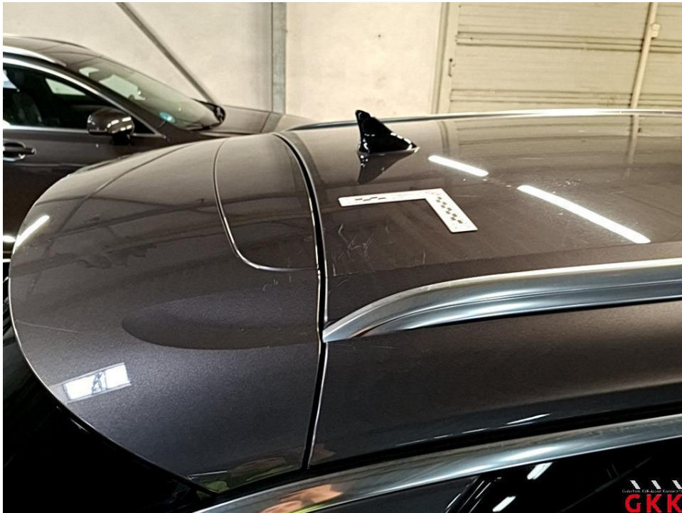
Bild 35 Dach, verkratzt, lackieren
