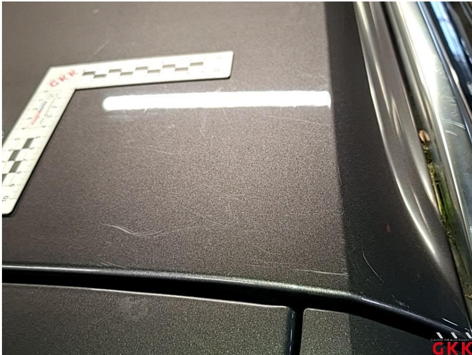
Bild 37 Dach, verkratzt, lackieren
