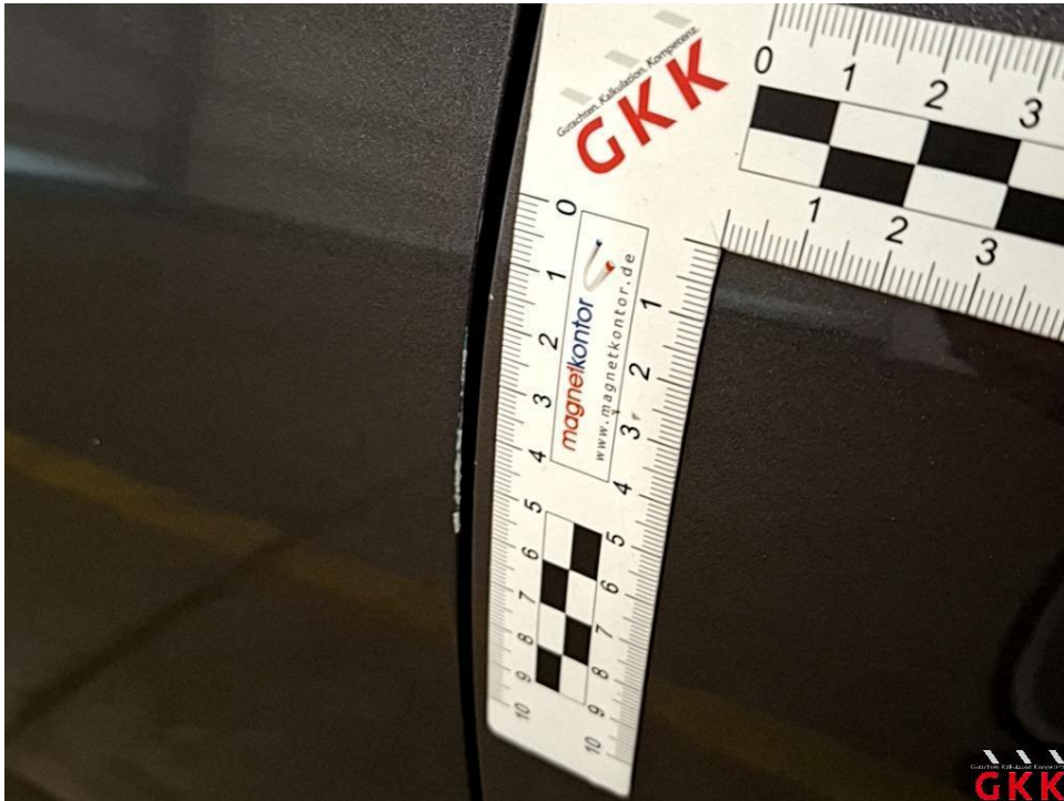
Bild 21 Tür vorne links, eingedellt und verkratzt (I), Smartrepair
