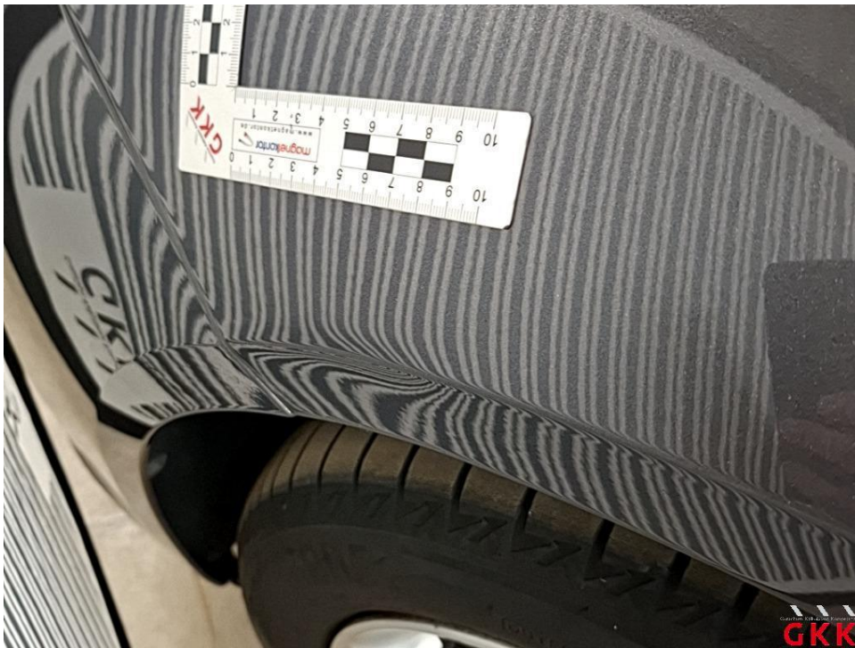
Bild 18 Kotflügel vorne links, beschädigt, ersetzen
