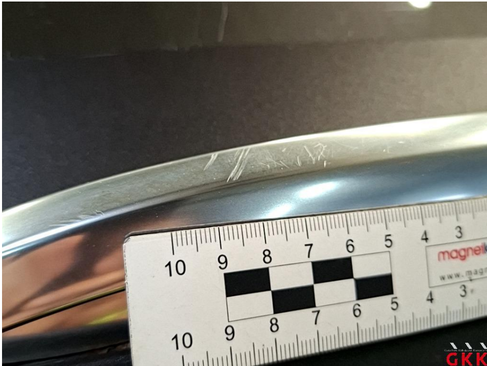
Bild 31 Dach, Reling rechts, verkratzt, ersetzen
