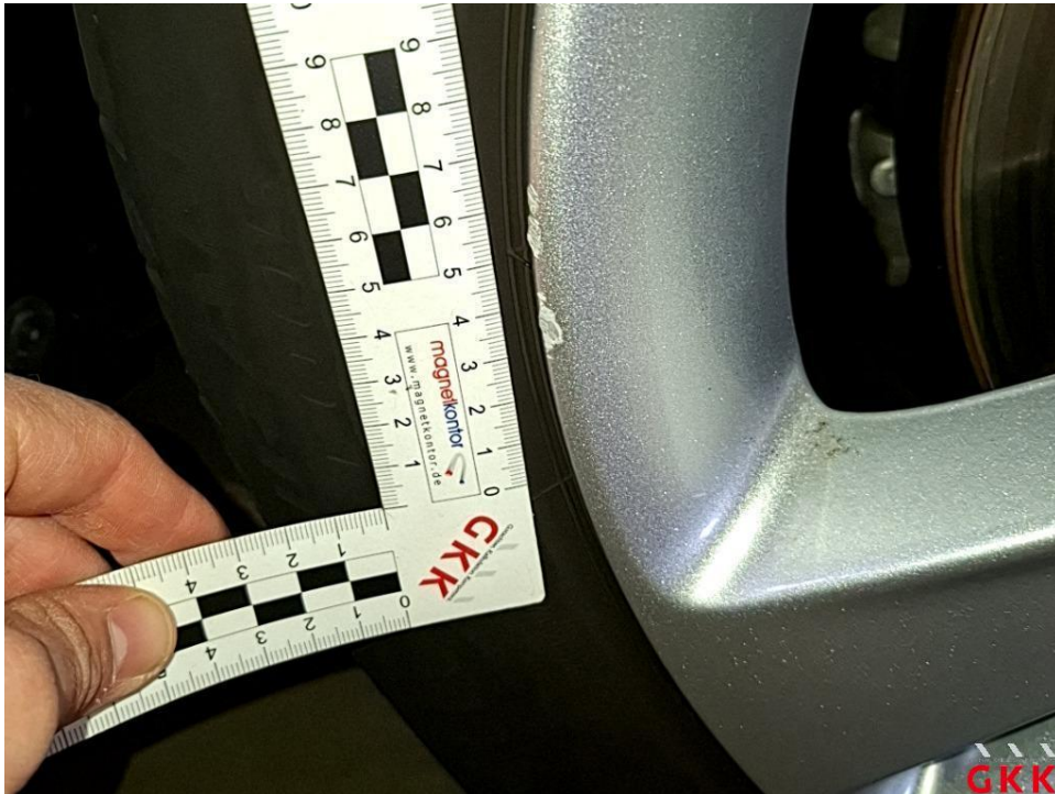
Bild 27 LM-Rad, vorne rechts, verkratzt, aufbereiten
