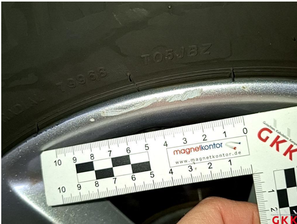
Bild 26 LM-Rad, vorne rechts, verkratzt, aufbereiten
