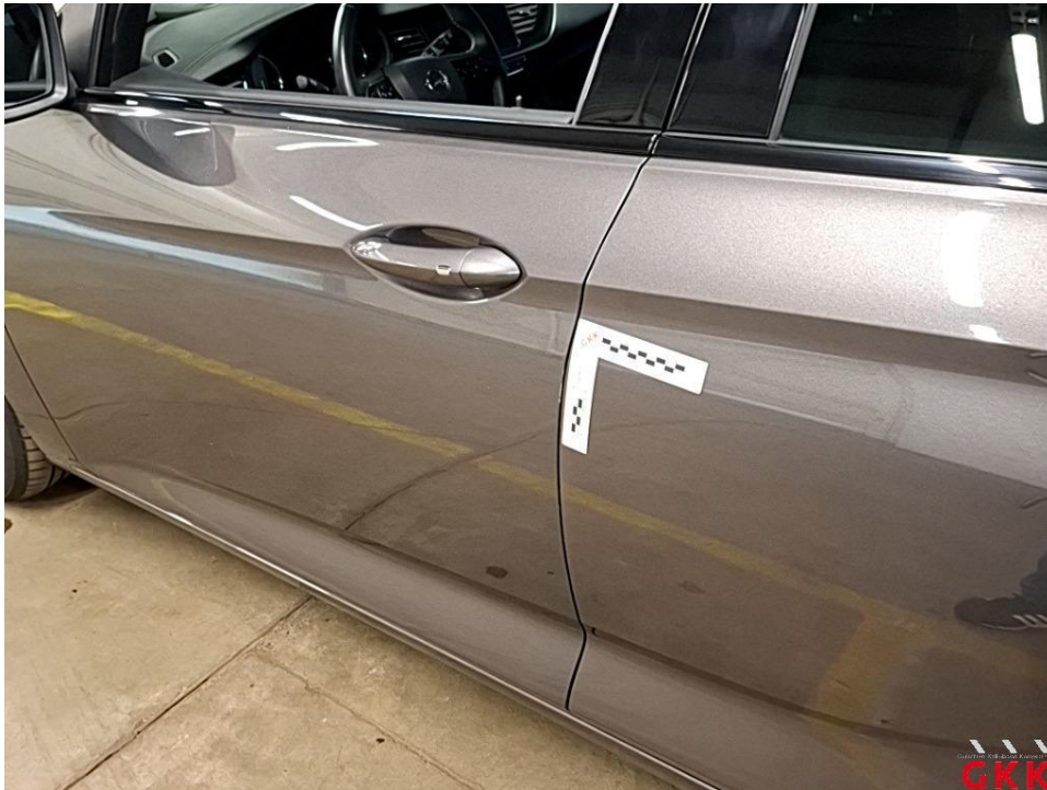
Bild 19 Tür vorne links, eingedellt und verkratzt (I), Smartrepair
