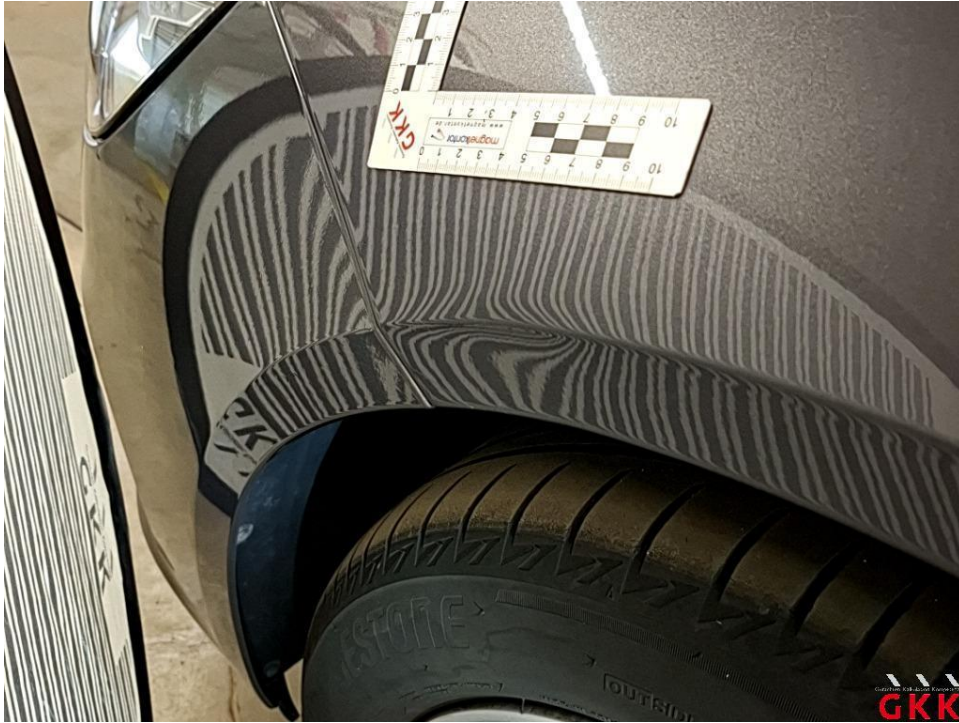
Bild 17 Kotflügel vorne links, beschädigt, ersetzen
