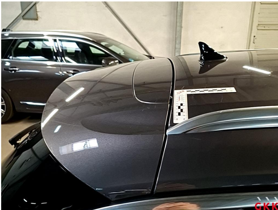
Bild 32 Heckklappe, verkratzt, lackieren
